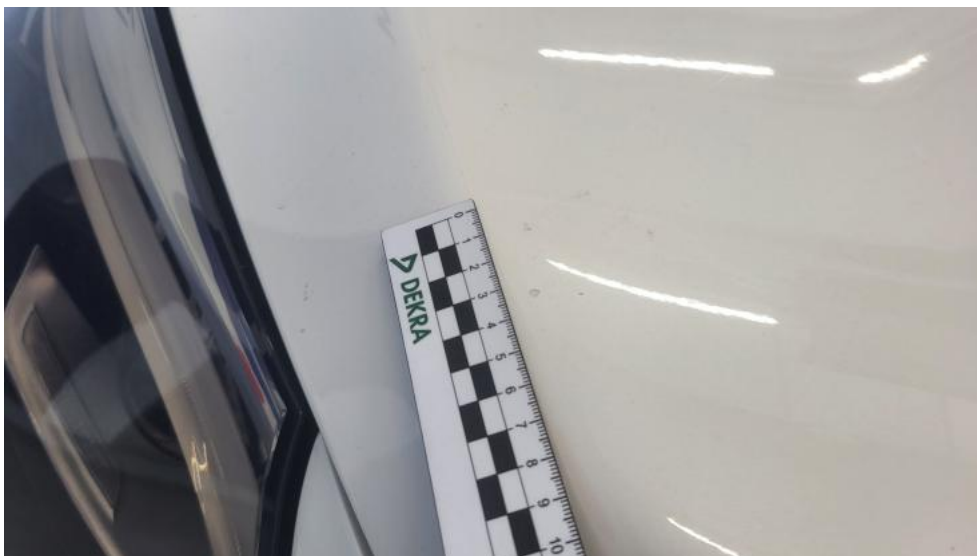
Fot. 42. Pokrywa komory silnika - Rysa/odprysk 1
