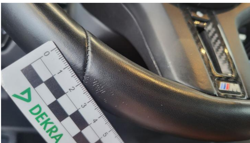
Fot. 58. Koło kierownicy - Rysa/odprysk 1
