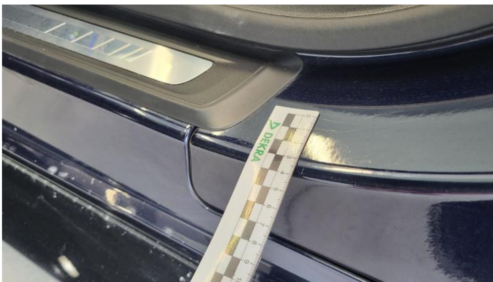
Fot. 57. Próg L - Rysa/odprysk 1
