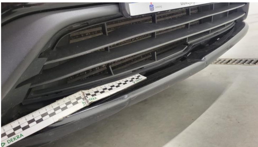
Fot. 38. Kratka zderzaka prz. - Pęknięcie/rozerwanie 1
