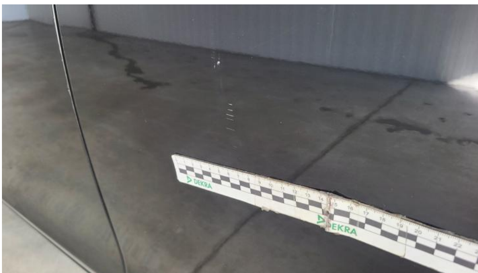
Fot. 62. Drzwi tylne L - Rysa/odprysk 1
