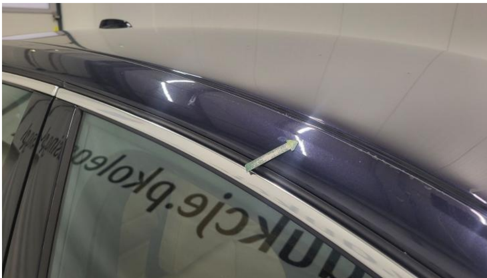
Photo 55. Stupek przedni P - Wgniecenie/odkształcenie 1
