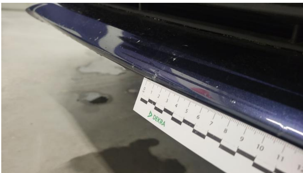
Photo 48. Zderzak przedni cz dolna - Wgniecenie/odkształcenie 2
