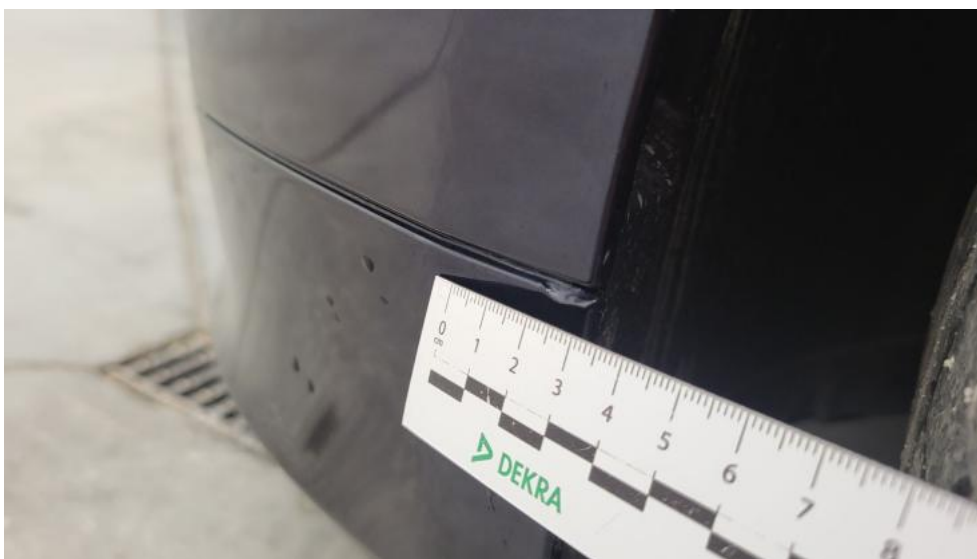
Photo 47. Zderzak przedni cz dolna - Wgniecenie/odkształcenie 1
