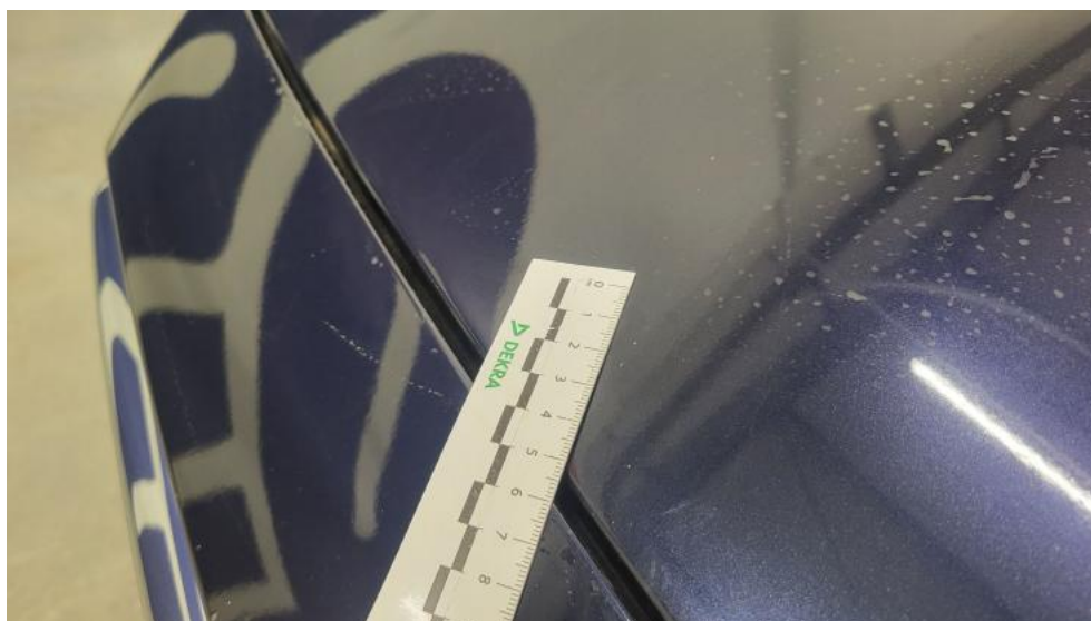
Photo 42. Pokrywa komory silnika - Rysa/odprysk 1
