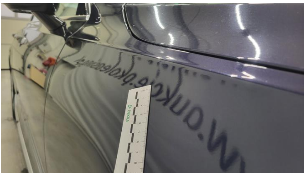
Photo 50. Błotnik przedni P - Wgniecenie/odkształcenie 1
