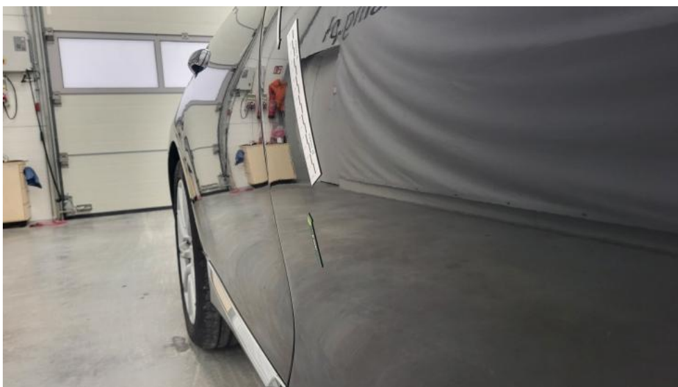
Photo 52. Drzwi przednie P - Wgniecenie/odkształcenie 1
