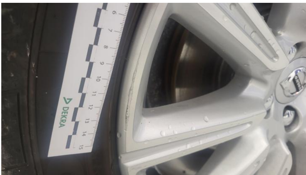
Photo 51. Felga aluminiowa przednia P - Rysa/odprysk 1
