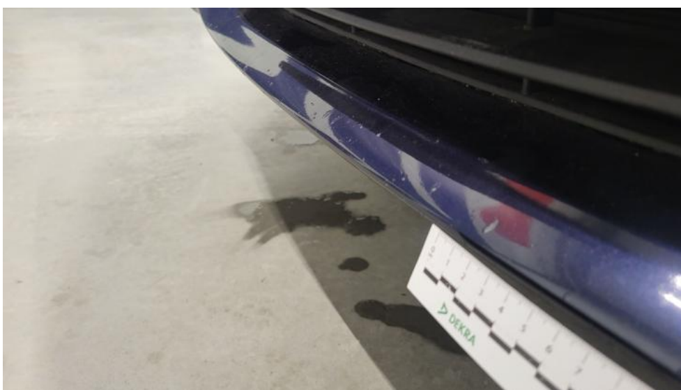
Photo 46. Zderzak przedni cz dolna - Rysa/odprysk 1
