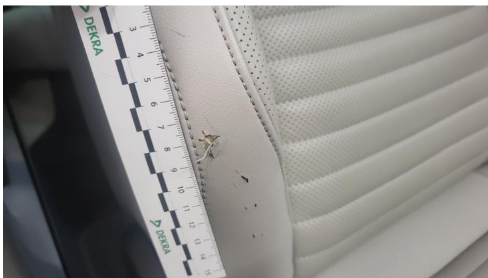
Fot. 72. Fotel prz. praw. - Pęknięcie/rozerwanie 1
