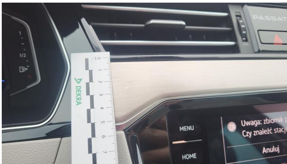
Fot. 71. Deska rozdzielcza - Rysa/odprysk 1
