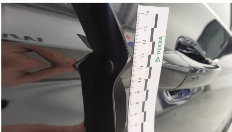
Fot. 48. Drzwi przednie P - Rysa/odprysk 1
