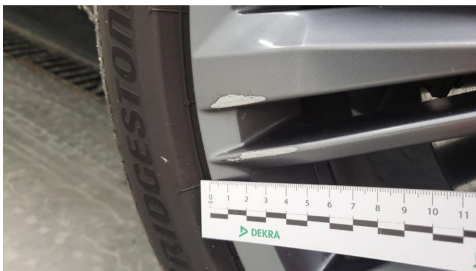
Fot. 66. Felga aluminiowa tylna L - Rysa/odprysk 2
