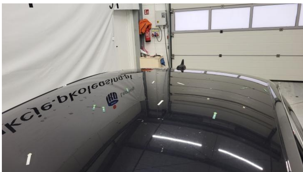
Fot. 60. Dach - Wgniecenie/odkształcenie 1
