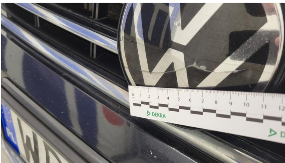
Fot. 39. Emblemat - Pęknięcie/rozerwanie 1
