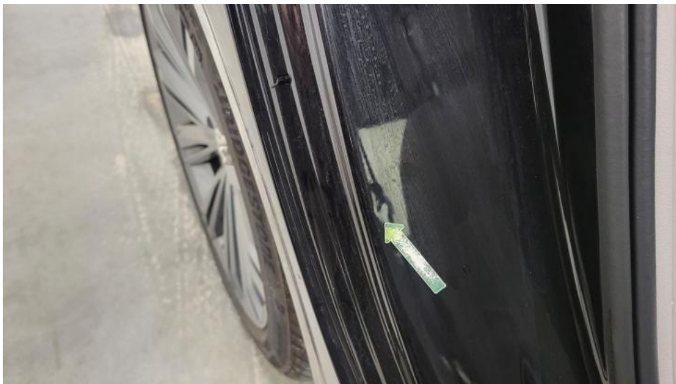
Fot. 53. Błotnik tylny P / Ściana boczna P - Wgniecenie/odkształcenie 1
