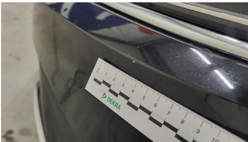
Fot. 46. Zderzak - Rysa/odprysk 1
