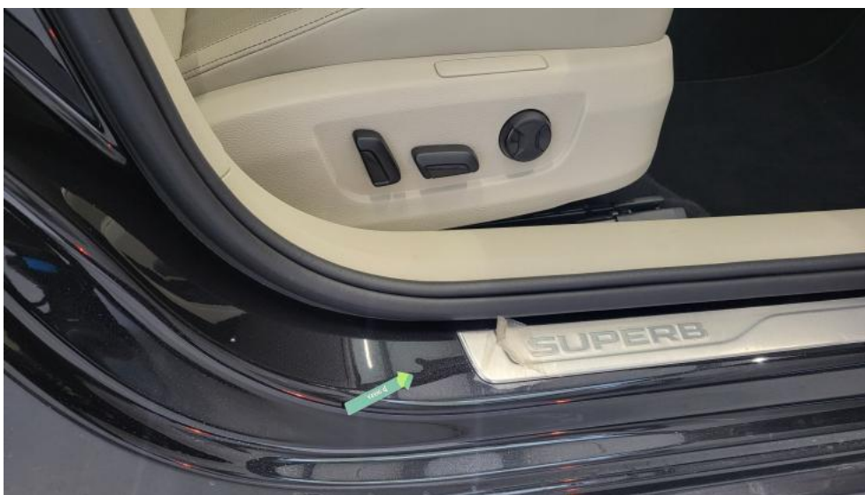
Photo 49. Próg P - Wgniecenie/odkształcenie 1
