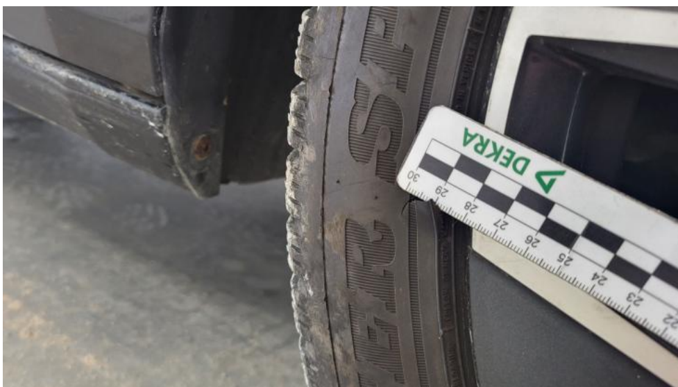
Photo 46. Opona przednia P - Pęknięcie/rozerwanie 1
