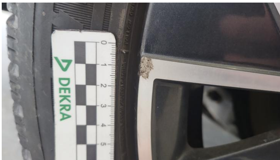
Photo 51. Felga aluminiowa tylna P - Rysa/odprysk 1
