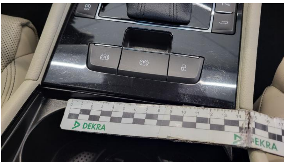
Photo 58. Konsola tunelu śr. - Rysa/odprysk 1
