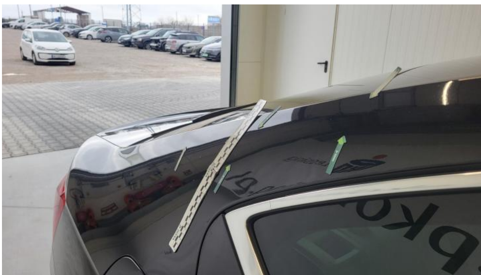
Photo 50. Błotnik tylny P / Ściana boczna P - Wgniecenie/odkształcenie 1
