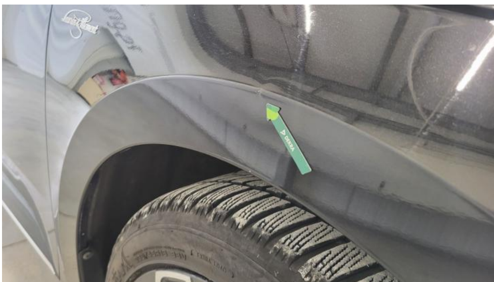
Photo 44. Błotnik przedni P - Wgniecenie/odkształcenie 1
