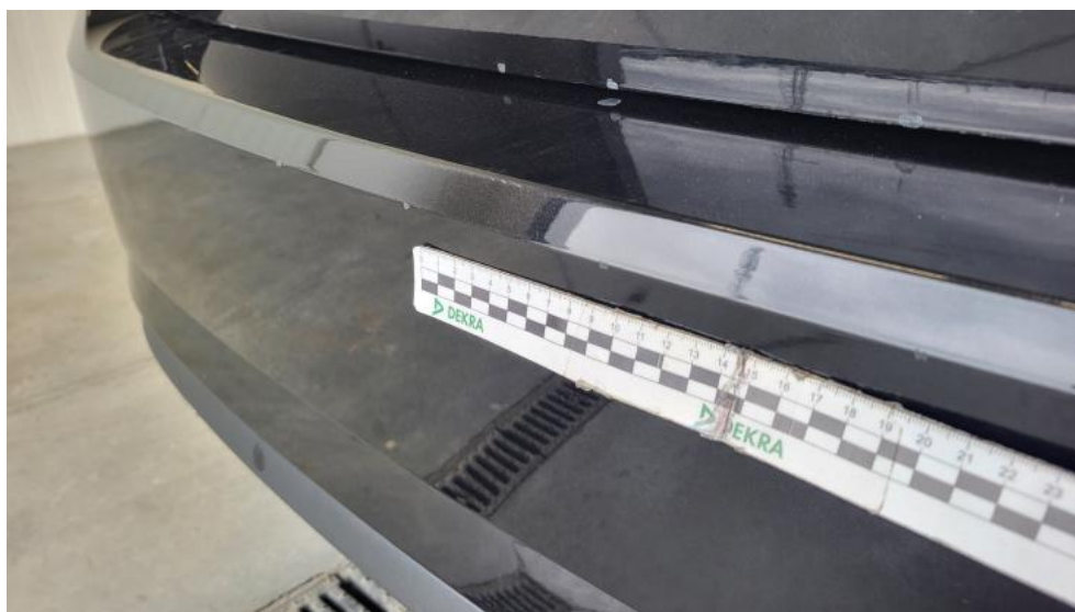
Photo 54. Zderzak tylny - Rysa/odprysk 1
