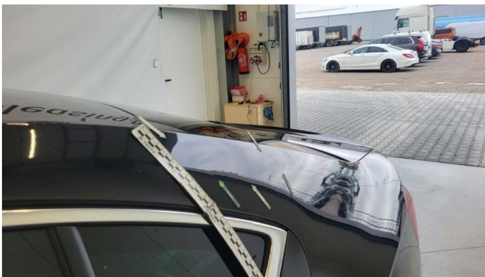
Photo 56. Błotnik tylny L / Ściana boczna L - Wgniecenie/odkształcenie 1
