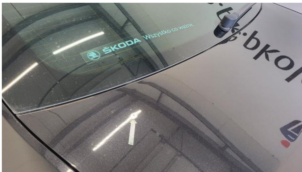
Photo 53. Pokrywy bagażnika - Wgniecenie/odkształcenie 2
