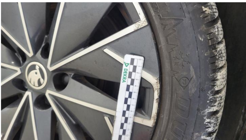
Photo 57. Felga Aluminiowa przednia L - Rysa/odprysk 1
