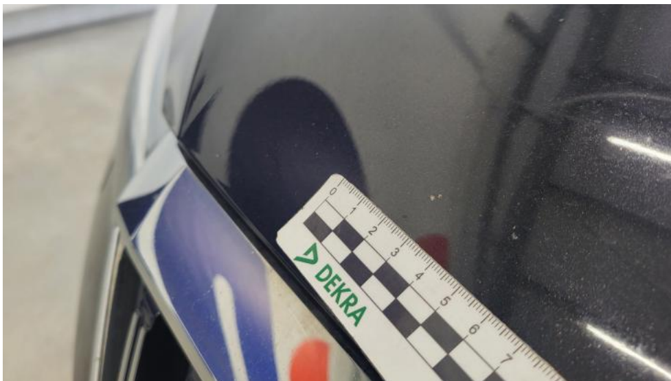
Photo 41. Pokrywa komory silnika - Rysa/odprysk 1
