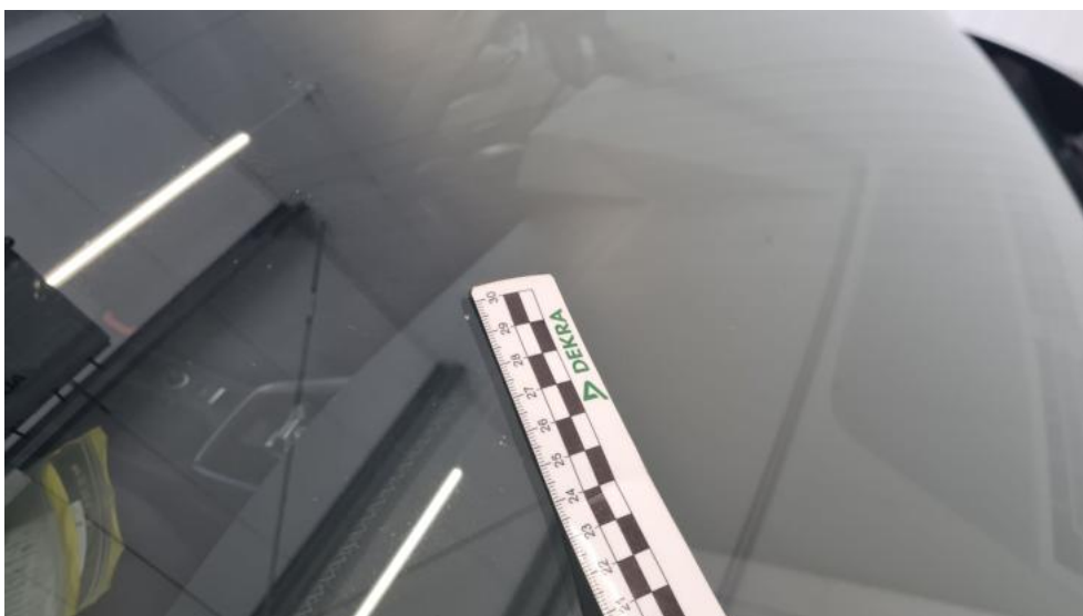
Photo 36. Szyba czołowa - Rysa/odprysk 1
