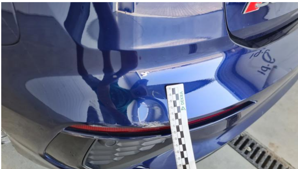
Photo 49. Zderzak tylny - Wgniecenie/odkształcenie 1
