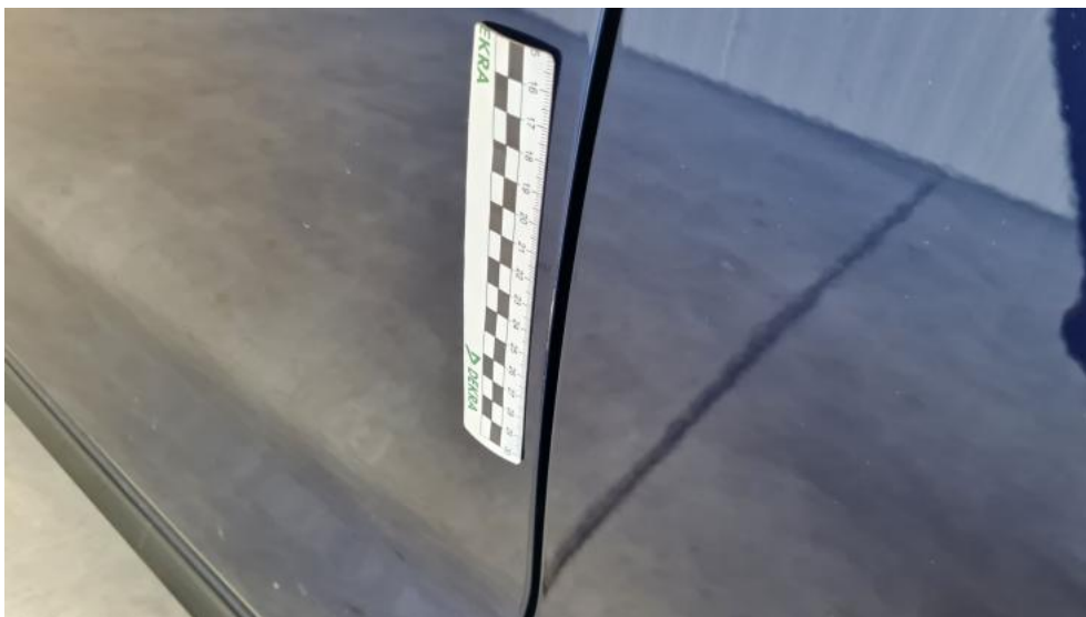
Photo 55. Drzwi przed L - Rysa/odprysk 1
