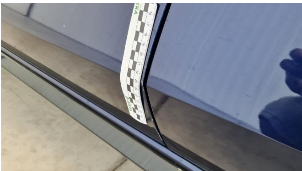
Photo 56. Drzwi przed L - Rysa/odprysk 2
