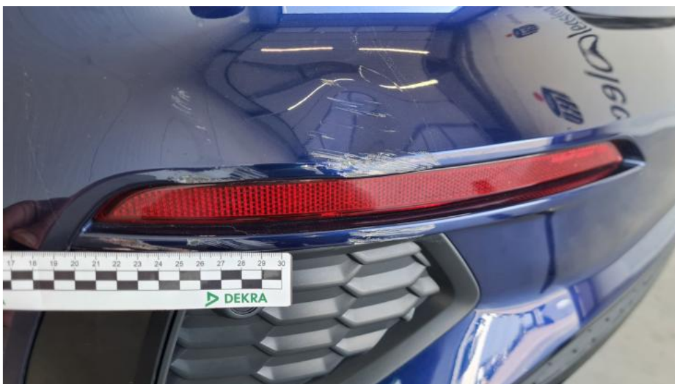
Photo 48. Zderzak tylny - Rysa/odprysk 2
