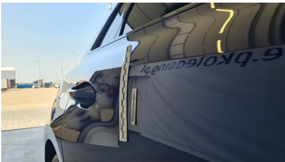
Photo 44. Drzwi tylne P - Wgniecenie/odkształcenie 2
