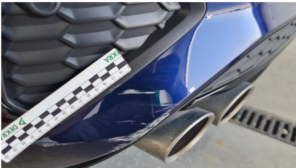
Photo 47. Zderzak tylny - Rysa/odprysk 1
