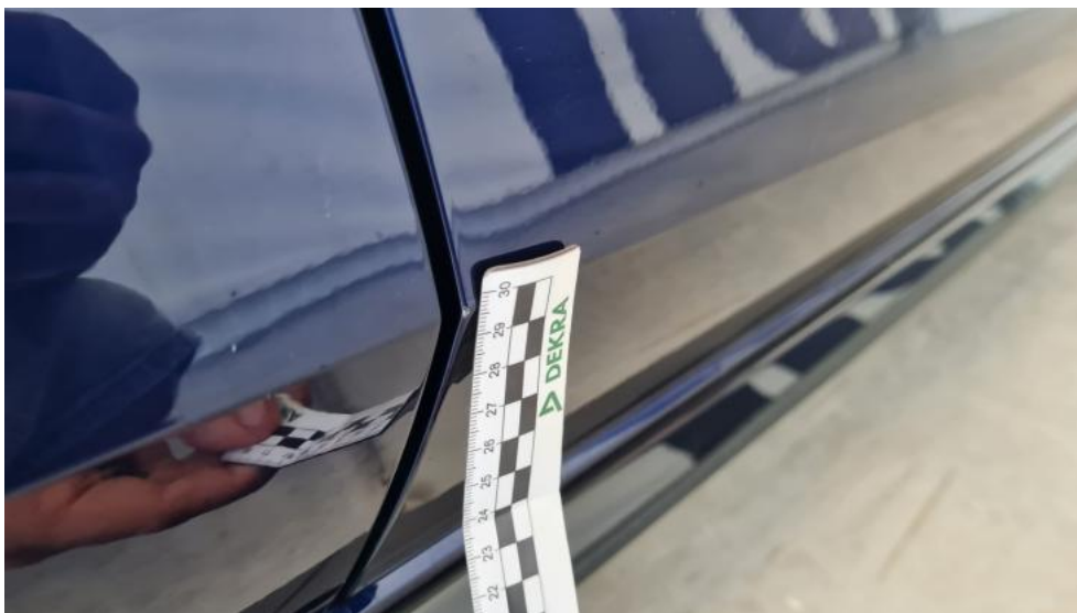
Photo 41. Drzwi przednie P - Rysa/odprysk 1
