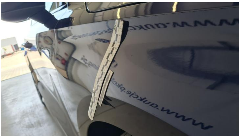
Photo 40. Błotnik przedni P - Wgniecenie/odkształcenie 1
