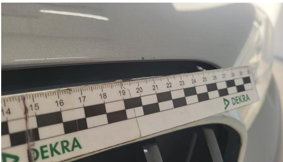
Photo 39. Pokrywa komory silnika - Rysa/odprysk 1
