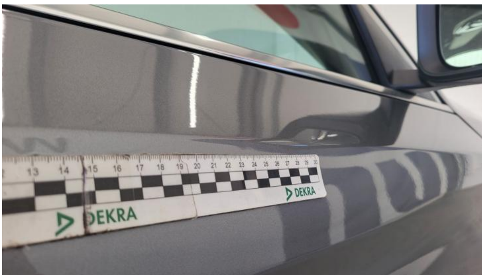
Photo 42. Drzwi przednie P - Wgniecenie/odkształcenie 1
