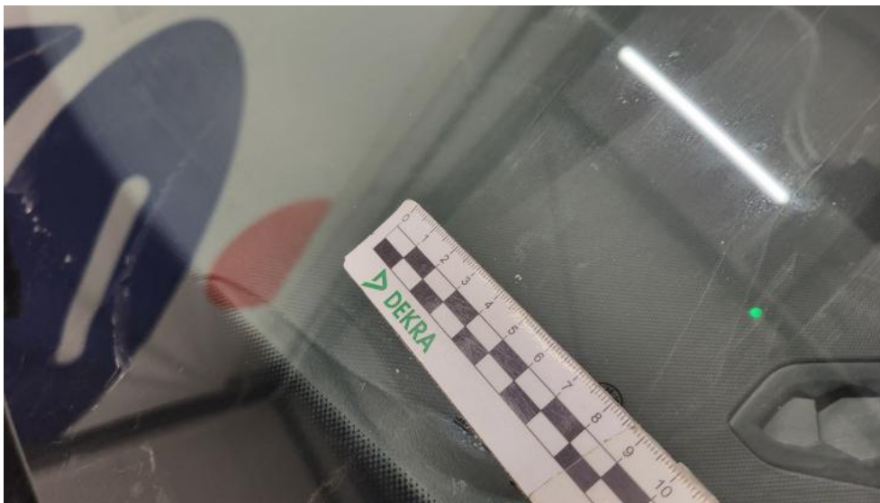
Fot. 39. Szyba czołowa - Rysa/odprysk 1
