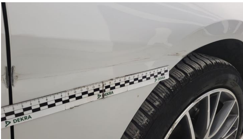
Fot. 47. Błotnik przedni P - Rysa/odprysk 1
