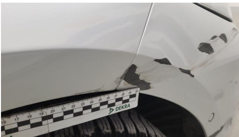
Fot. 48. Błotnik przedni P - Rysa/odprysk 2
