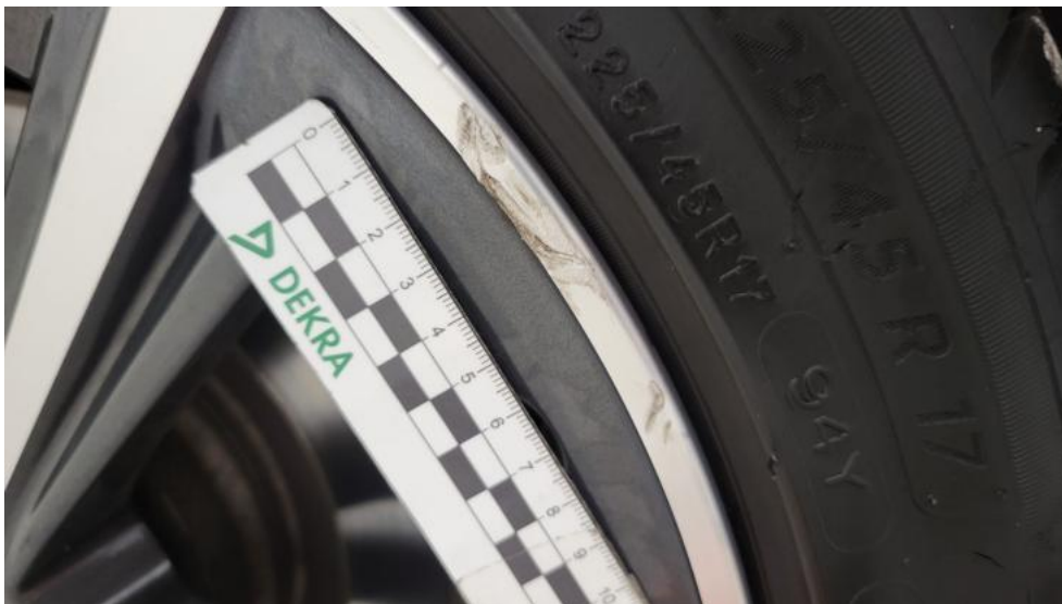
Fot. 57. Felga aluminiowa tylna P - Rysa/odprysk 1
