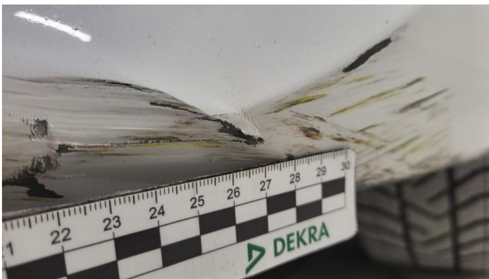
Fot. 46. Zderzak - Pęknięcie/rozerwanie 1
