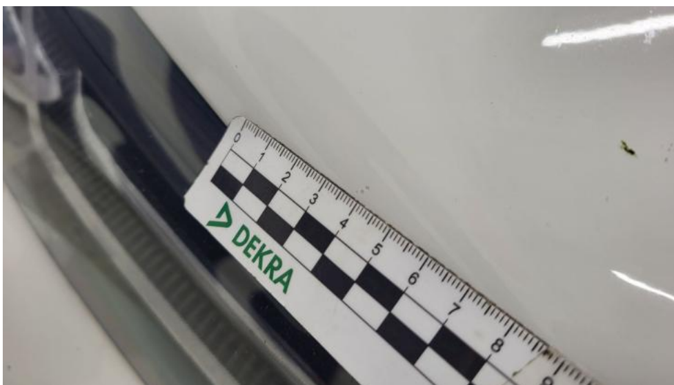
Photo 41. Pokrywa komory silnika - Rysa/odprysk 1
