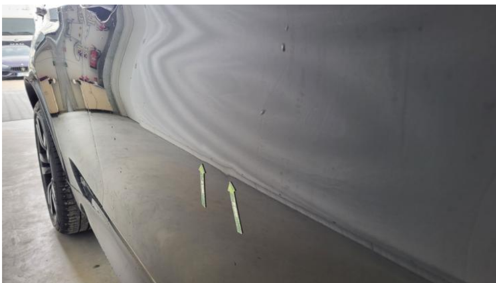
Fot. 52. Drzwi przednie P - Wgniecenie/odkształcenie 1
