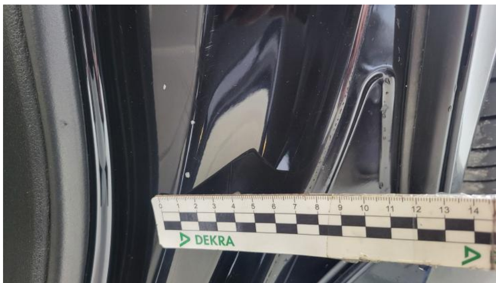
Fot. 69. Błotnik tylny L / Ściana boczna L - Rysa/odprysk 2
