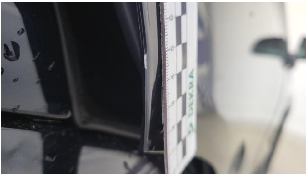
Fot. 55. Drzwi tylne P - Rysa/odprysk 2
