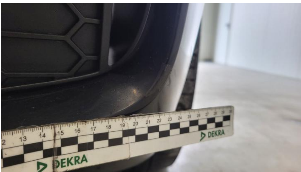
Fot. 46. Zderzak - Rysa/odprysk 1
