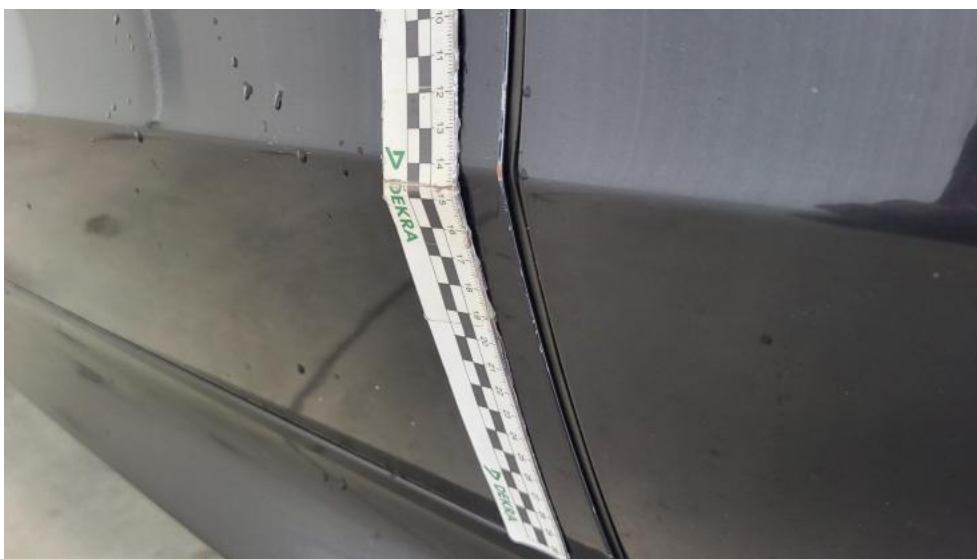
Fot. 71. Drzwi przed L - Rysa/odprysk 1
