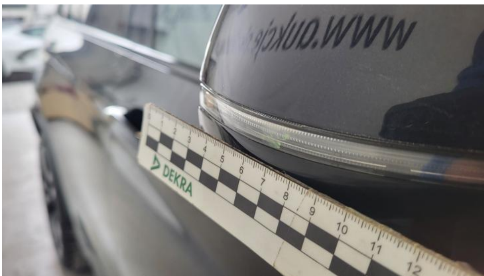
Fot. 56. Lusterko zew P - Rysa/odprysk 1
