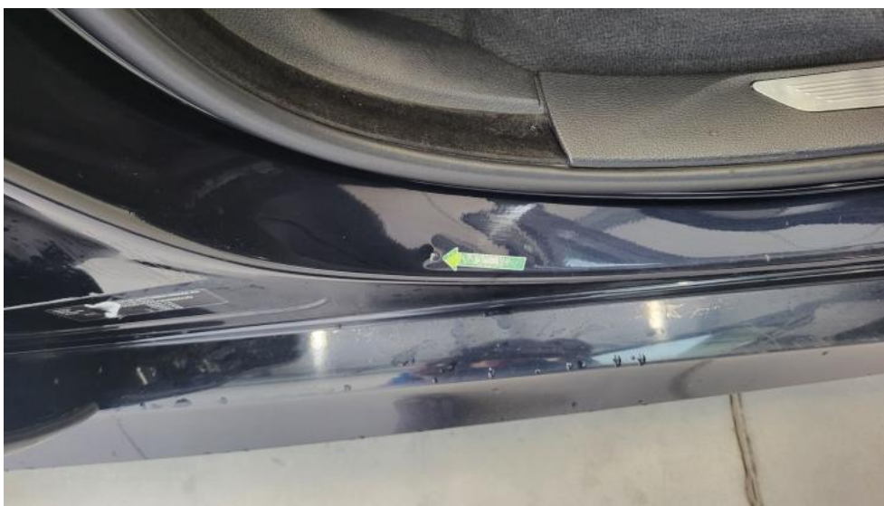
Fot. 59. Próg P - Wgniecenie/odkształcenie 1
