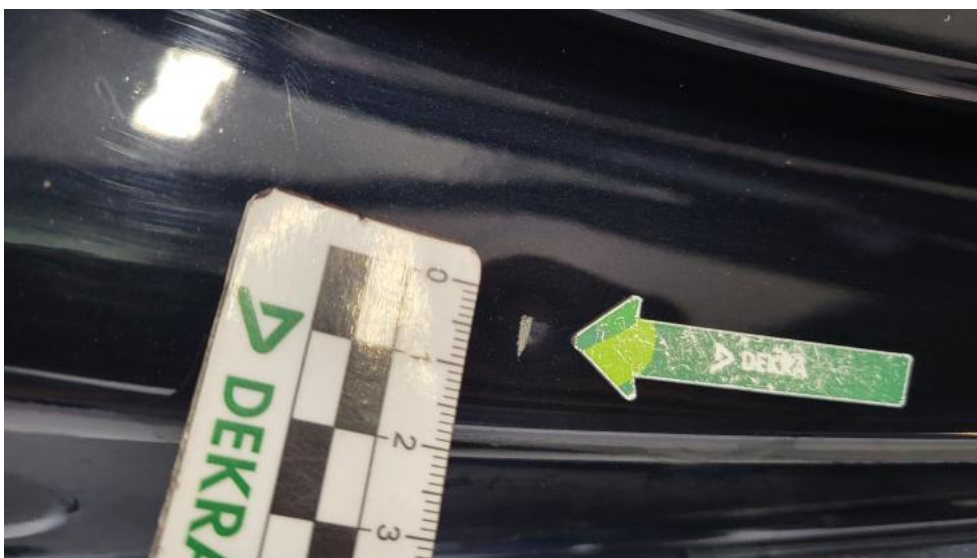
Fot. 58. Próg P - Rysa/odprysk 1
