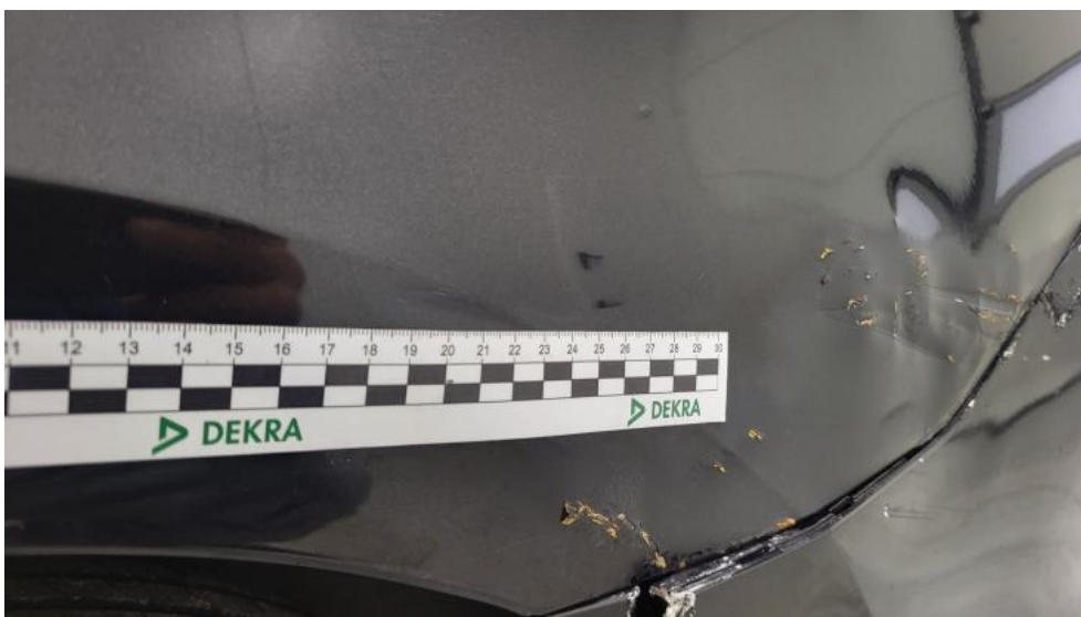
Fot. 134. Błotnik tylny L / Ściana boczna L - Rysa/odprysk 2
