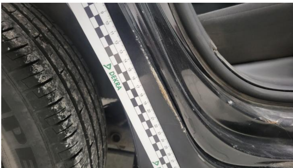
Fot. 99. Błotnik tylny P / Ściana boczna P() - Rysa/odprysk 3
