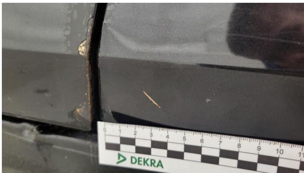
Fot. 63. Drzwi przednie P - Rysa/odprysk 1
