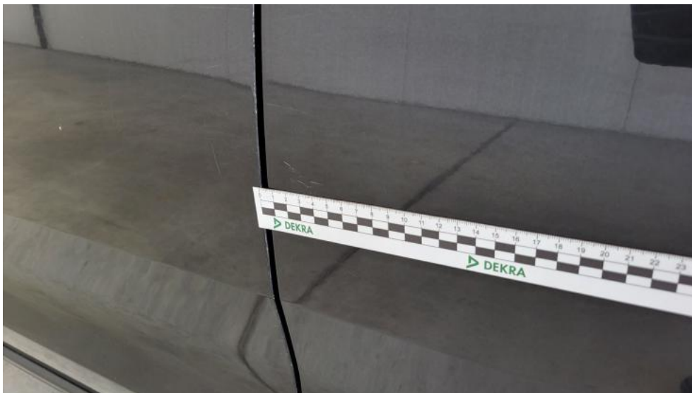
Fot. 151. Drzwi tylne L - Rysa/odprysk 2
