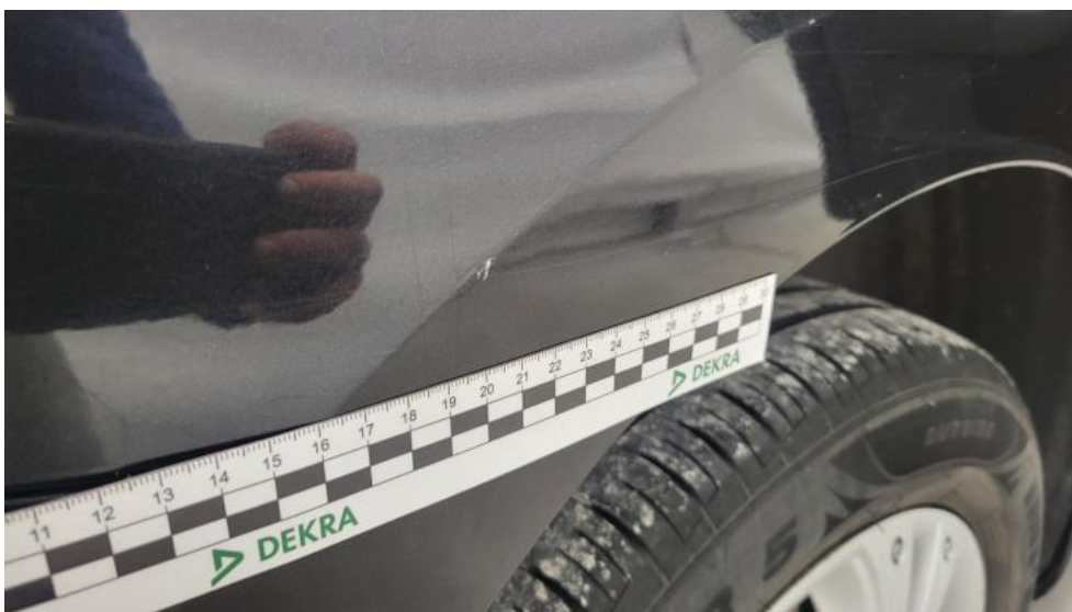
Fot. 98. Błotnik tylny P / Ściana boczna P - Rysa/odprysk 2
