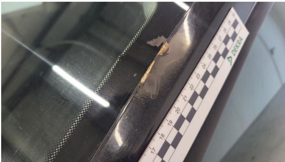
Fot. 161. Stupek przedni L - Rysa/odprysk 1
