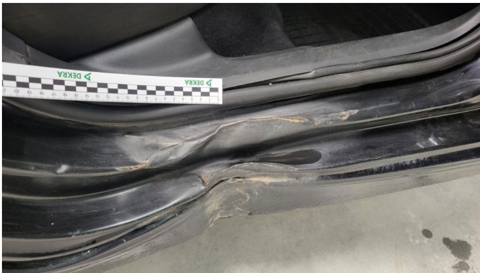
Fot. 89. Próg P() - Wgniecenie/odkształcenie 3
