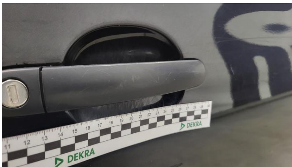
Fot. 82. Klamka drzwi prz P - Rysa/odprysk 1
