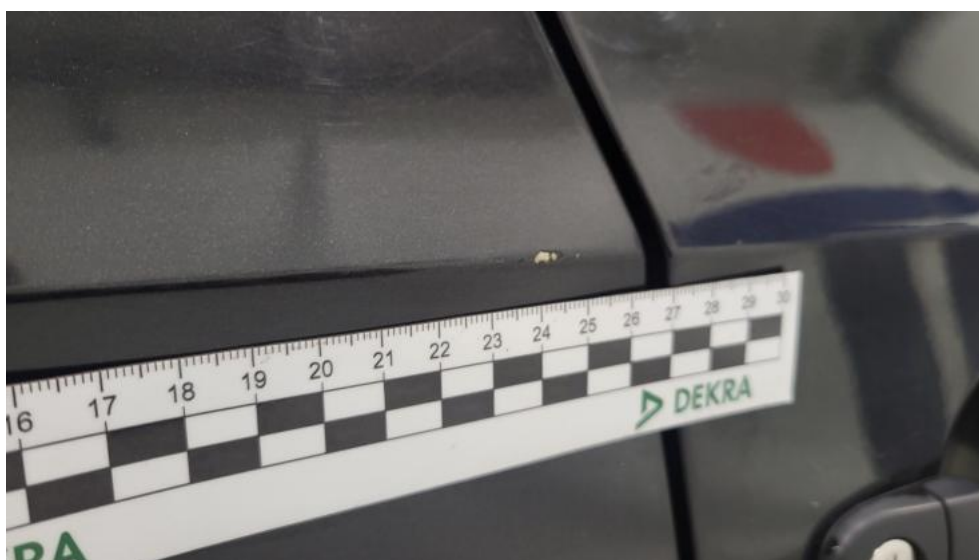
Fot. 74. Drzwi tylne P - Rysa/odprysk 1
