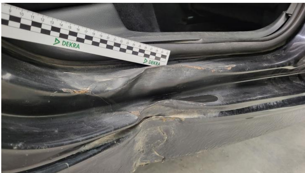
Fot. 88. Próg P - Wgniecenie/odkształcenie 2
