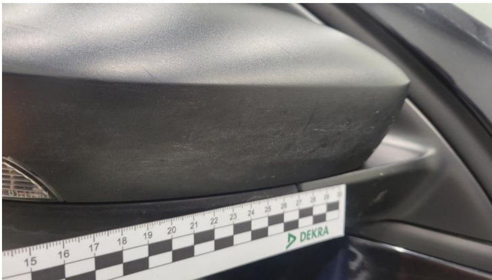
Fot. 83. Lusterko zew P - Rysa/odprysk 1
