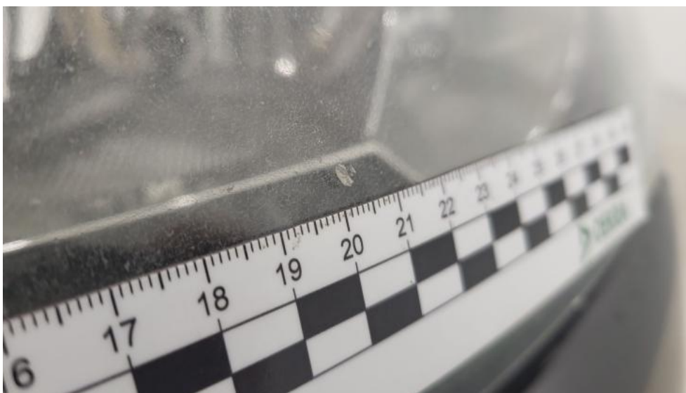
Fot. 167. Reflektor L - Pęknięcie/rozerwanie 1
