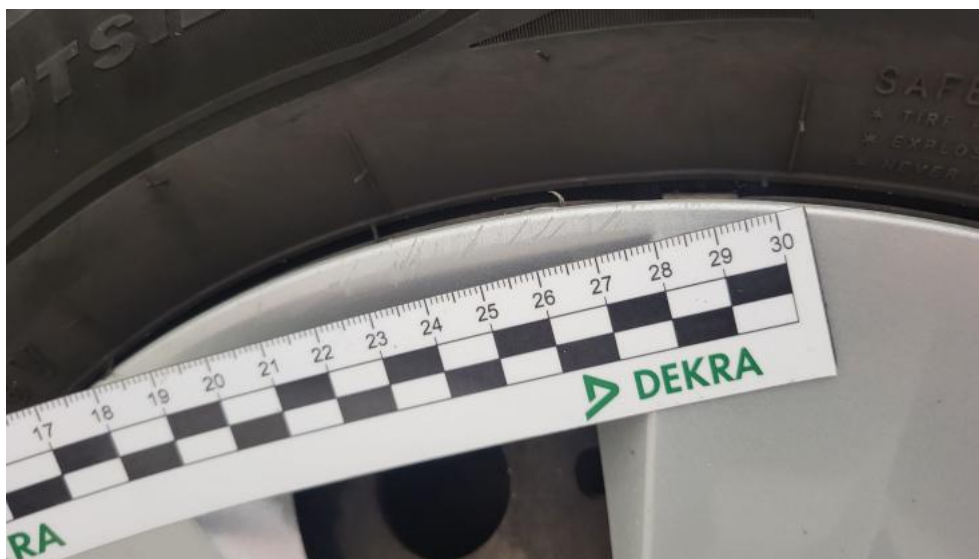
Fot. 57. Kołpak przedni P - Rysa/odprysk 1
