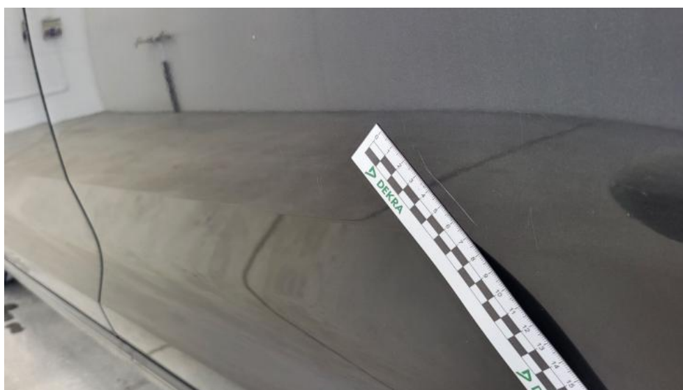
Fot. 150. Drzwi tylne L - Rysa/odprysk 1
