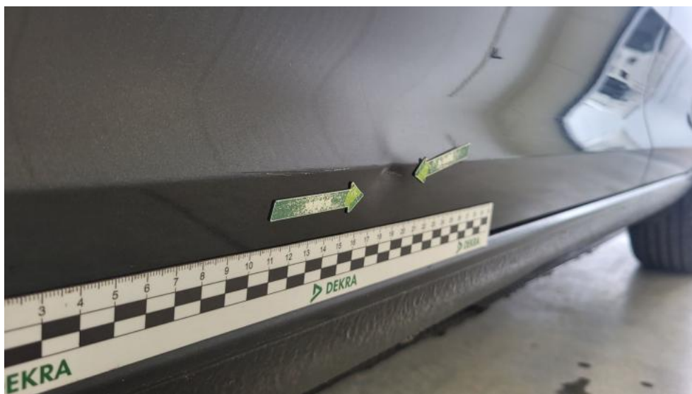
Fot. 148. Drzwi przed L() - Wgniecenie/odkształcenie 3
