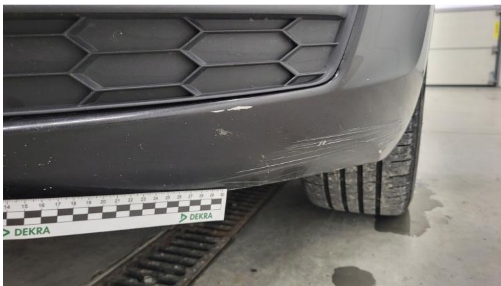
Fot. 51. Zderzak - Rysa/odprysk 2
