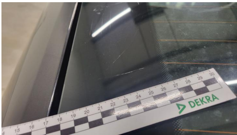
Fot. 114. Szyba tylna - Rysa/odprysk 1
