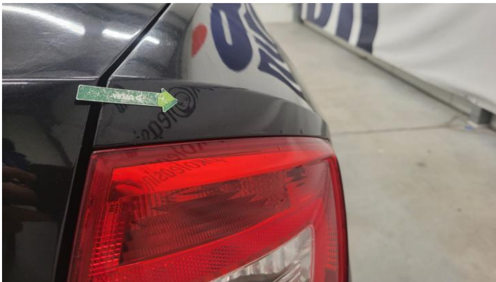
Fot. 101. Błotnik tylny P / Ściana boczna P - Wgniecenie/odkształcenie 2
