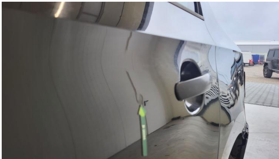
Fot. 153. Drzwi tylne L - Wgniecenie/odkształcenie 1
