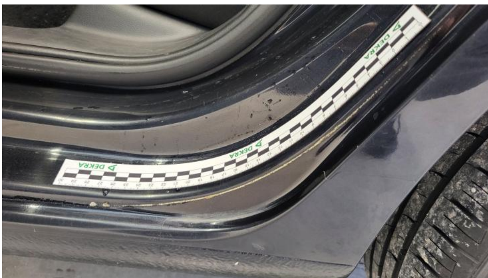
Fot. 155. Próg L - Rysa/odprysk 1
