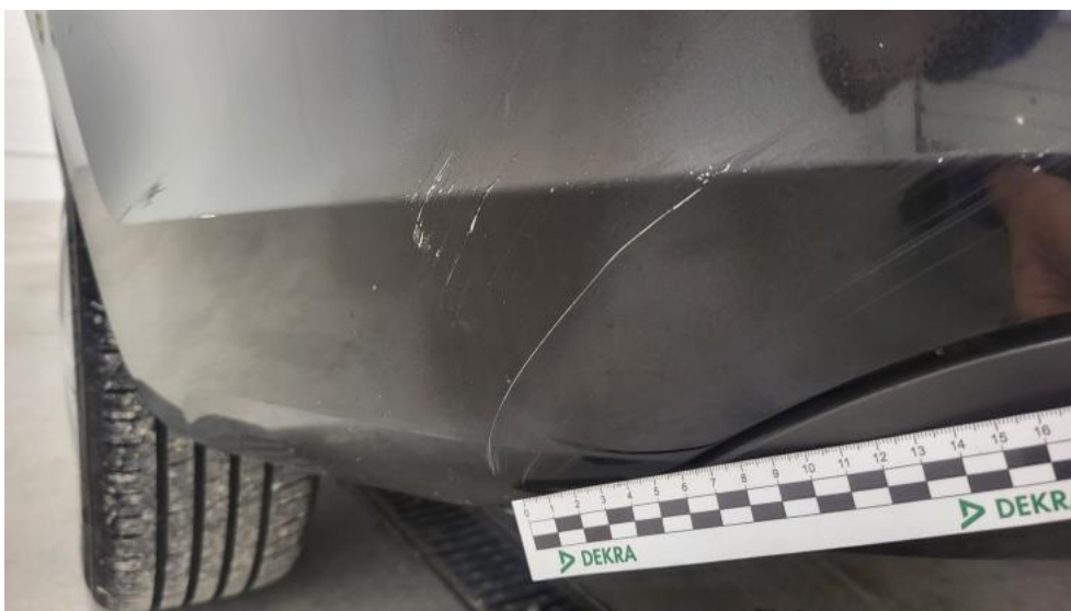
Fot. 118. Zderzak tylny - Rysa/odprysk 1
