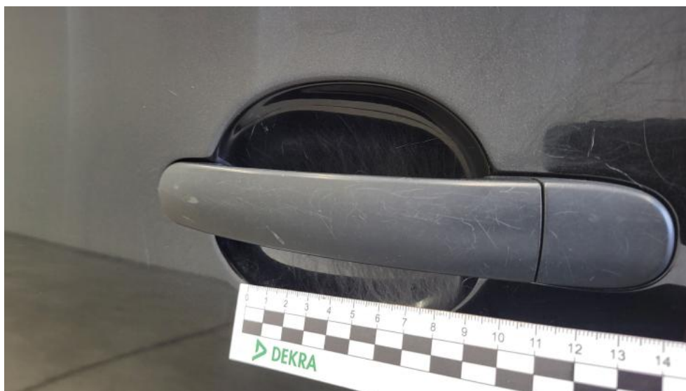
Fot. 154. Klamka drzwi tyl L - Rysa/odprysk 1
