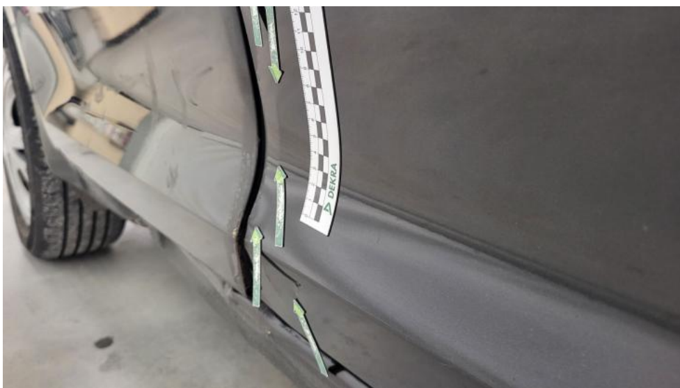
Fot. 68. Drzwi przednie P() - Wgniecenie/odkształcenie 3
