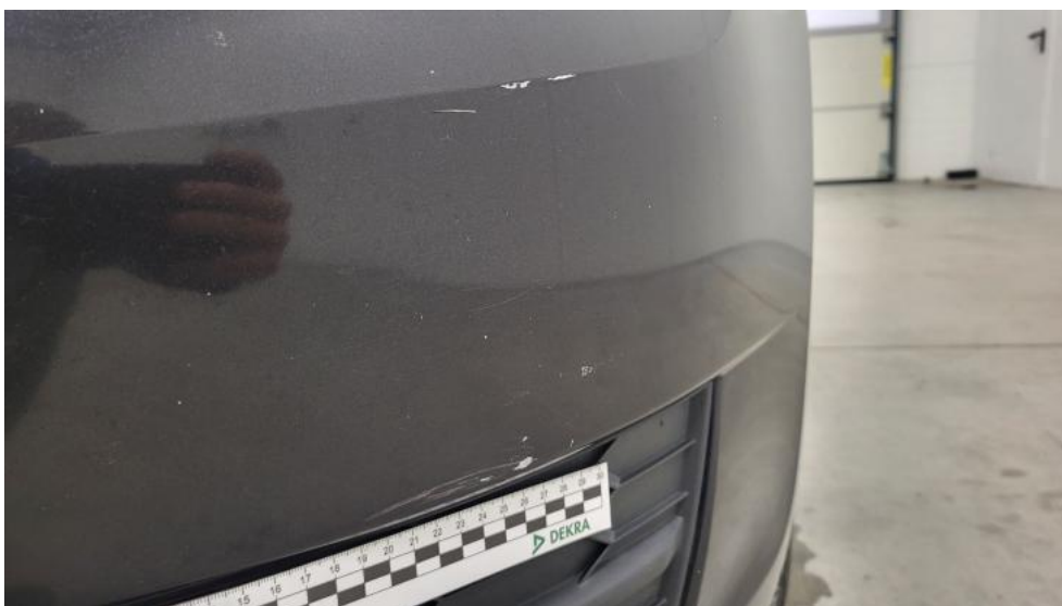
Fot. 50. Zderzak - Rysa/odprysk 1
