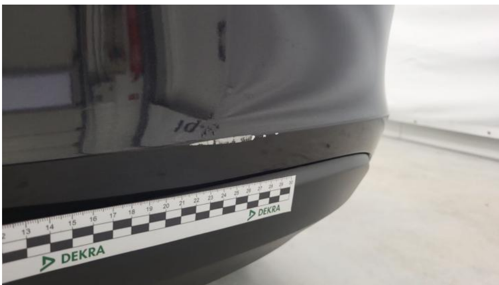
Fot. 120. Zderzak tylny() - Rysa/odprysk 3
