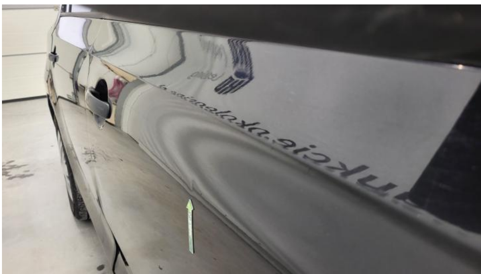
Fot. 66. Drzwi przednie P - Wgniecenie/odkształcenie 1
