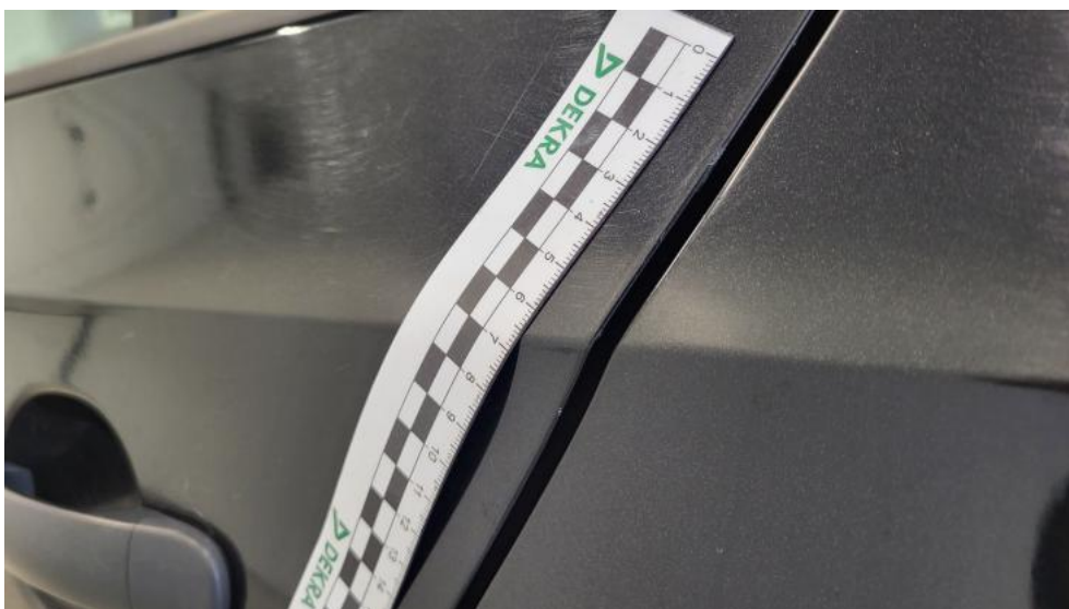
Fot. 152. Drzwi tylne L() - Rysa/odprysk 3
