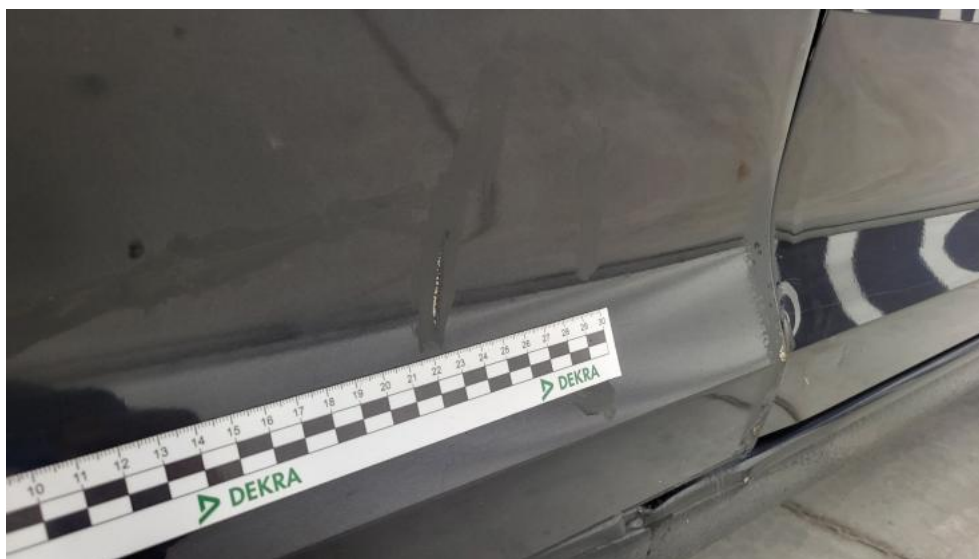
Fot. 75. Drzwi tylne P - Rysa/odprysk 2
