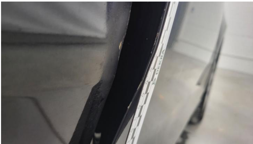
Fot. 65. Drzwi przednie P() - Rysa/odprysk 3
