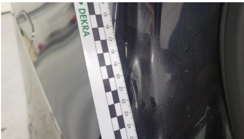
Fot. 97. Błotnik tylny P / Ściana boczna P - Rysa/odprysk 1
