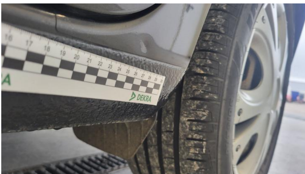
Fot. 158. Próg L - Wgniecenie/odkształcenie 2
