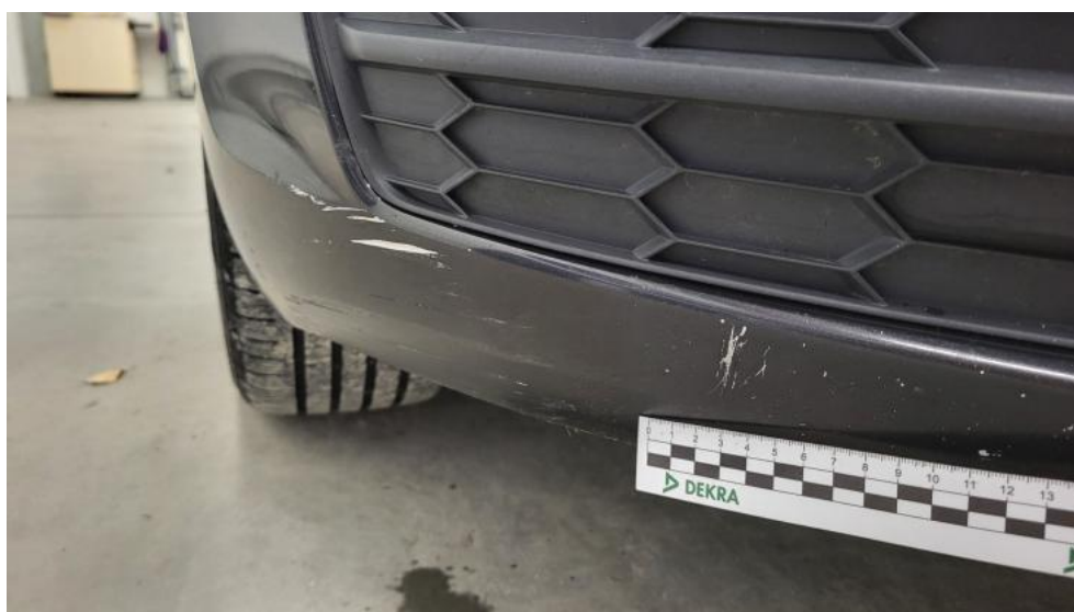
Fot. 52. Zderzak() - Rysa/odprysk 3
