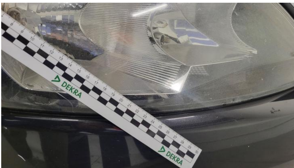
Fot. 60. Reflektor P - Rysa/odprysk 2
