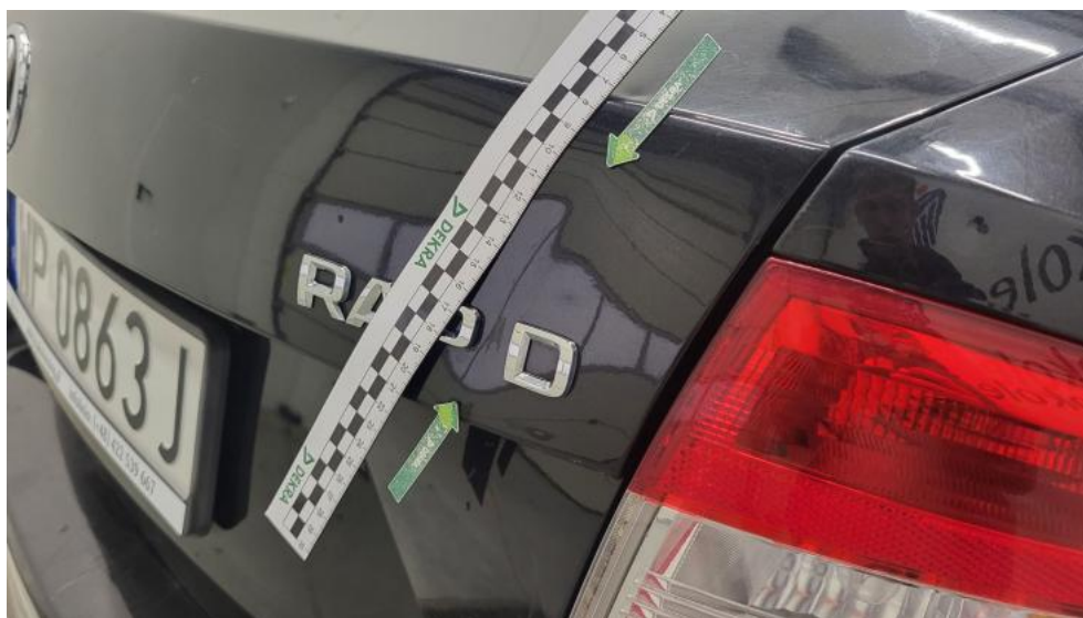
Fot. 109. Pokrywy bagażnika - Wgniecenie/odkształcenie 2
