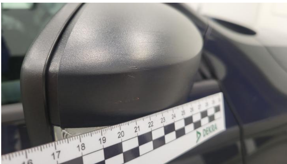
Fot. 84. Lusterko zew P - Rysa/odprysk 2
