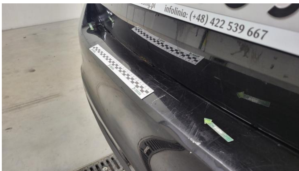
Fot. 121. Zderzak tylny - Wgniecenie/odkształcenie 1
