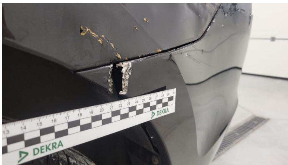
Fot. 122. Zderzak tylny - Pęknięcie/rozerwanie 1
