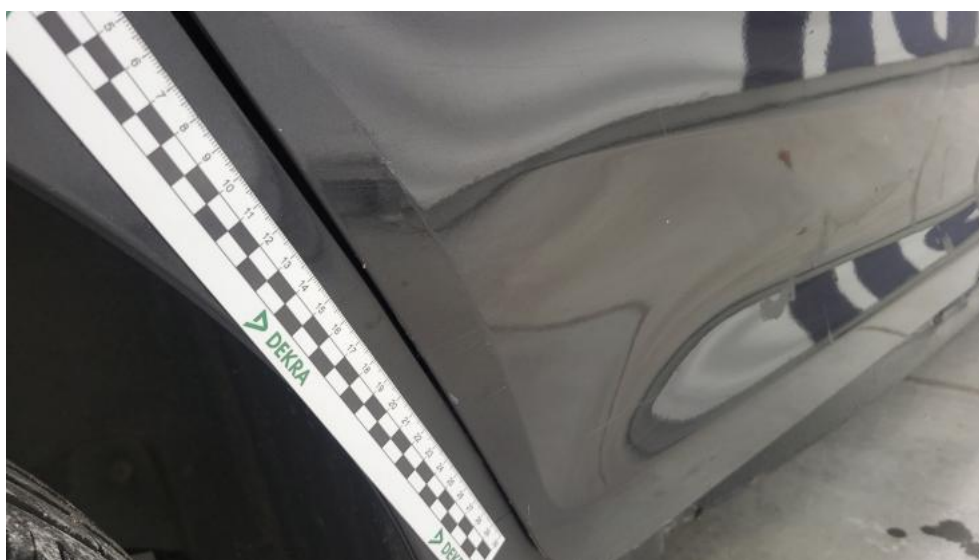
Fot. 76. Drzwi tylne P() - Rysa/odprysk 3
