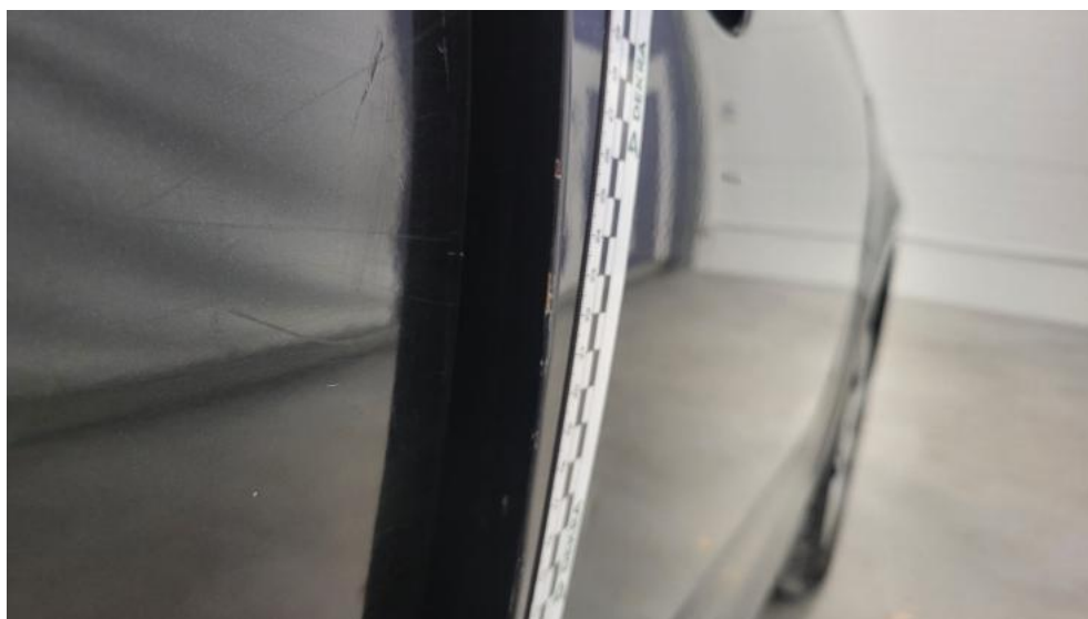
Fot. 64. Drzwi przednie P - Rysa/odprysk 2
