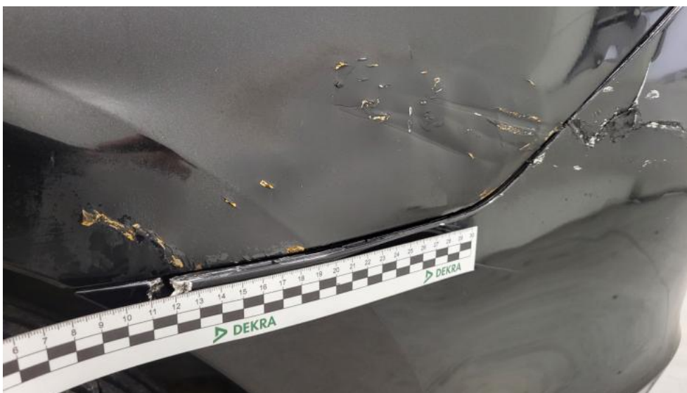
Fot. 133. Błotnik tylny L / Ściana boczna L - Rysa/odprysk 1
