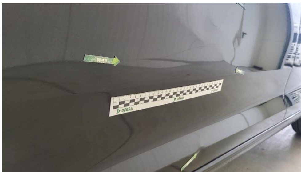
Fot. 147. Drzwi przed L - Wgniecenie/odkształcenie 2
