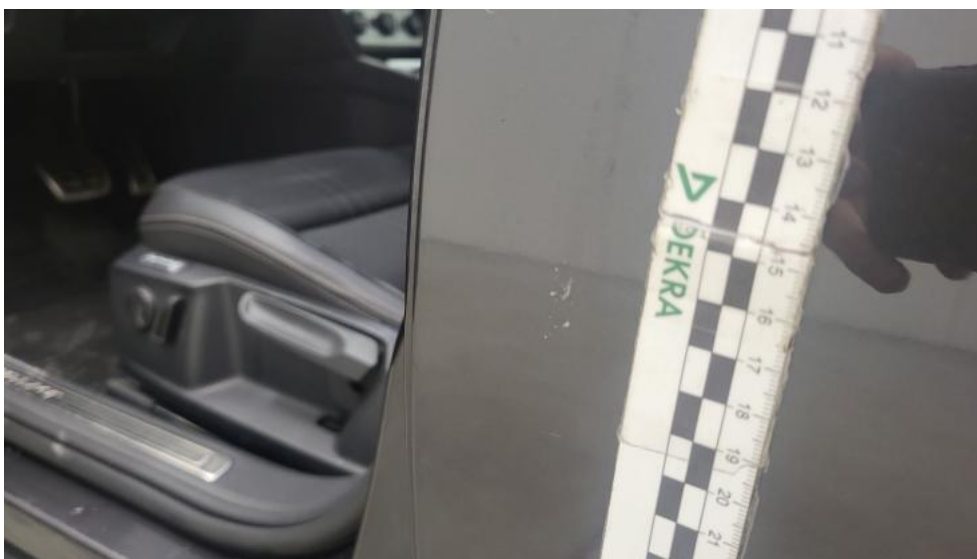
Fot. 81. Drzwi tylne L - Rysa/odprysk 2
