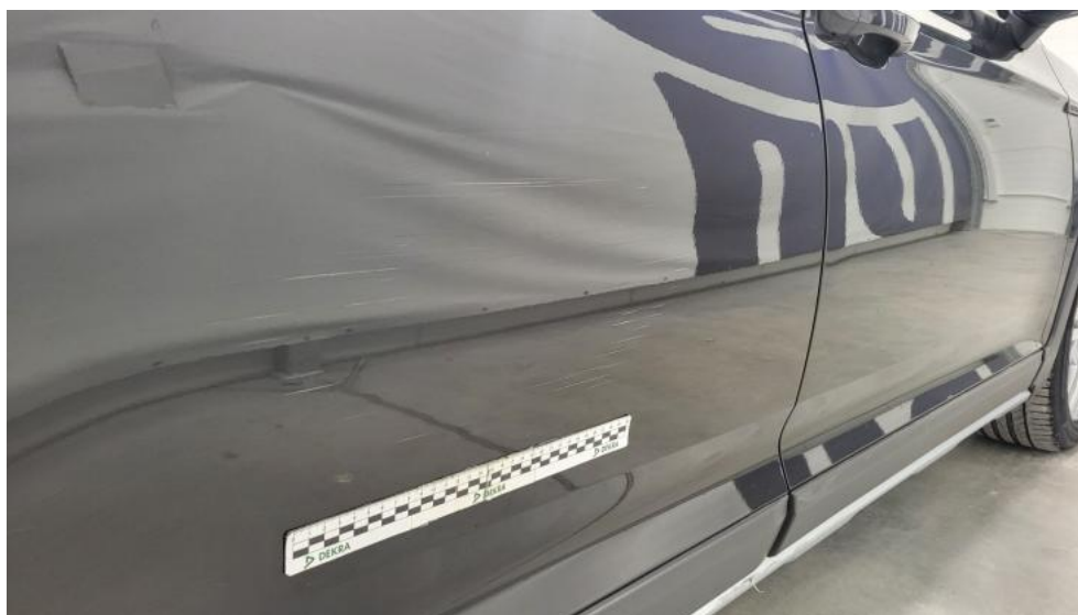
Fot. 53. Drzwi tylne P - Rysa/odprysk 1
