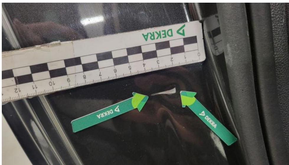
Fot. 63. Błotnik tylny P / Ściana boczna P - Rysa/odprysk 1
