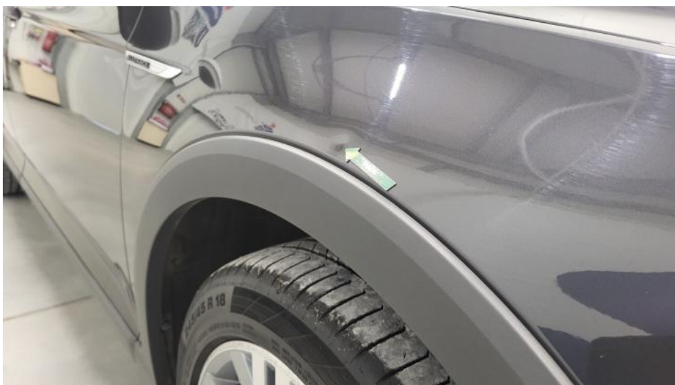
Fot. 50. Błotnik przedni P - Wgniecenie/odkształcenie 1
