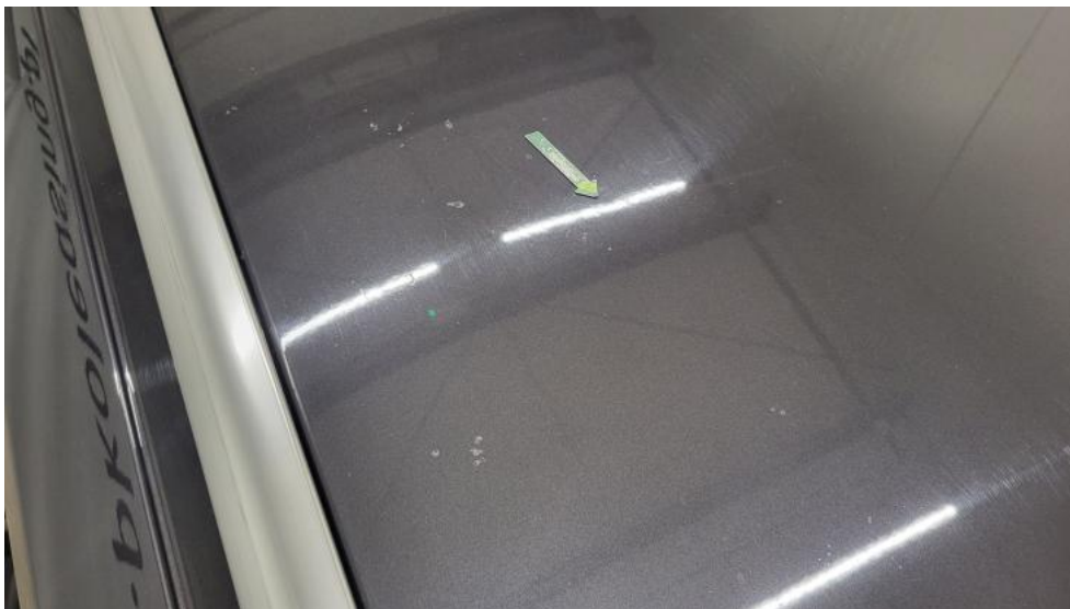
Fot. 75. Dach - Wgniecenie/odkształcenie 2
