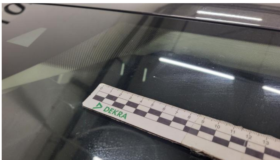
Fot. 48. Szyba czołowa - Rysa/odprysk 1
