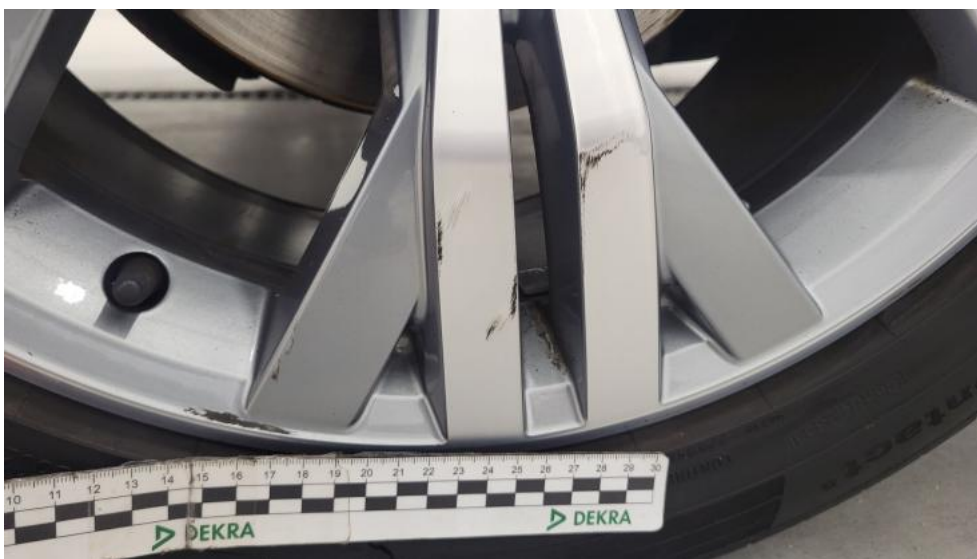
Fot. 65. Felga aluminiowa tylna P - Rysa/odprysk 1
