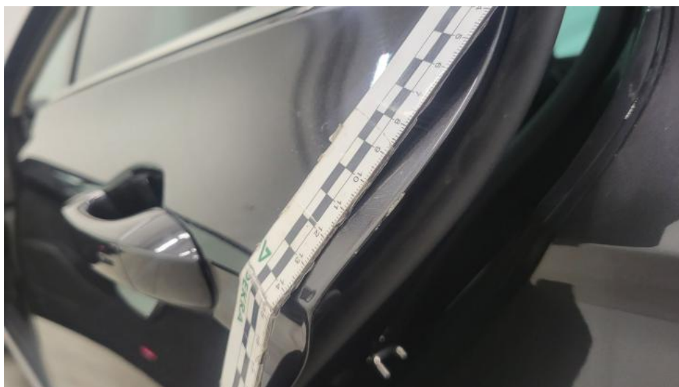
Fot. 80. Drzwi tylne L - Rysa/odprysk 1
