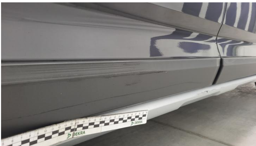
Fot. 57. Listwa drzwi tylnych P - Rysa/odprysk 2
