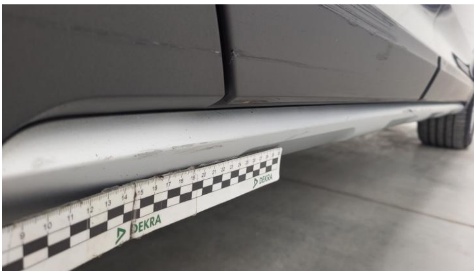
Fot. 62. Próg P() - Rysa/odprysk 3
