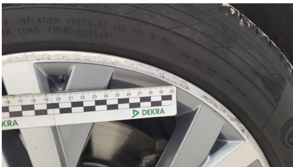
Fot. 52. Felga aluminiowa przednia P - Rysa/odprysk 2
