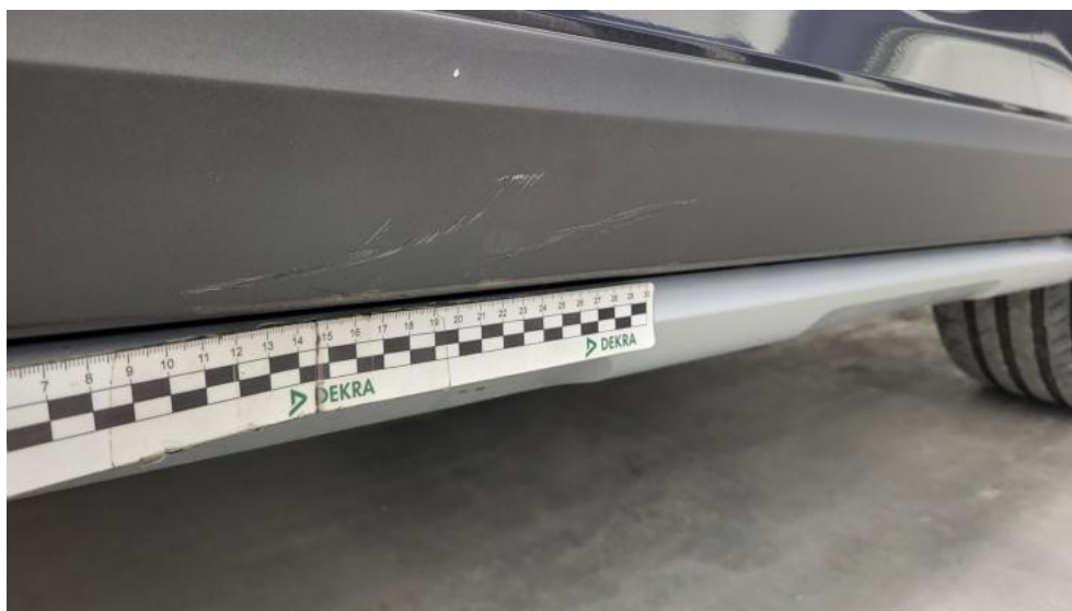
Fot. 54. Listwa drzwi przednich P - Rysa/odprysk 1
