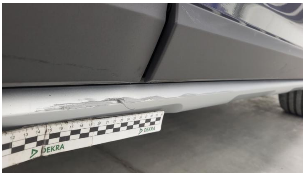
Fot. 60. Próg P - Rysa/odprysk 1
