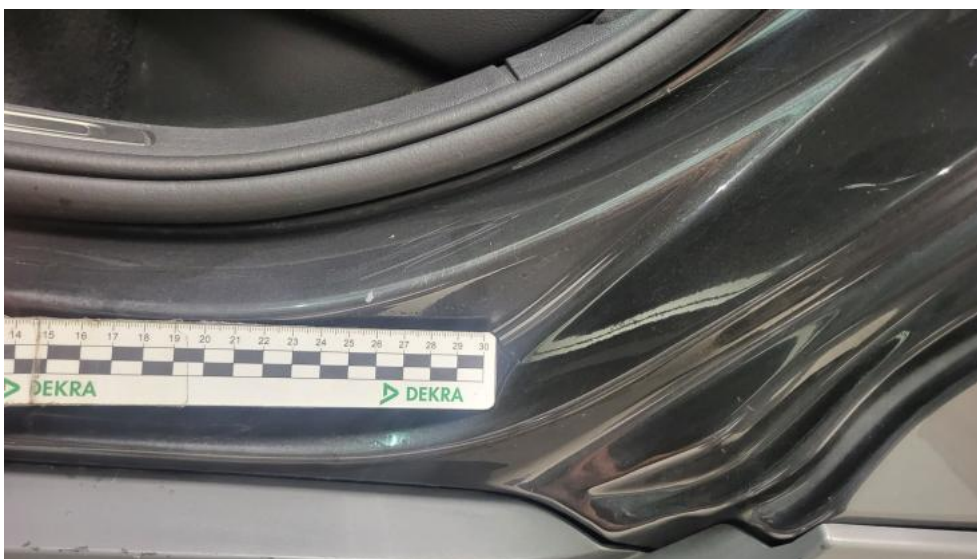
Fot. 77. Błotnik tylny L / Ściana boczna L - Rysa/odprysk 2
