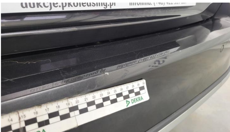
Fot. 70. Zderzak tylny - Rysa/odprysk 1
