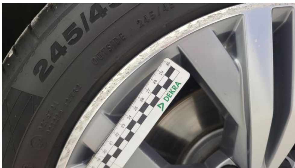
Fot. 51. Felga aluminiowa przednia P - Rysa/odprysk 1
