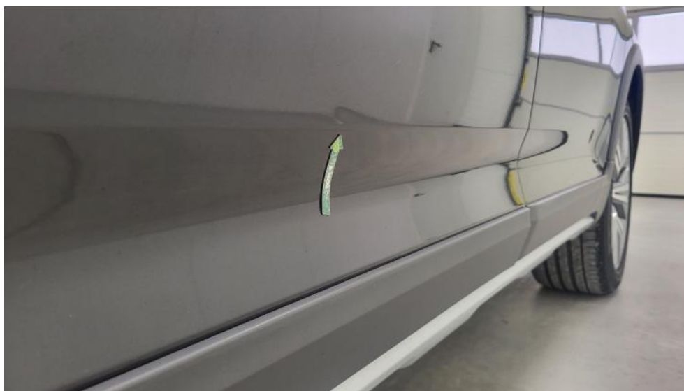
Fot. 79. Drzwi przed L - Wgniecenie/odkształcenie 1
