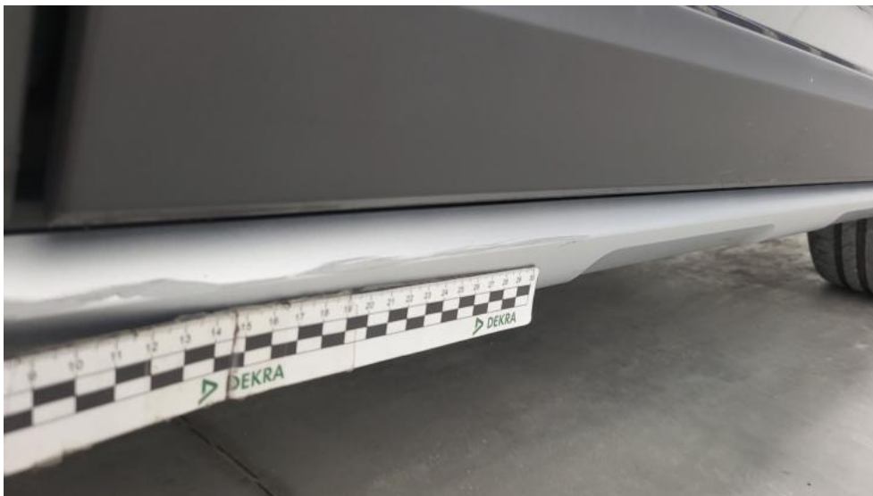
Fot. 61. Próg P - Rysa/odprysk 2
