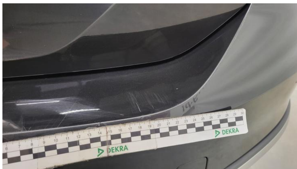
Fot. 72. Zderzak tylny() - Rysa/odprysk 3
