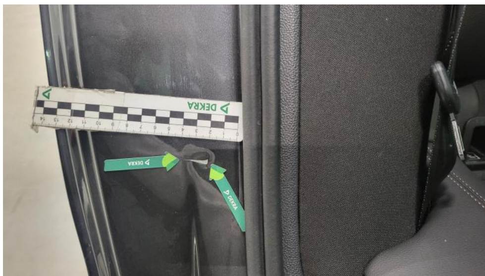
Fot. 64. Błotnik tylny P / Ściana boczna P - Wgniecenie/odkształcenie 1
