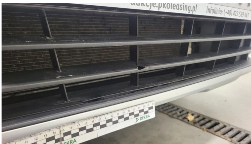
Fot. 47. Atrapa przednia - Pęknięcie/rozerwanie 1
