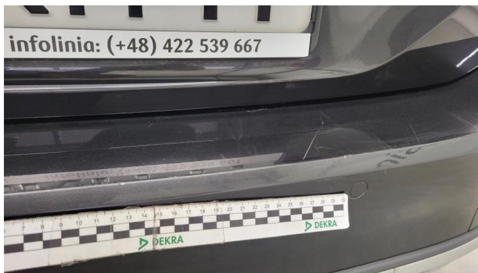
Fot. 71. Zderzak tylny - Rysa/odprysk 2
