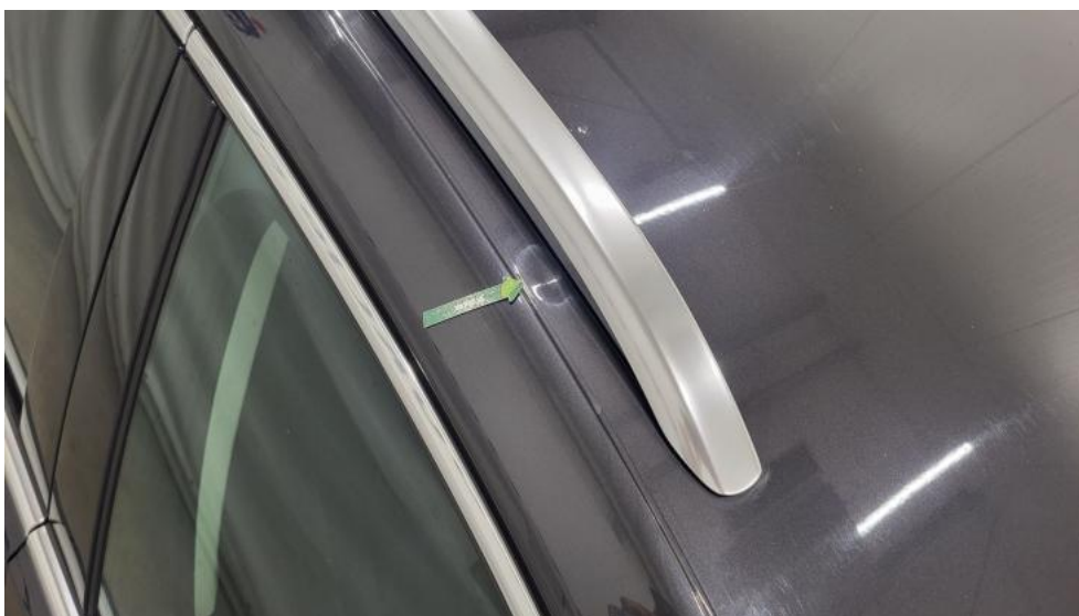
Fot. 74. Dach - Wgniecenie/odkształcenie 1
