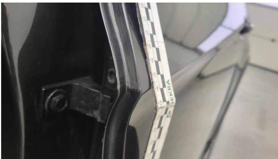
Fot. 82. Drzwi tylne L() - Rysa/odprysk 3
