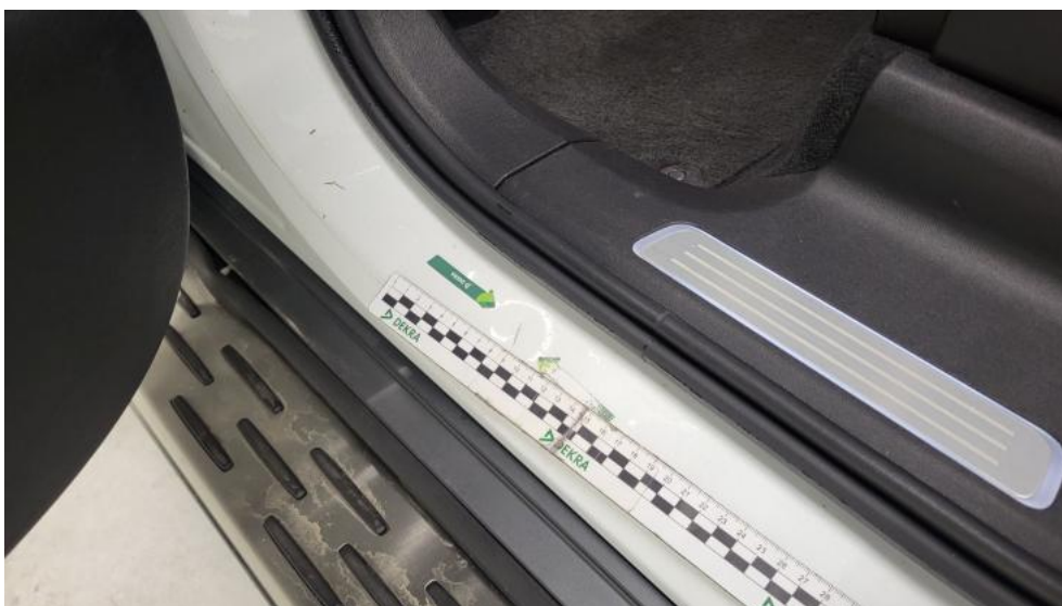
Photo 79. Próg L - Wgniecenie/odkształcenie 1
