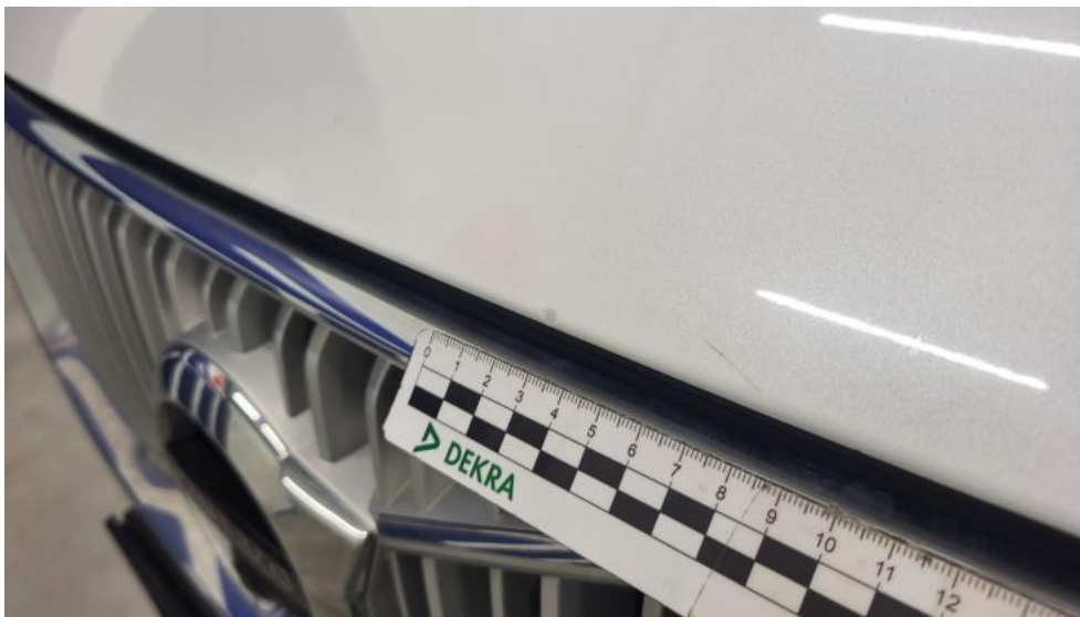
Photo 49. Pokrywa komory silnika - Rysa/odprysk 1
