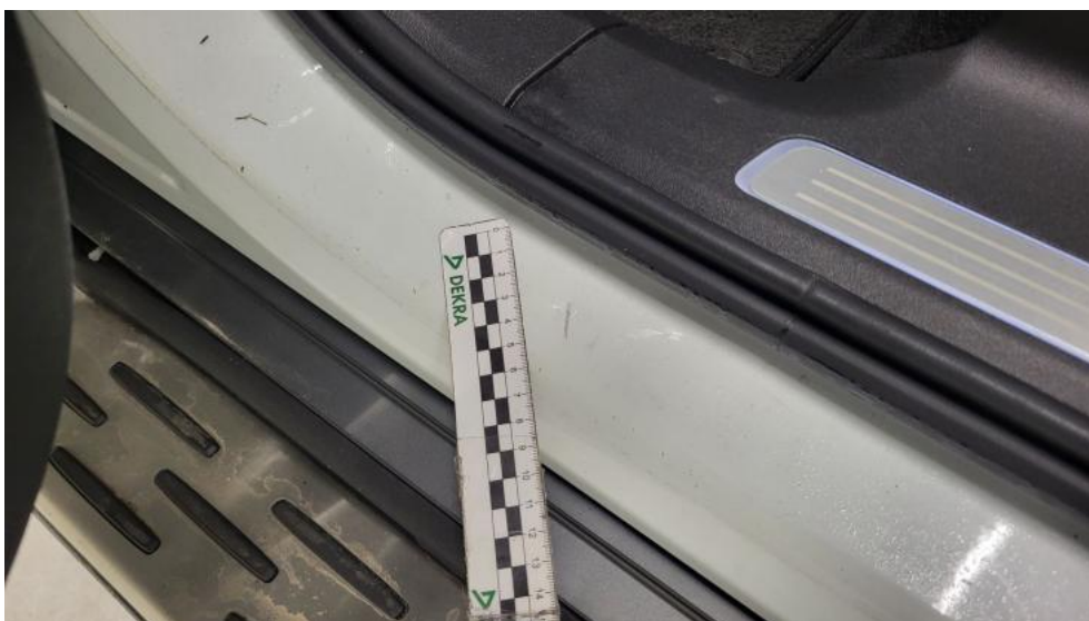
Photo 78. Próg L - Rysa/odprysk 1
