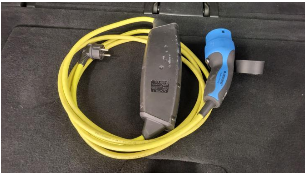
Photo 34. Przewód ładowania baterii trakcyjnej
