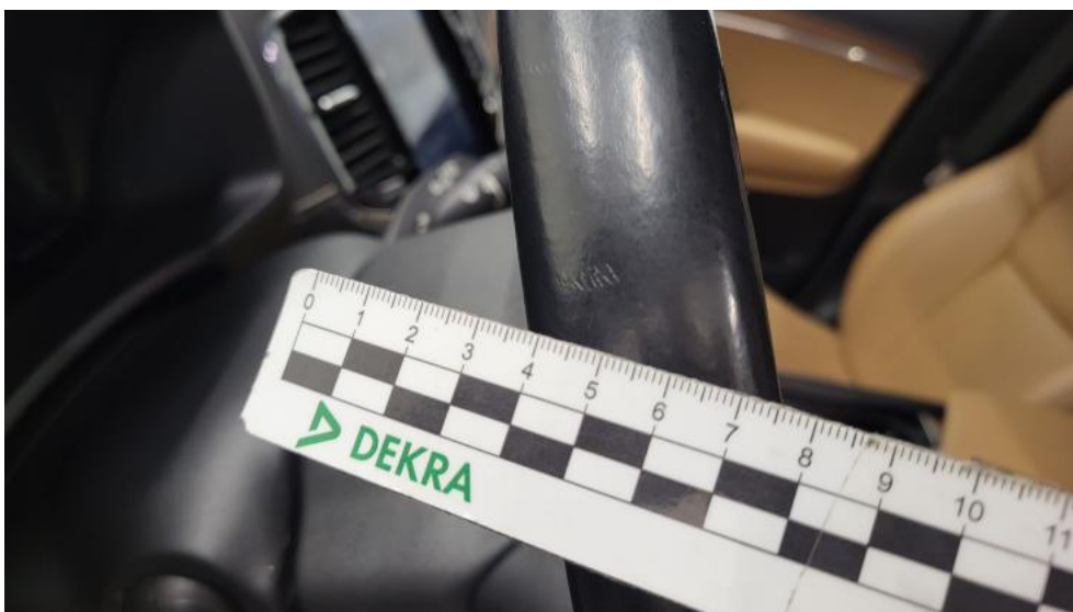
Photo 80. Koło kierownicy - Rysa/odprysk 1
