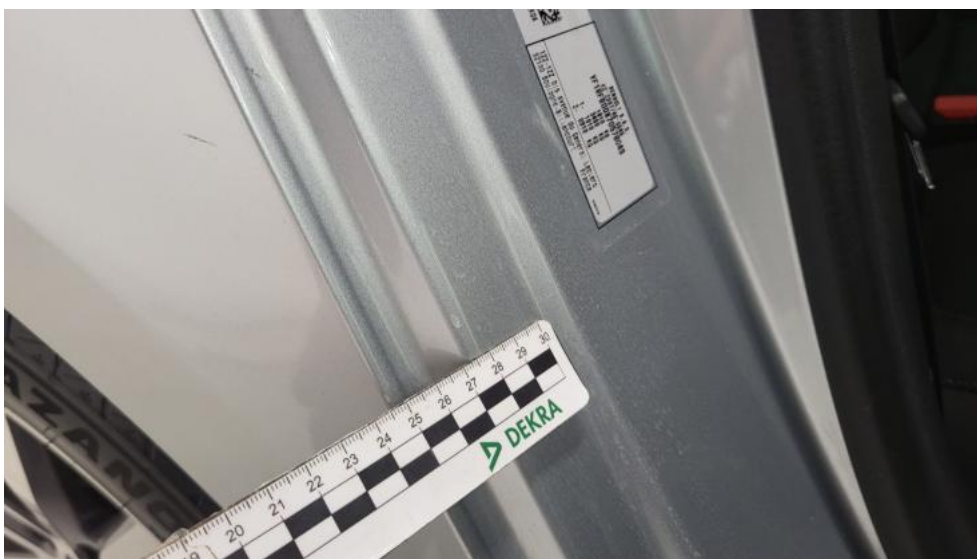
Fot. 39. Błotnik tylny P / Ściana boczna P - Rysa/odprysk 1
