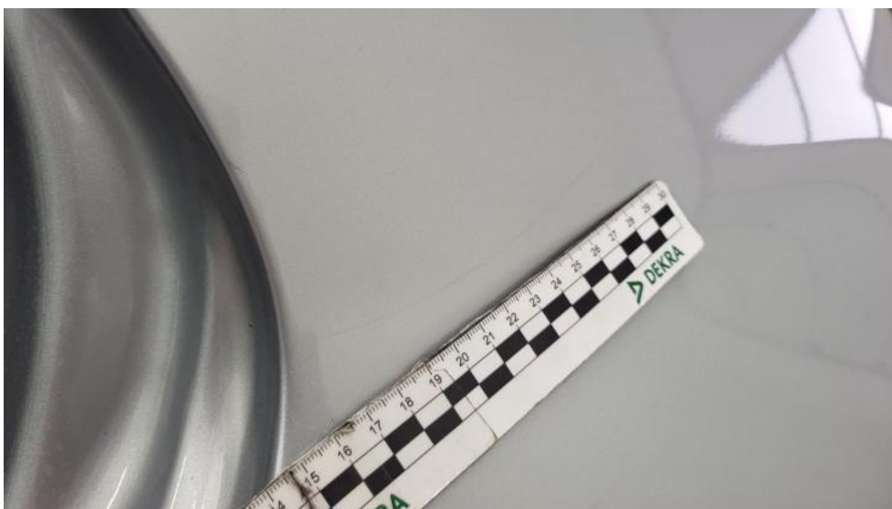
Fot. 45. Błotnik tylny L / Ściana boczna L - Rysa/odprysk 1
