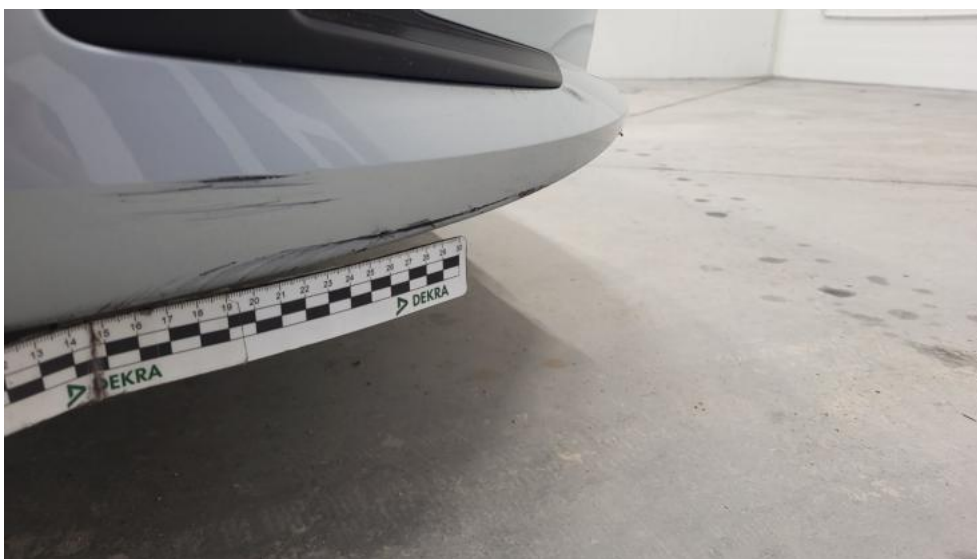
Fot. 37. Zderzak - Rysa/odprysk 2
