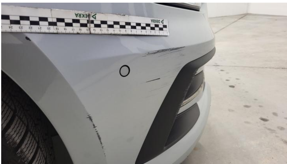
Fot. 36. Zderzak - Rysa/odprysk 1
