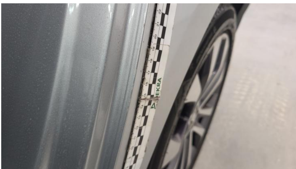
Fot. 46. Błotnik tylny L / Ściana boczna L - Rysa/odprysk 2
