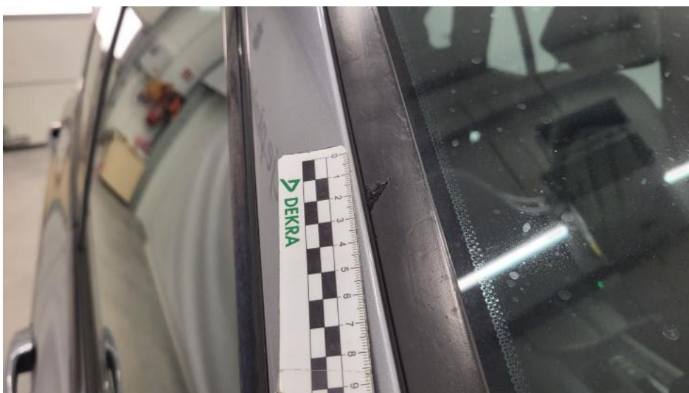
Photo 46. Uszczelka/listwa szyby czołowej - Rysa/odprysk 1
