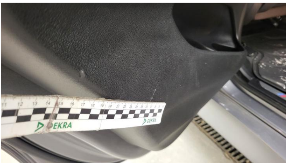
Photo 83. Tapicerka drzwi tylnych L - Wgniecenie/odkształcenie 1
