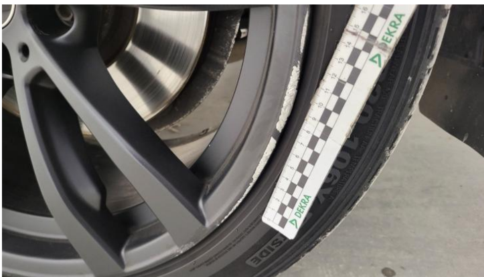
Photo 51. Felga aluminiowa przednia P - Rysa/odprysk 2
