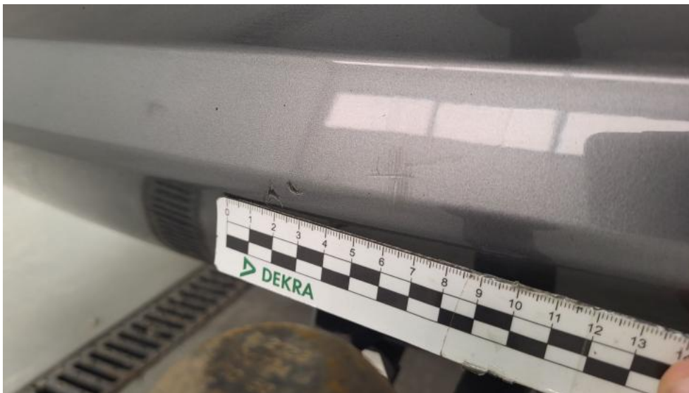
Photo 61. Zderzak tylny - Rysa/odprysk 1
