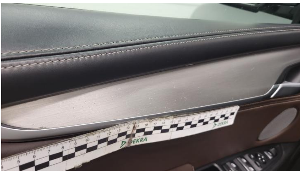
Photo 80. Tapicerka drzwi przednich L - Rysa/odprysk 1
