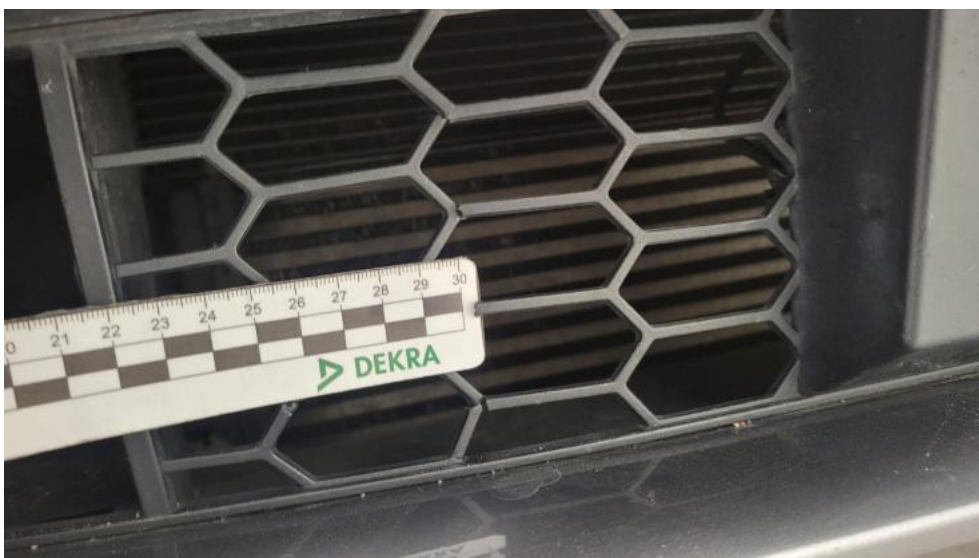
Photo 40. Krata zderzaka prz. - Pęknięcie/rozerwanie 1
