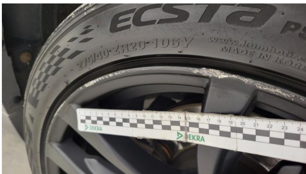
Photo 50. Felga aluminiowa przednia P - Rysa/odprysk 1
