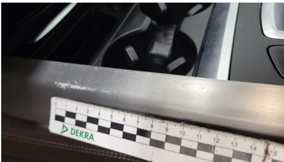
Photo 77. Konsola środkowa - Rysa/odprysk 1
