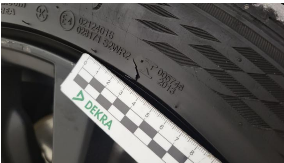
Photo 52. Opona przednia P - Pęknięcie/rozerwanie 1
