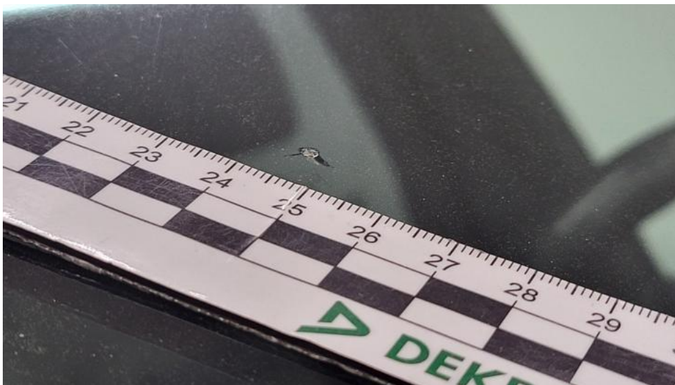
Photo 45. Szyba czołowa - Pęknięcie/rozerwanie 2
