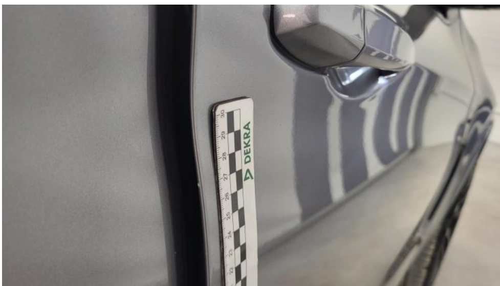
Photo 53. Drzwi przednie P - Rysa/odprysk 1
