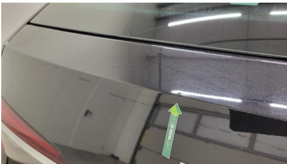
Fot. 44. Pokrywy bagażnika - Wgniecenie/odkształcenie 1
