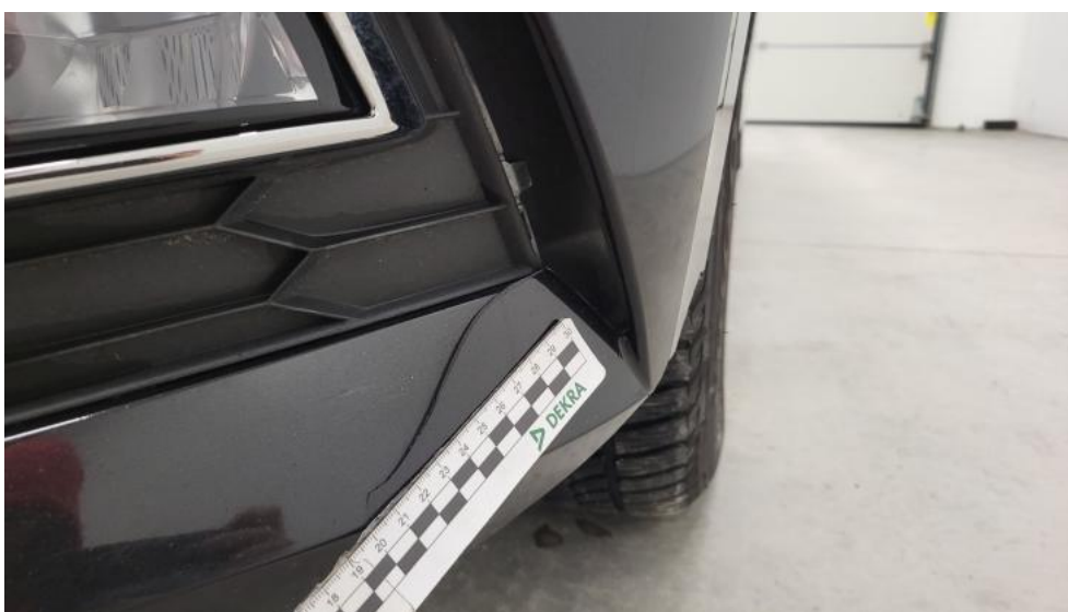
Fot. 42. Zderzak - Pęknięcie/rozerwanie 1
