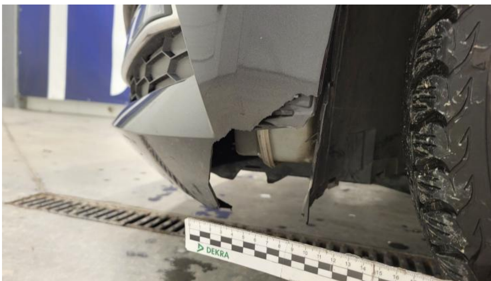
Fot. 43. Zderzak - Pęknięcie/rozerwanie 2
