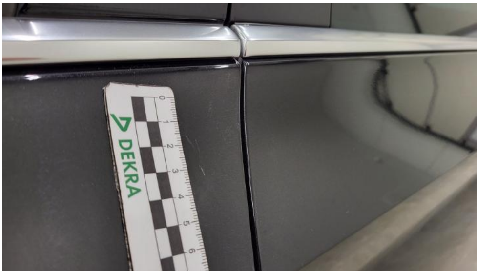
Fot. 45. Drzwi przed L - Rysa/odprysk 1
