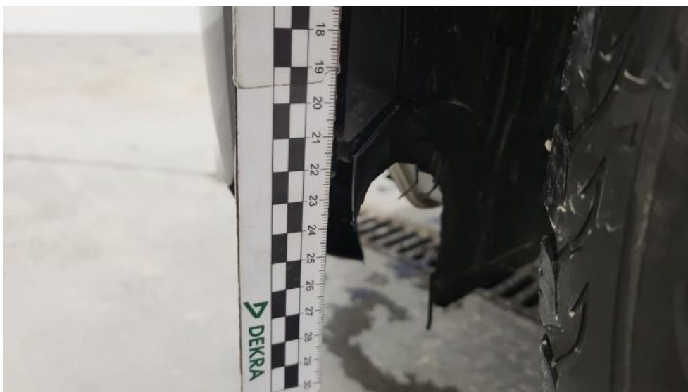
Fot. 46. Nadkole przednie L - Pęknięcie/rozerwanie 1
