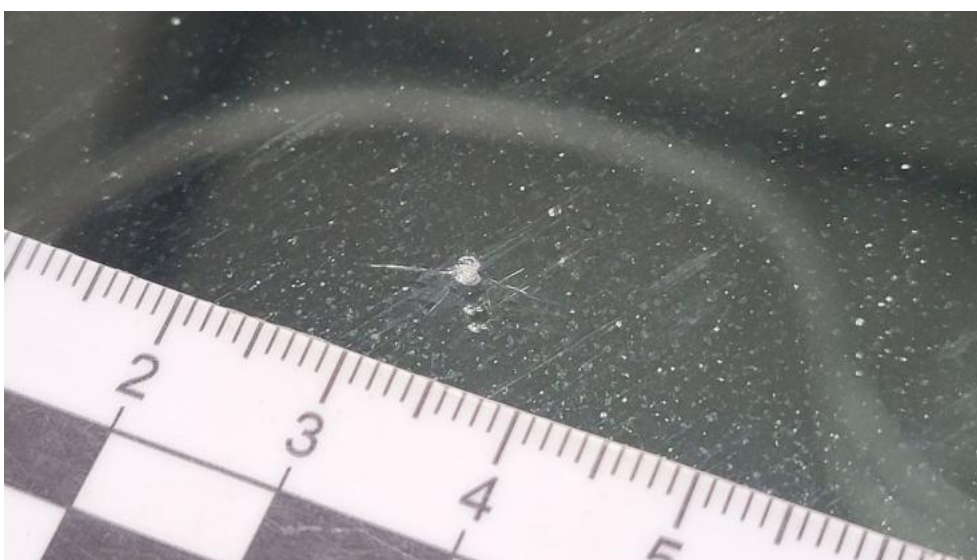
Fot. 40. Szyba czołowa - Pęknięcie/rozerwanie 1
