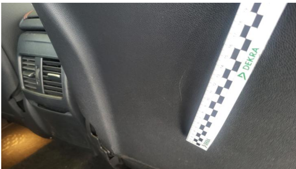
Fot. 82. Fotel prz. praw. - Rysa/odprysk 1
