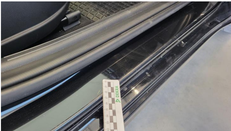
Fot. 45. Próg P - Rysa/odprysk 1
