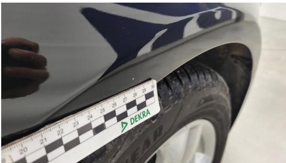
Fot. 38. Błotnik przedni P - Rysa/odprysk 1
