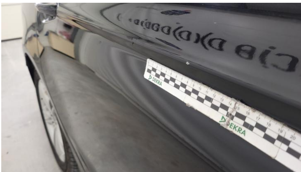
Fot. 42. Drzwi tylne P - Rysa/odprysk 1
