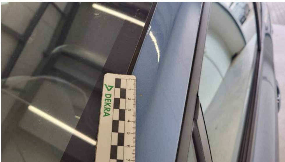
Fot. 54. Słupek przedni L - Rysa/odprysk 1
