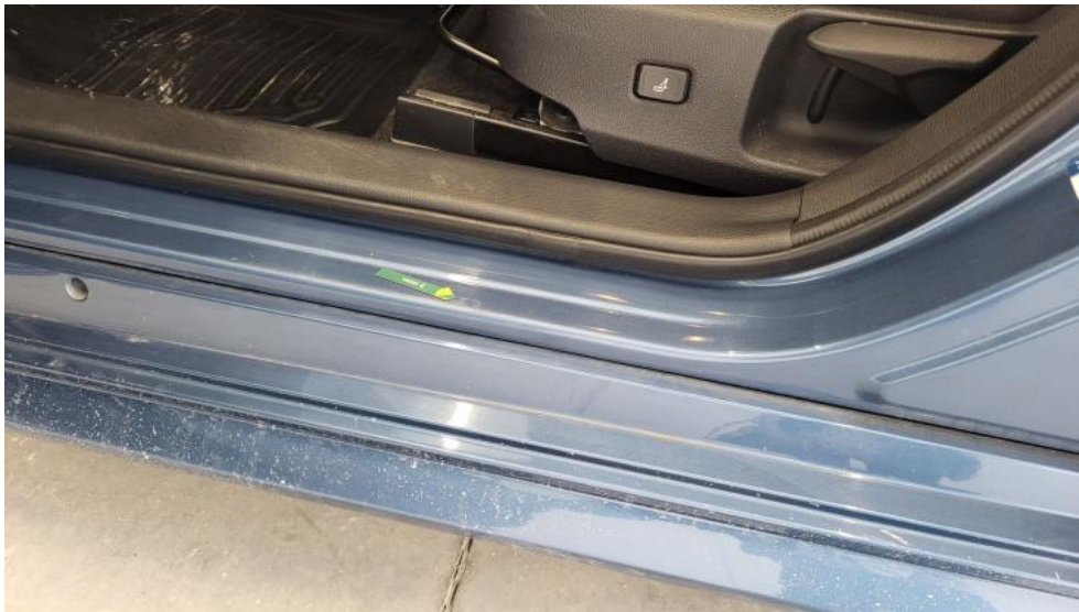
Fot. 53. Próg L - Wgniecenie/odkształcenie 1
