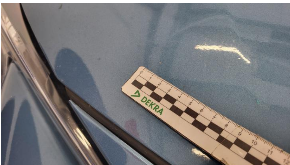
Fot. 38. Pokrywa komory silnika - Rysa/odprysk 1
