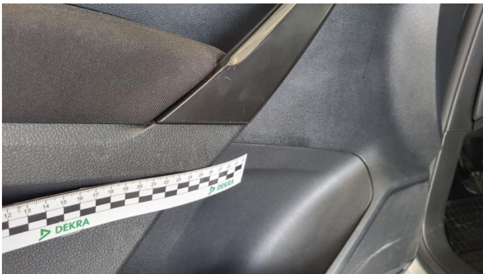
Photo 78. Tapicerka drzwi przednich L - Rysa/odprysk 1
