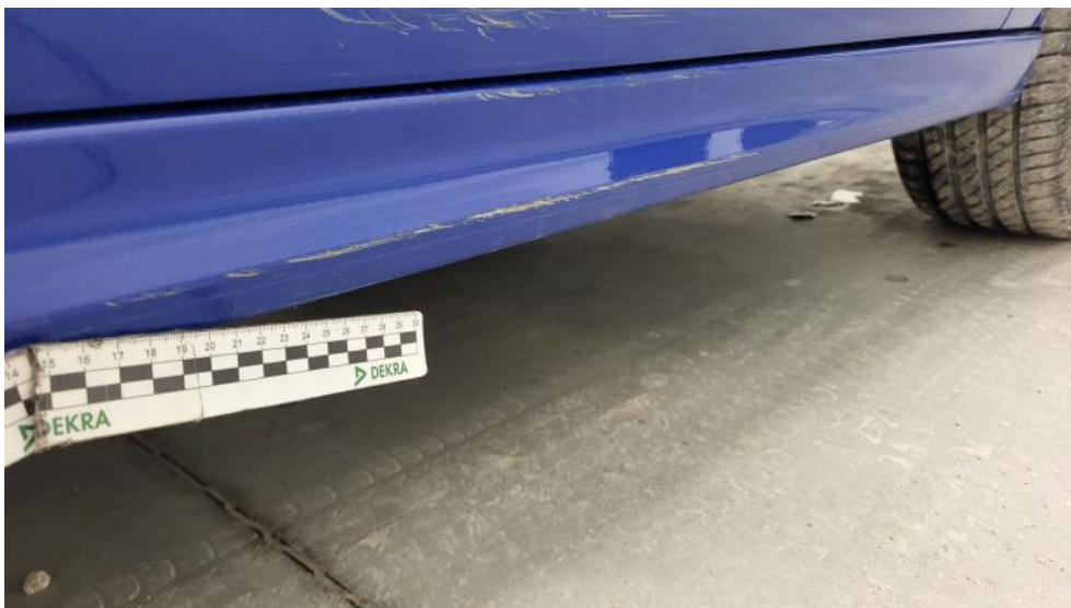
Photo 52. Próg P - Rysa/odprysk 2
