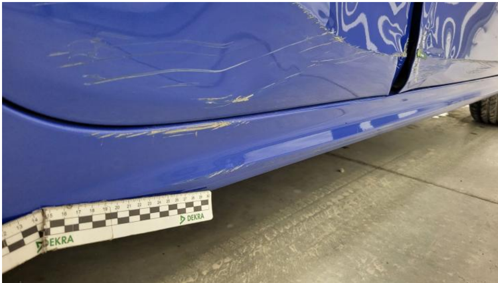
Photo 51. Próg P - Rysa/odprysk 1
