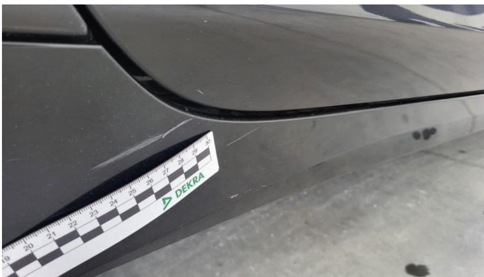
Fot. 51. Próg P - Rysa/odprysk 1
