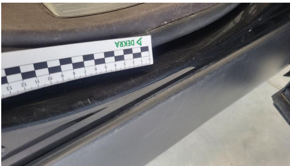
Fot. 59. Próg P - Rysa/odprysk 1
