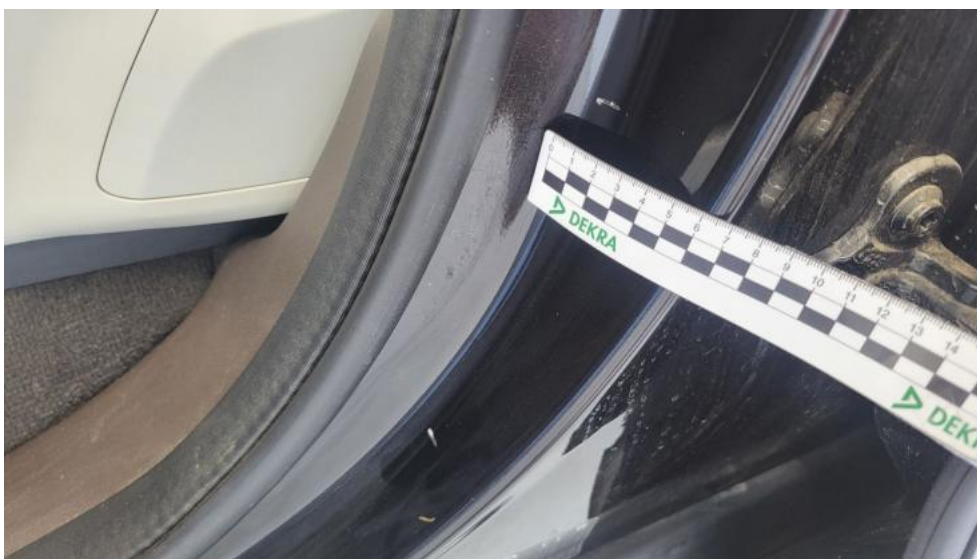
Fot. 83. Słupek środkowy L - Rysa/odprysk 1
