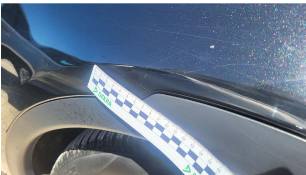
Fot. 46. Błotnik przedni P - Rysa/odprysk 1
