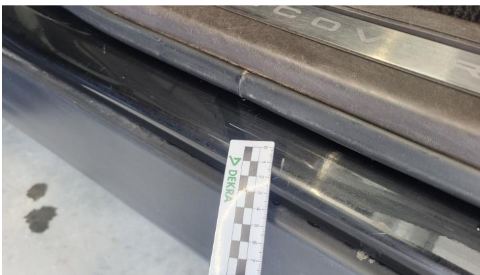
Fot. 82. Próg L - Rysa/odprysk 1
