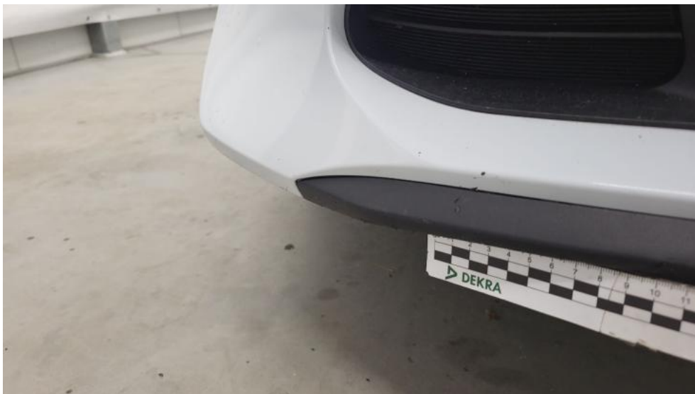
Fot. 33. Zderzak - Rysa/odprysk 1
