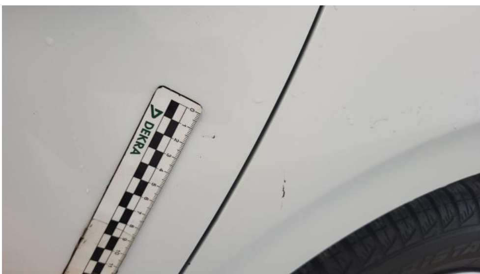
Fot. 48. Drzwi tylne L - Rysa/odprysk 1
