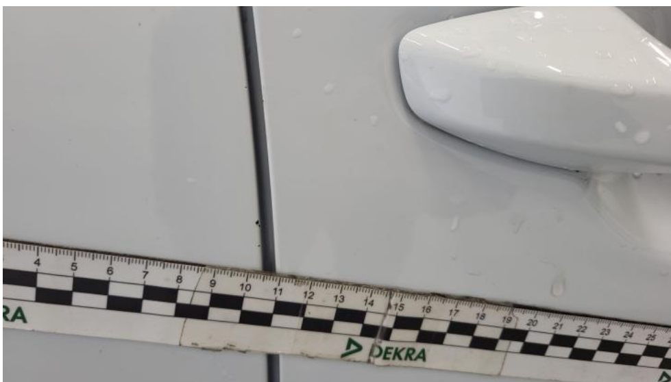
Fot. 36. Drzwi tylne P() - Rysa/odprysk 3
