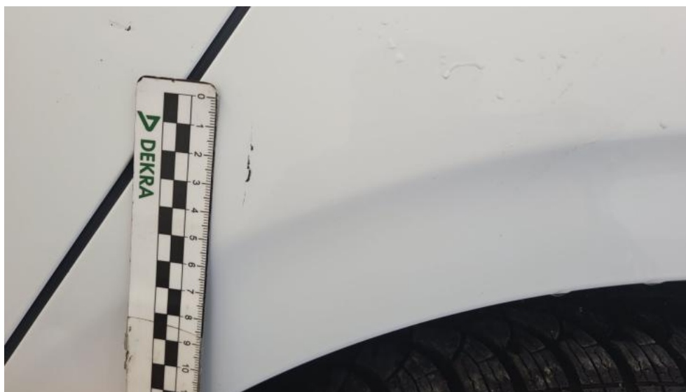
Fot. 45. Błotnik tylny L / Ściana boczna L() - Rysa/odprysk 3
