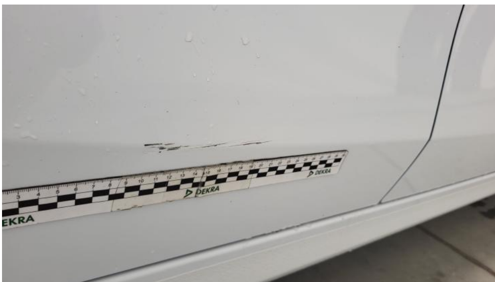
Fot. 34. Drzwi tylne P - Rysa/odprysk 1
