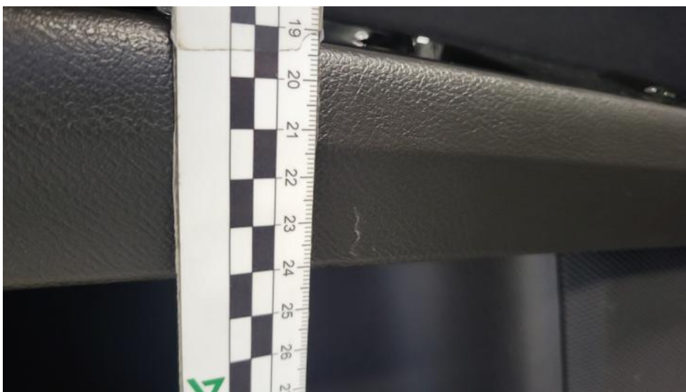
Photo 87. Tapicerka drzwi tylnych L - Rysa/odprysk 1
