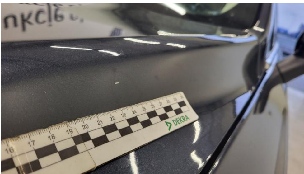
Photo 45. Pokrywa komory silnika - Rysa/odprysk 1
