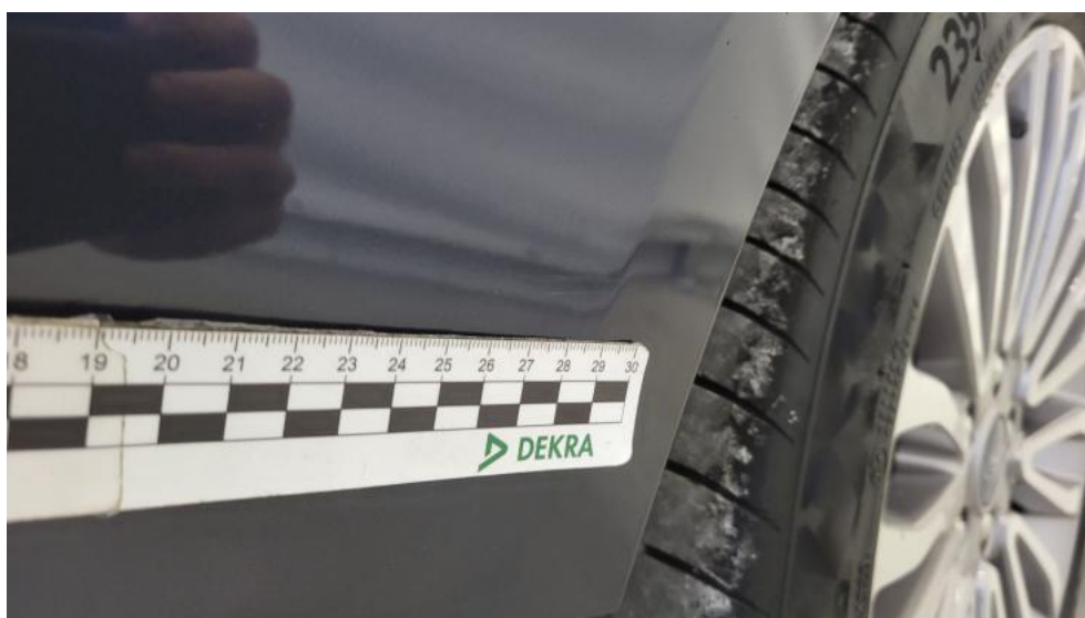
Photo 66. Zderzak tylny - Rysa/odprysk 2
