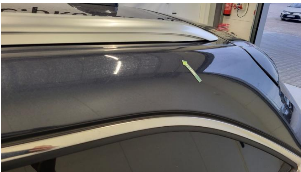
Photo 70. Błotnik tylny L / Ściana boczna L - Wgniecenie/odkształcenie 2
