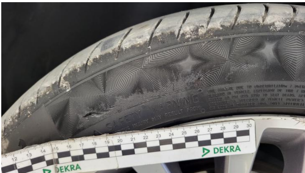
Photo 86. Opona przednia L - Pęknięcie/rozerwanie 2
