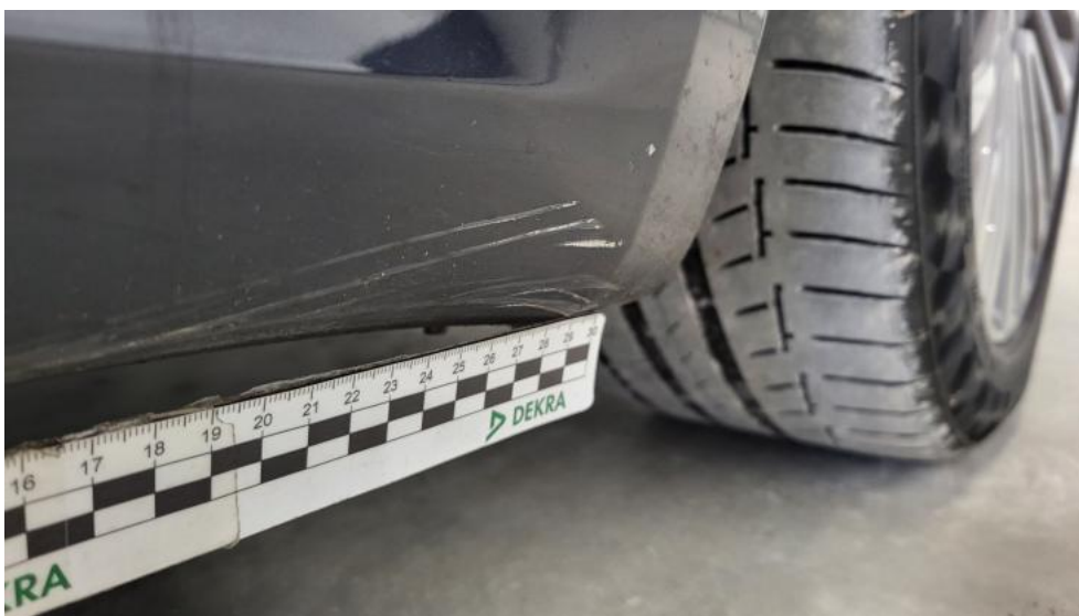
Photo 58. Próg P - Rysa/odprysk 2
