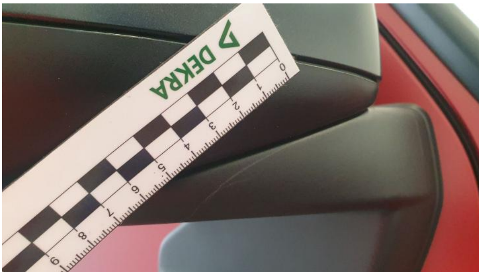
Fot. 63. Lusterko zew P - Rysa/odprysk 1
