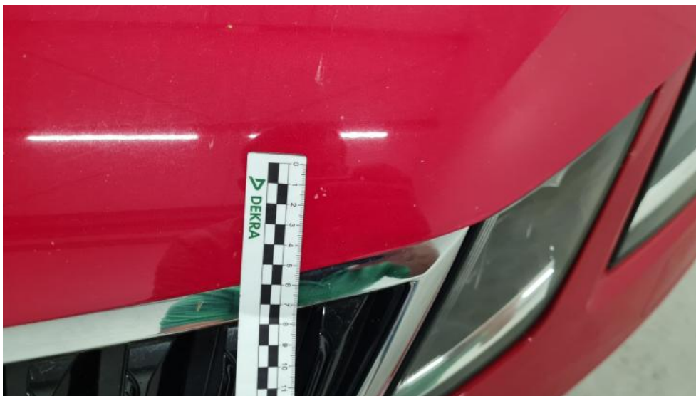
Fot. 35. Pokrywa komory silnika - Rysa/odprysk 1
