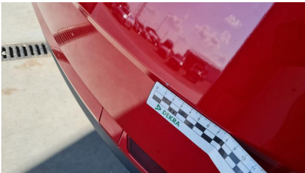
Fot. 39. Zderzak tylny - Rysa/odprysk 1
