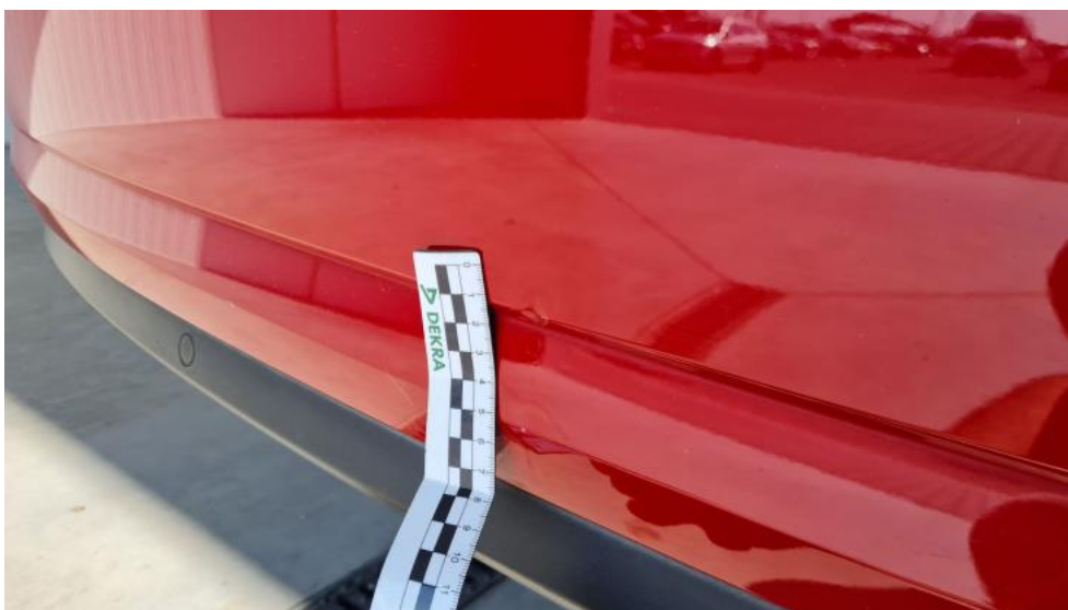
Fot. 40. Zderzak tylny - Wgniecenie/odkształcenie 1
