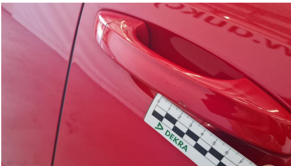
Fot. 36. Klamka drzwi prz P - Rysa/odprysk 1
