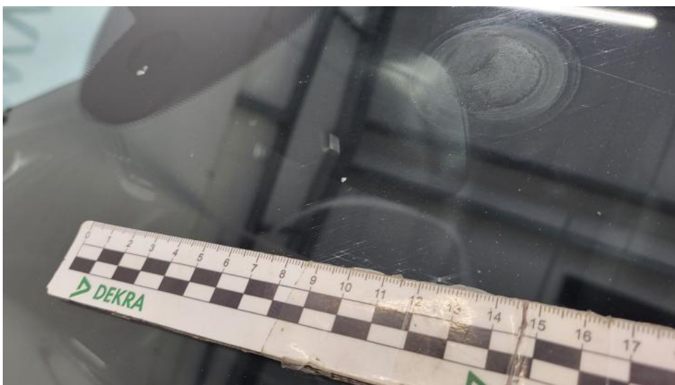
Photo 50. Szyba czołowa - Rysa/odprysk 2
