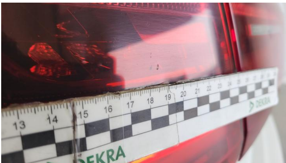
Photo 64. Lampa tylna zew L - Rysa/odprysk 1
