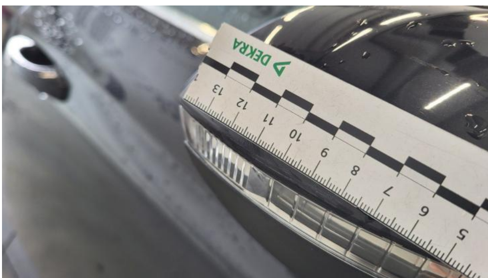
Fot. 44. Lusterko zew P - Rysa/odprysk 1
