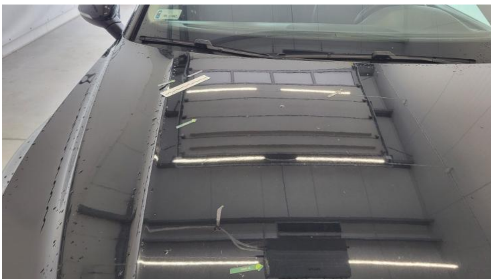
Fot. 38. Pokrywa komory silnika - Wgniecenie/odkształcenie 1
