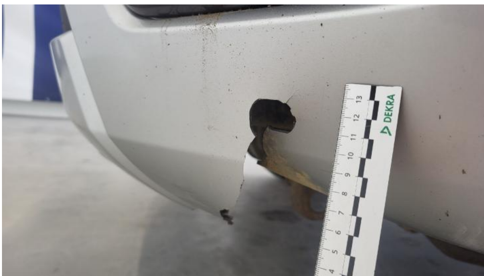
Fot. 56. Zderzak przedni cz L - Pęknięcie/rozerwanie 1
