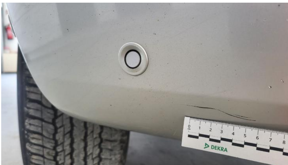
Fot. 57. Zderzak przedni cz P - Rysa/odprysk 1
