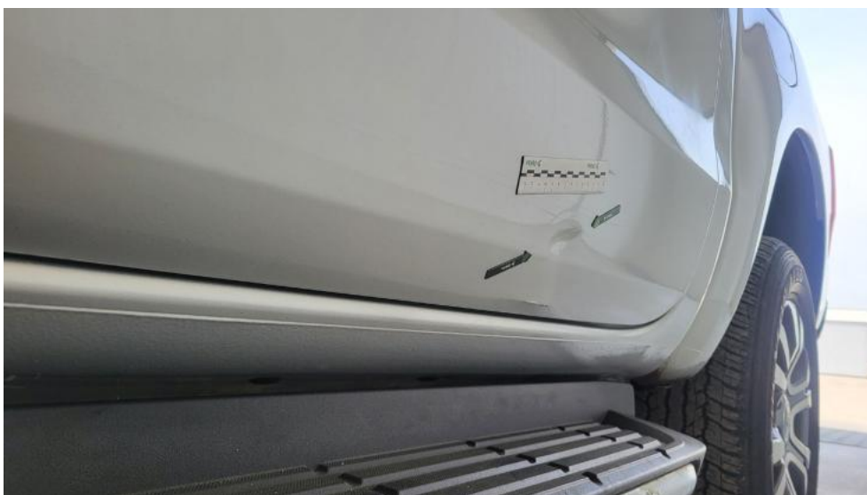
Fot. 86. Drzwi tylne L - Wgniecenie/odkształcenie 1
