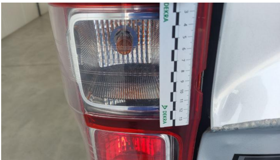
Fot. 81. Lampa zespolona tylna L - Pęknięcie/rozerwanie 1
