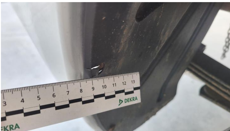
Fot. 72. Nadkole tylne P - Pęknięcie/rozerwanie 1
