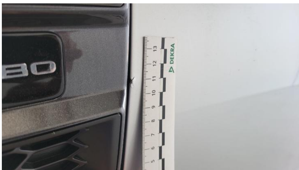
Fot. 84. Drzwi przed L - Pęknięcie/rozerwanie 1
