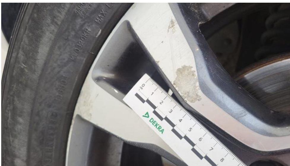
Fot. 90. Felga Aluminiowa przedni L - Rysa/odprysk 1
