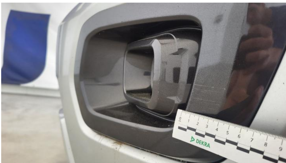
Fot. 49. Kratka/zaślepka halogenu L - Rysa/odprysk 1
