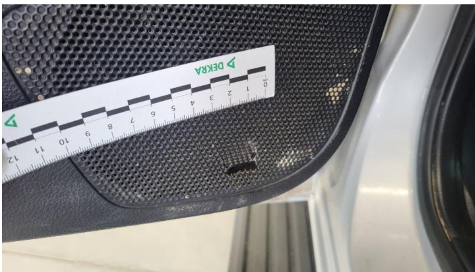
Fot. 95. Tapicerka drzwi tylnych L - Pęknięcie/rozerwanie 1
