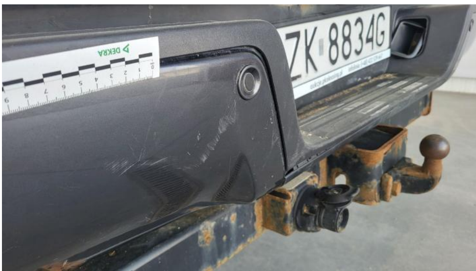
Fot. 76. Zderzak tylny - Rysa/odprysk 1
