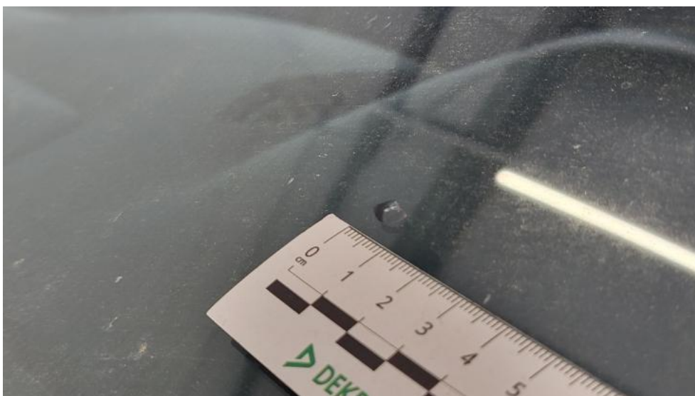
Fot. 52. Szyba czołowa - Pęknięcie/rozerwanie 1
