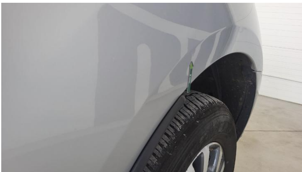
Fot. 59. Błotnik przedni P - Wgniecenie/odkształcenie 1
