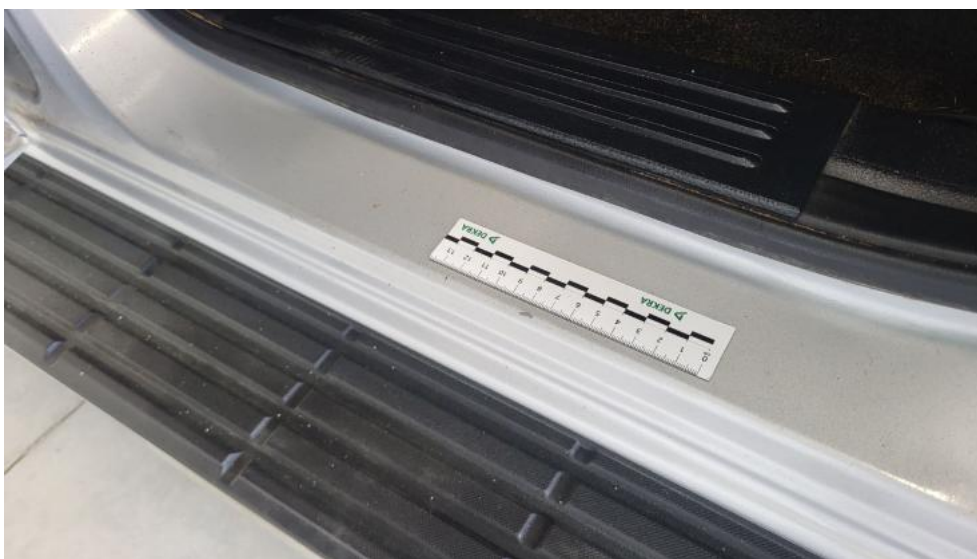
Fot. 87. Próg L - Rysa/odprysk 1
