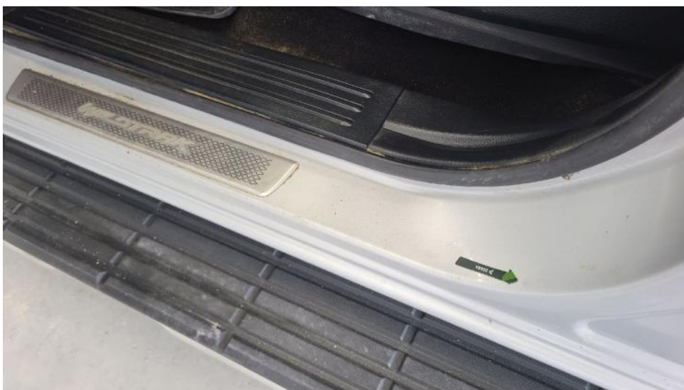
Fot. 88. Próg L - Wgniecenie/odkształcenie 1
