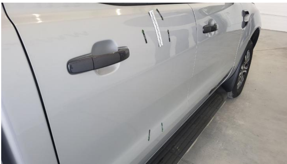
Fot. 63. Drzwi tylne P - Wgniecenie/odkształcenie 1
