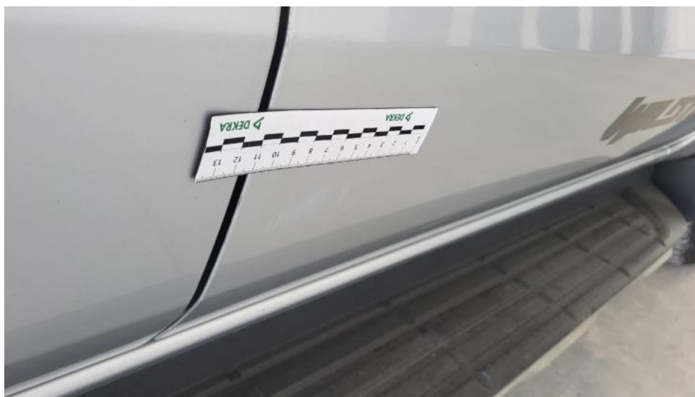
Fot. 61. Drzwi przednie P - Rysa/odprysk 1
