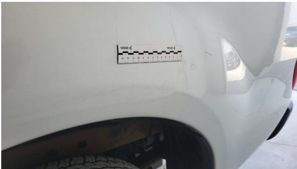
Fot. 79. Błotnik tylny L / Ściana boczna L - Rysa/odprysk 2
