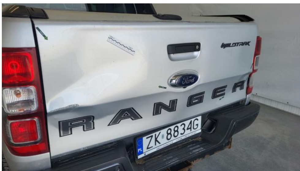
Fot. 74. Pokrywy bagażnika - Wgniecenie/odkształcenie 1
