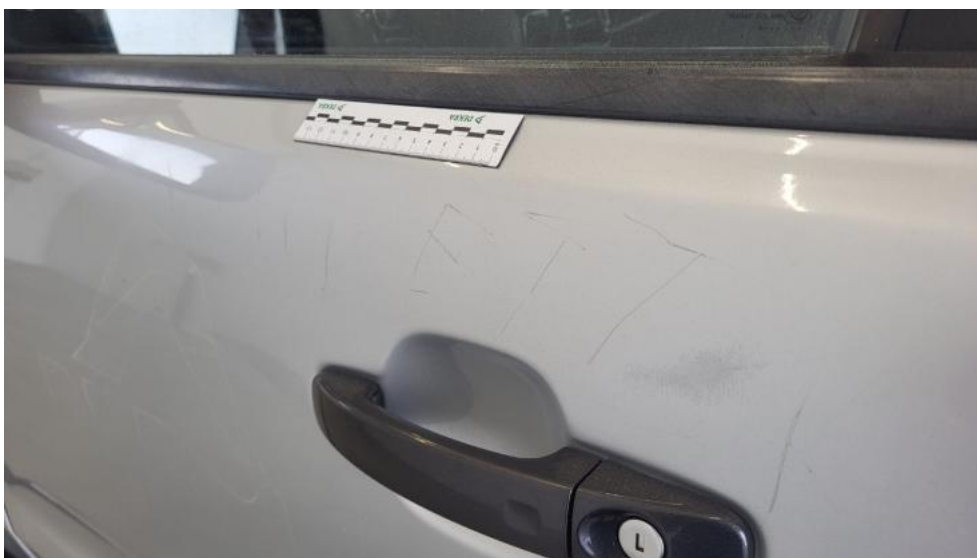
Fot. 82. Drzwi przed L - Rysa/odprysk 1
