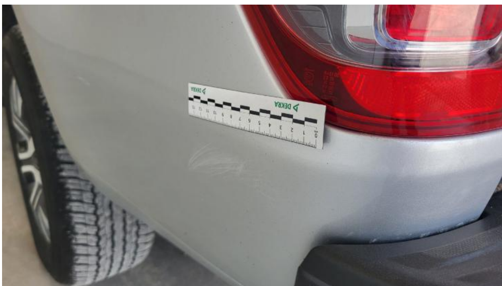
Fot. 78. Błotnik tylny L / Ściana boczna L - Rysa/odprysk 1
