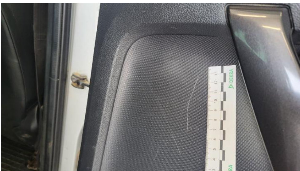
Fot. 96. Tapicerka drzwi tylnych P - Rysa/odprysk 1
