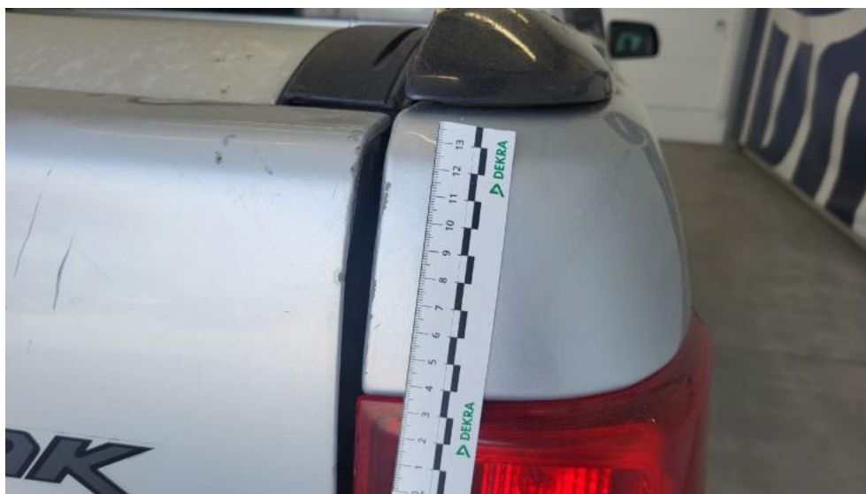
Fot. 67. Błotnik tylny P / Ściana boczna P - Rysa/odprysk 1
