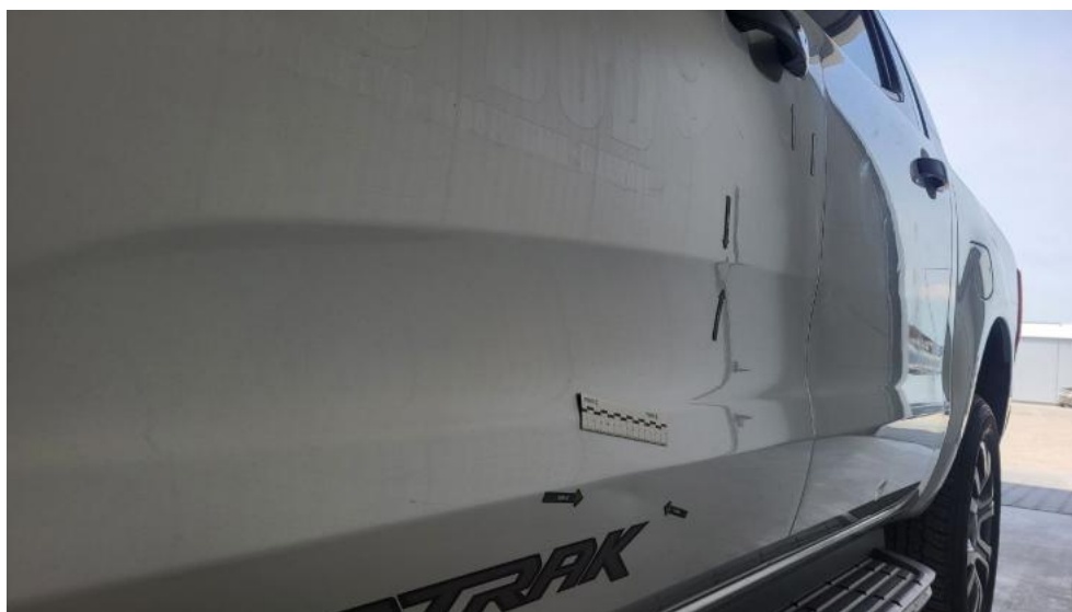
Fot. 83. Drzwi przed L - Wgniecenie/odkształcenie 1
