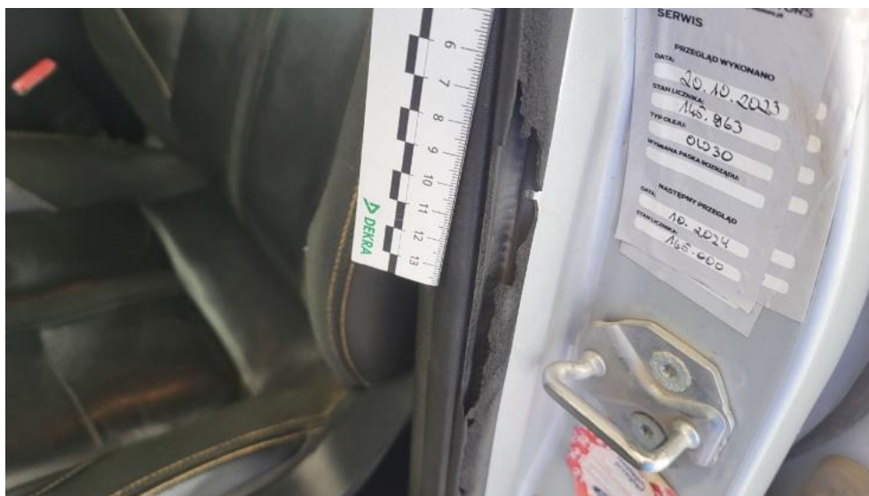
Fot. 97. Uszczelka drzwi przednich L - Pęknięcie/rozerwanie 1
