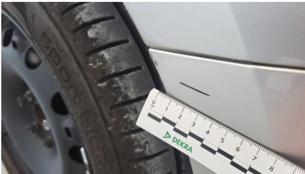
Fot. 45. Zderzak - Rysa/odprysk 2
