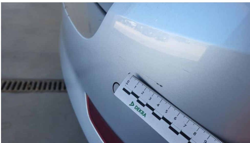
Fot. 59. Zderzak tylny - Rysa/odprysk 1
