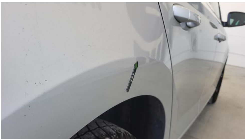
Fot. 56. Błotnik tylny P / Ściana boczna P - Wgniecenie/odkształcenie 2
