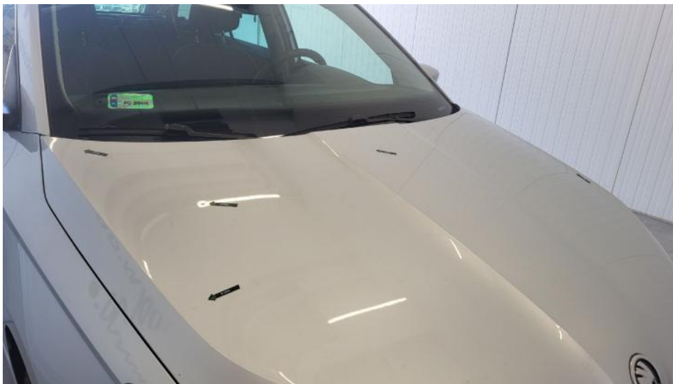
Fot. 41. Pokrywa komory silnika - Wgniecenie/odkształcenie 1
