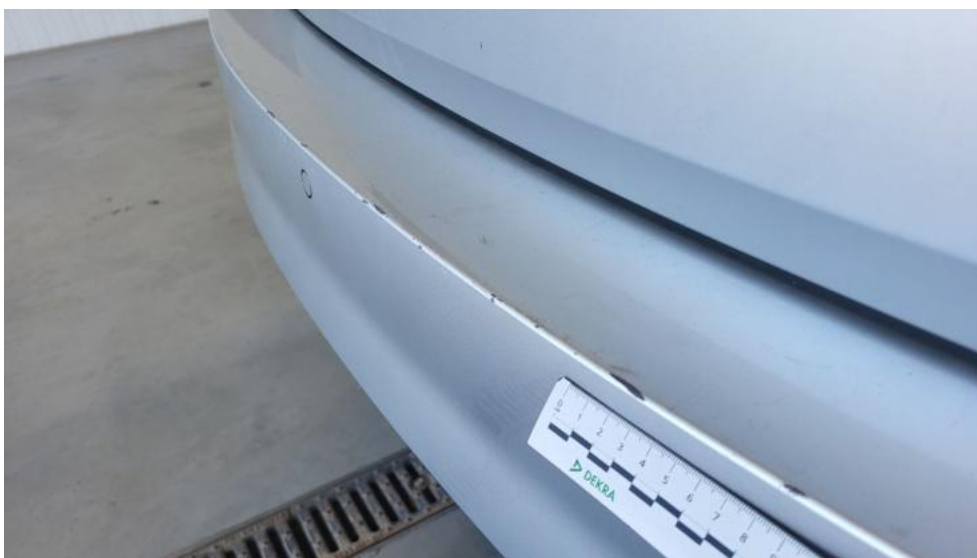
Fot. 60. Zderzak tylny - Rysa/odprysk 2
