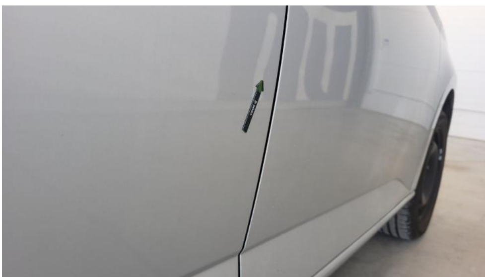
Fot. 50. Drzwi tylne P - Wgniecenie/odkształcenie 1
