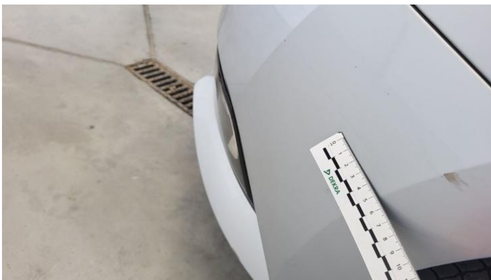
Fot. 44. Zderzak - Rysa/odprysk 1
