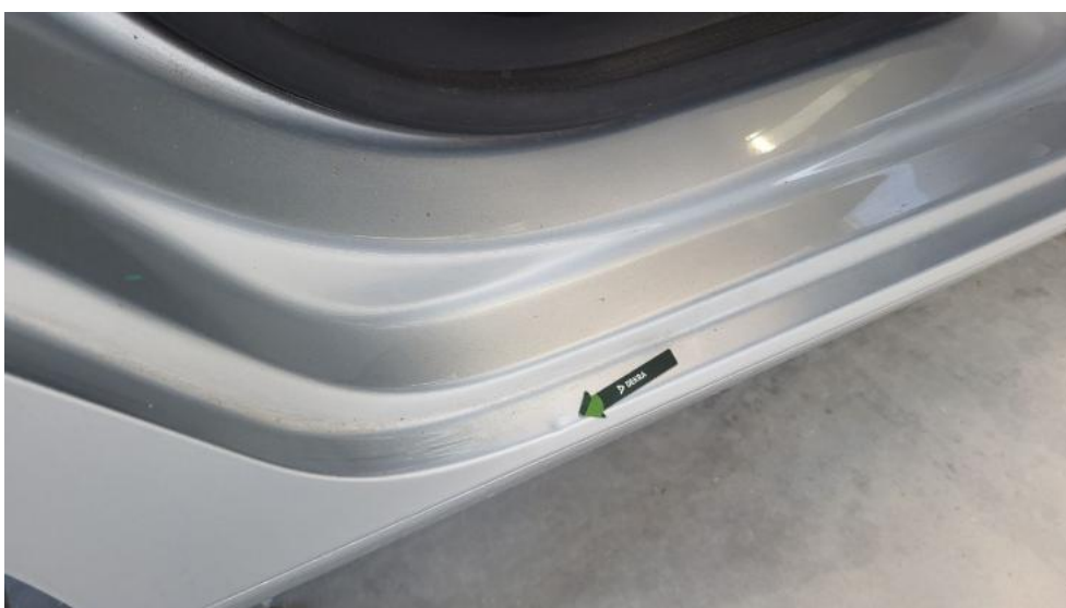
Fot. 52. Próg P - Wgniecenie/odkształcenie 2
