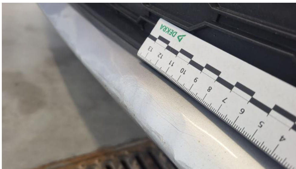
Fot. 47. Zderzak - Pęknięcie/rozerwanie 1
