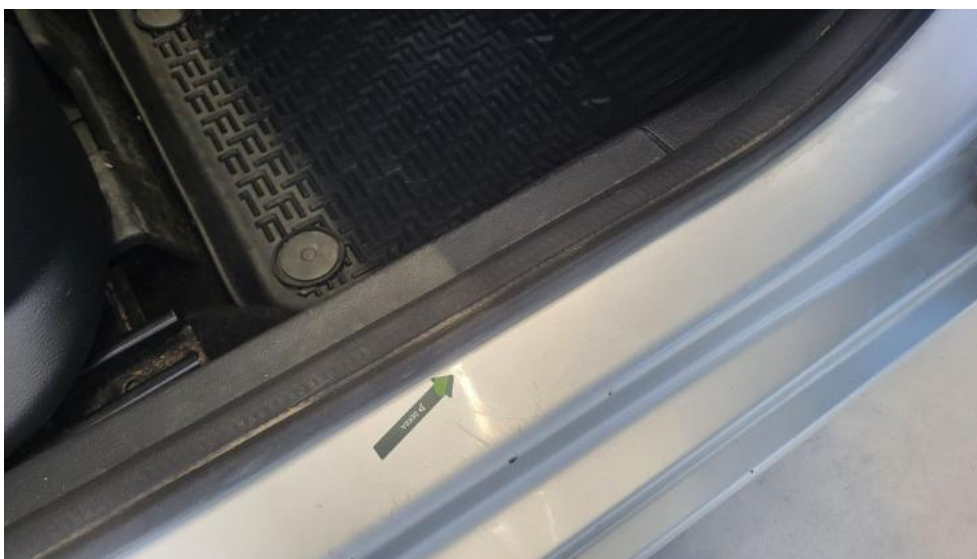
Fot. 51. Próg P - Wgniecenie/odkształcenie 1
