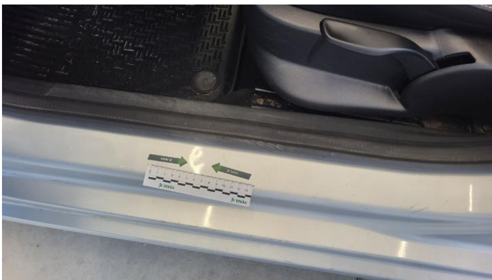
Fot. 67. Próg L - Wgniecenie/odkształcenie 1
