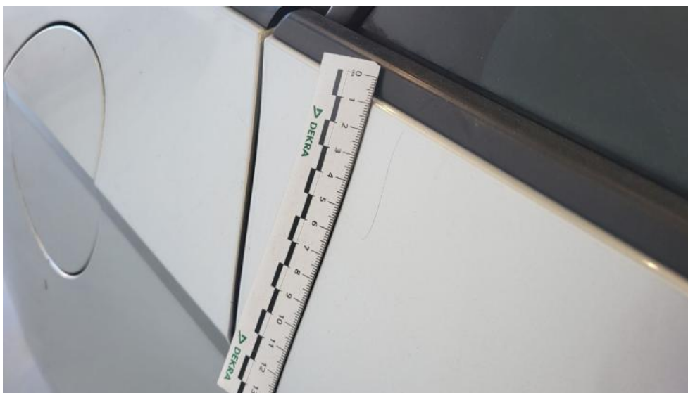
Fot. 49. Drzwi tylne P - Rysa/odprysk 1
