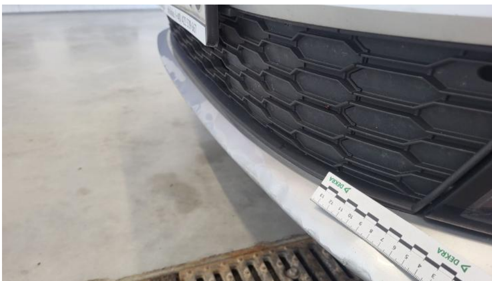
Fot. 46. Zderzak - Wgniecenie/odkształcenie 1
