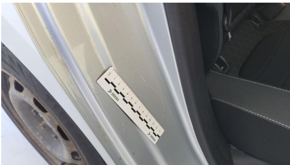
Fot. 54. Błotnik tylny P / Ściana boczna P - Rysa/odprysk 1
