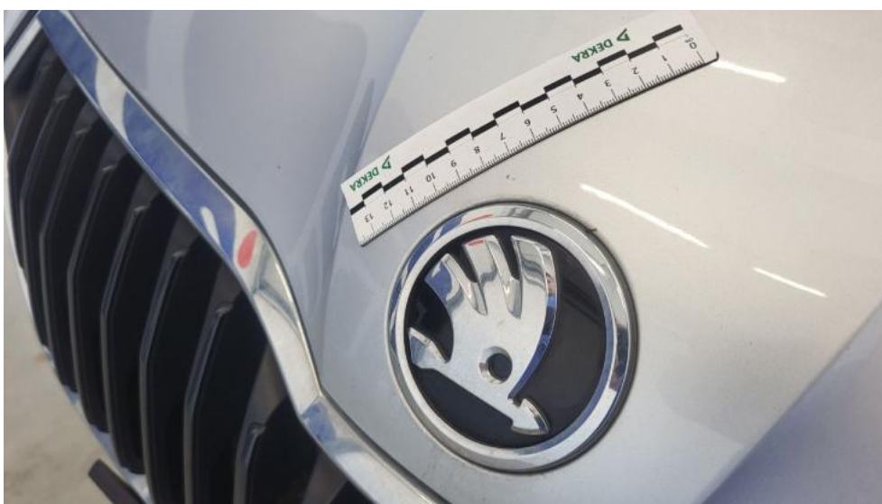
Fot. 40. Pokrywa komory silnika - Rysa/odprysk 1
