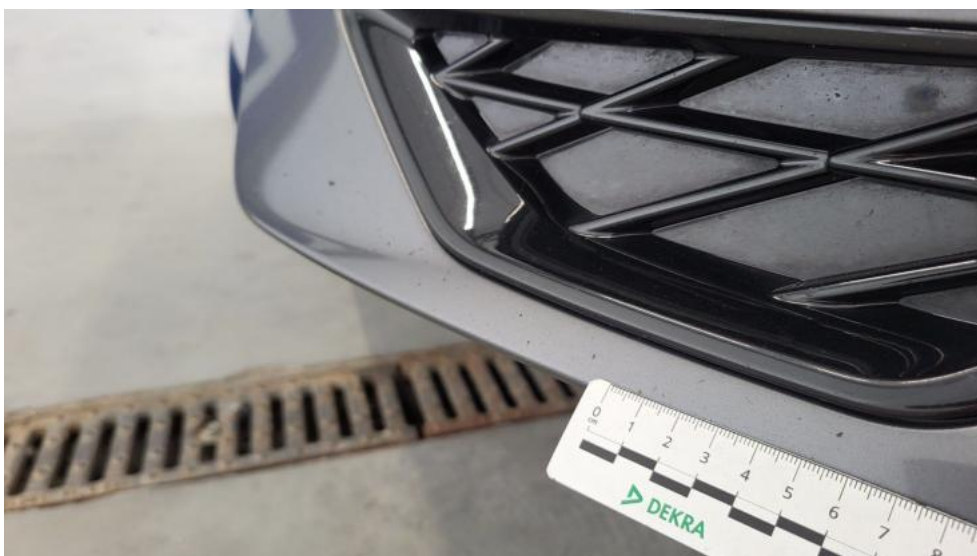
Fot. 44. Zderzak przedni cz L - Rysa/odprysk 1
