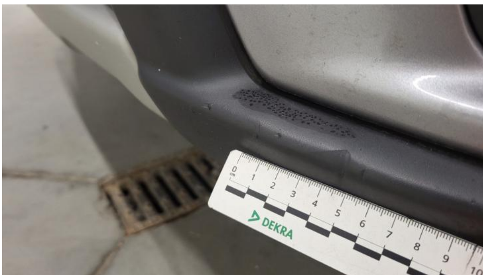
Photo 56. Zderzak przedni cz dolna - Wgniecenie/odkształcenie 1
