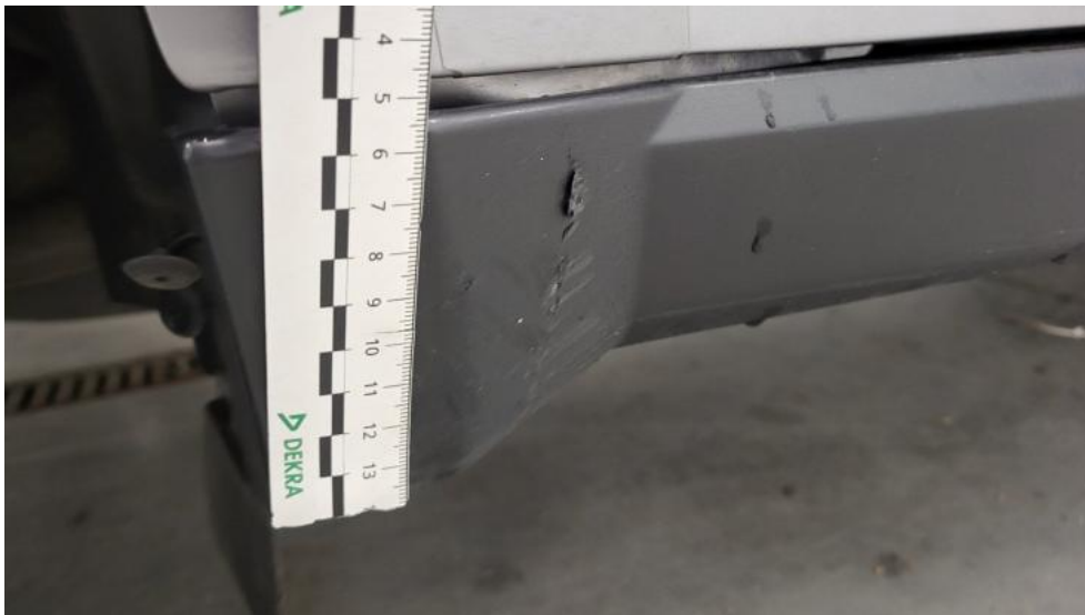
Photo 69. Próg P - Rysa/odprysk 1
