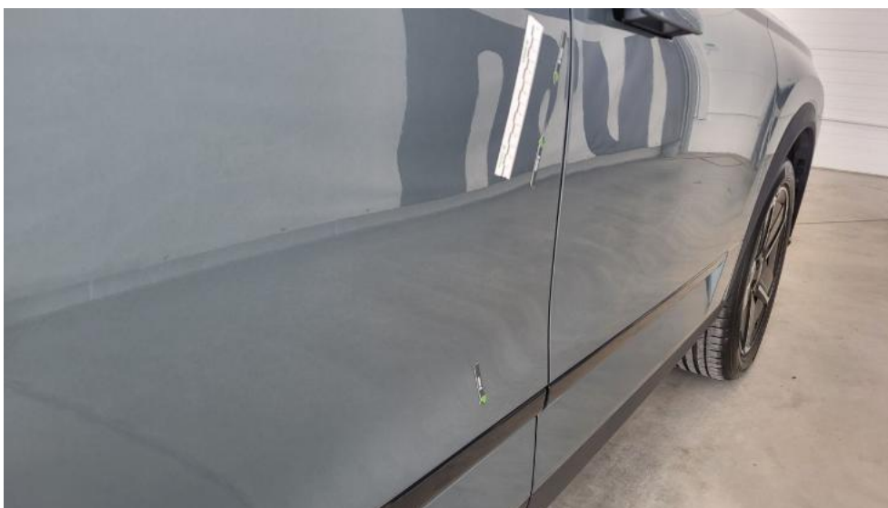
Photo 51. Drzwi tylne P - Wgniecenie/odkształcenie 1
