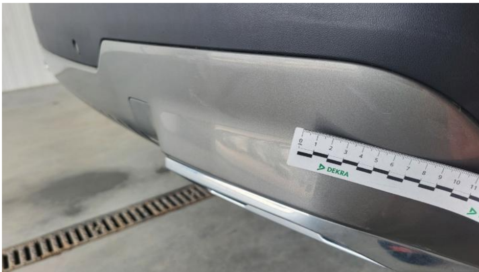
Photo 55. Spojler zderzaka tylnego - Rysa/odprysk 1
