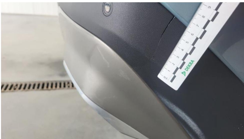
Photo 59. Zderzak tylny cz dolna - Pęknięcie/rozerwanie 1
