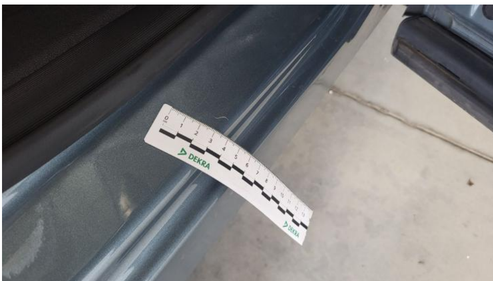
Photo 52. Próg P - Rysa/odprysk 1
