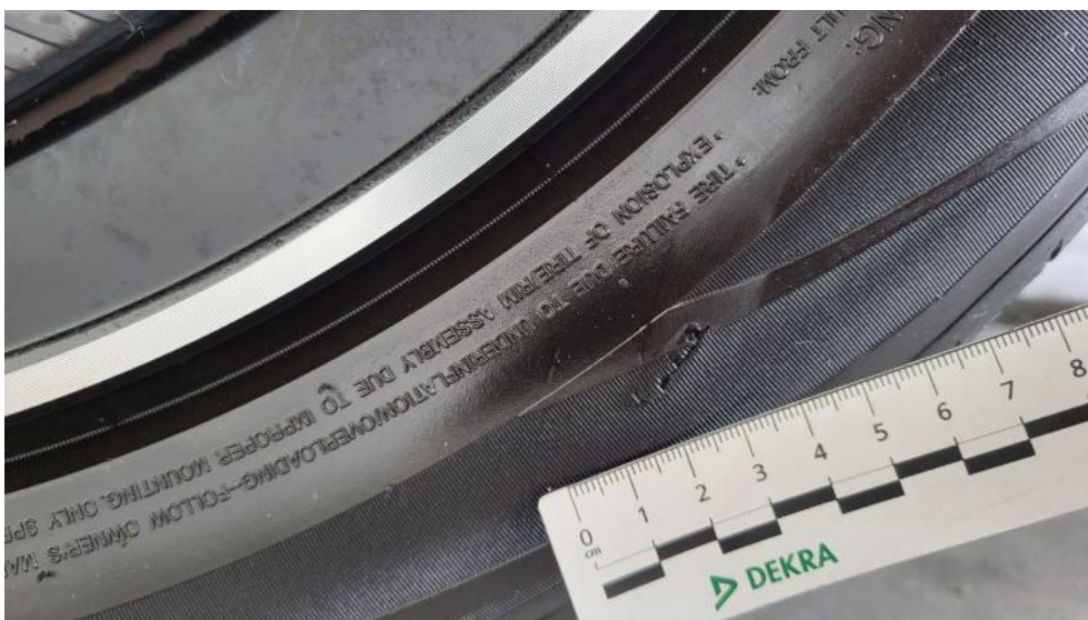
Photo 66. Opona przednia L - Pęknięcie/rozerwanie 1
