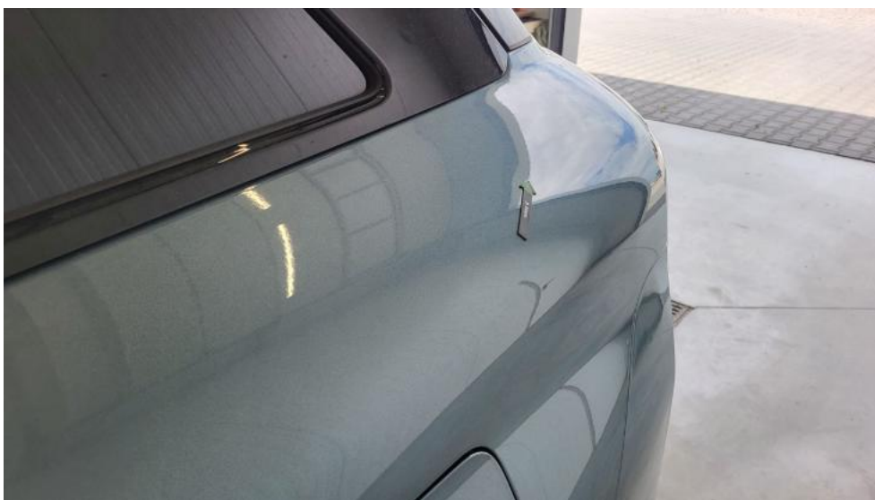
Photo 60. Błotnik tylny L / Ściana boczna L - Wgniecenie/odkształcenie 1
