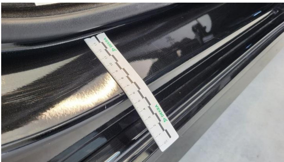
Photo 64. Próg P - Rysa/odprysk 1
