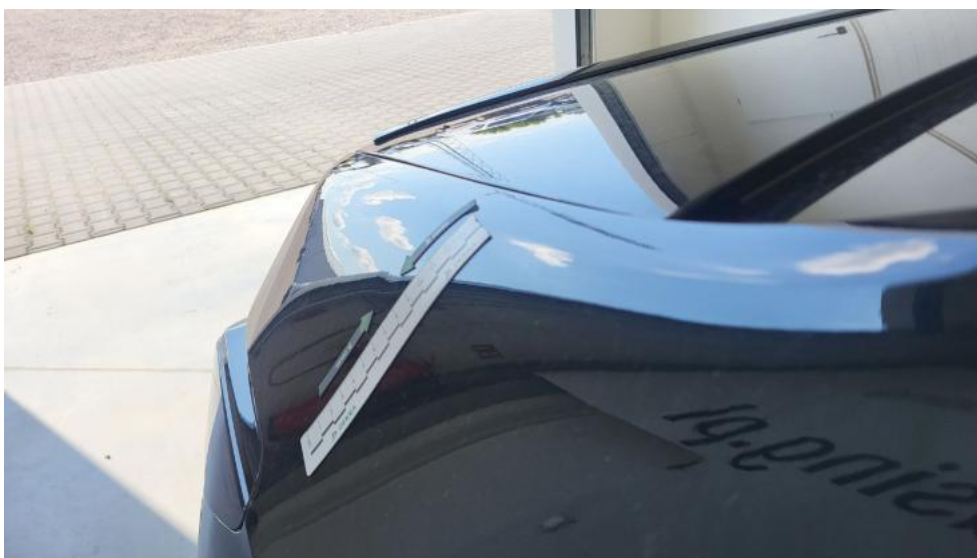
Photo 66. Błotnik tylny P / Ściana boczna P - Wgniecenie/odkształcenie 2
