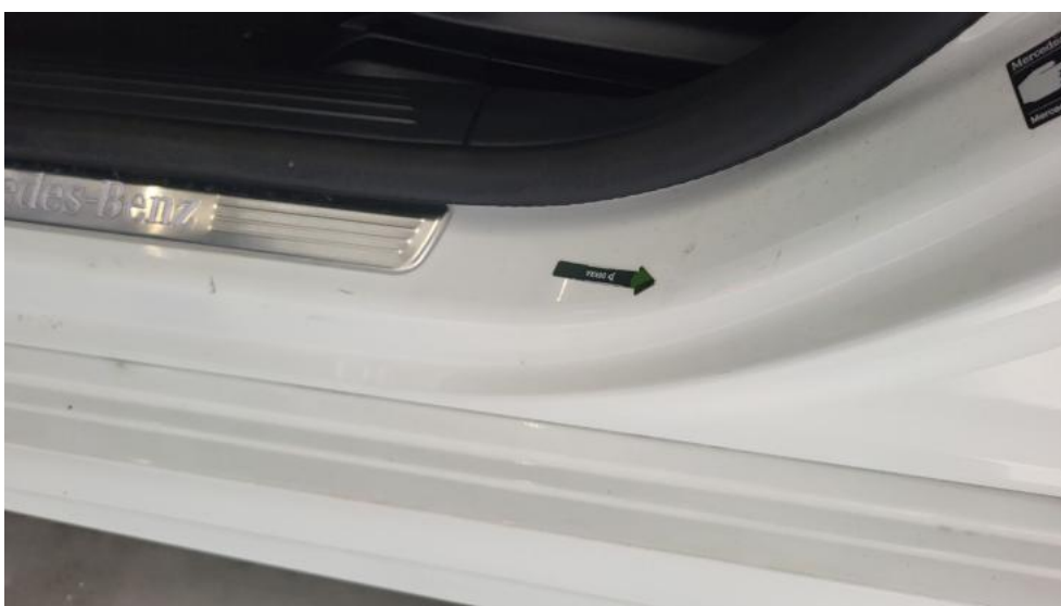
Fot. 74. Próg L - Wgniecenie/odkształcenie 1
