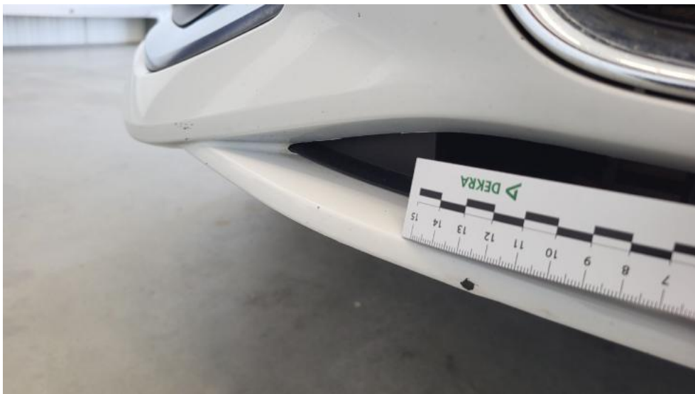
Fot. 45. Zderzak - Rysa/odprysk 2
