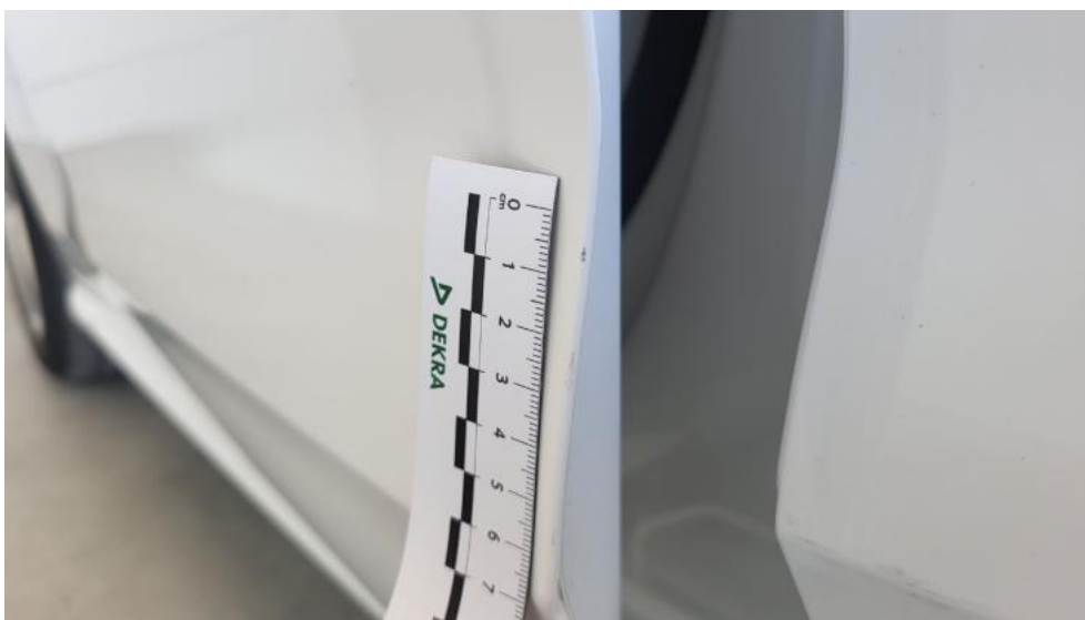
Fot. 67. Drzwi przed L - Rysa/odprysk 1
