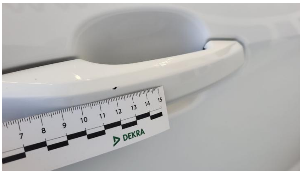
Fot. 53. Klamka drzwi prz P - Rysa/odprysk 1
