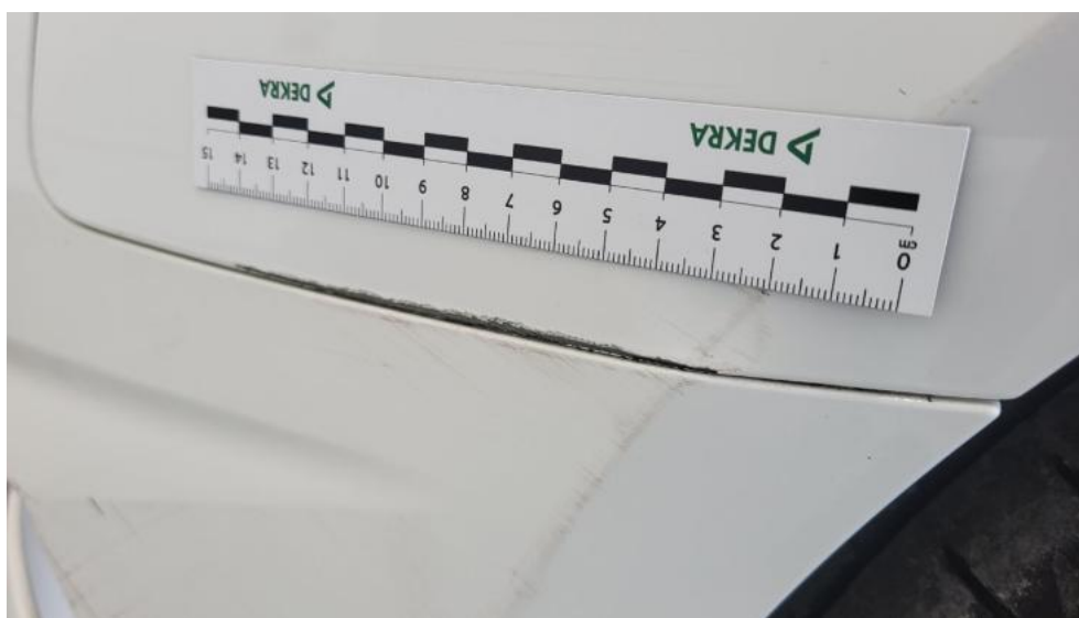
Fot. 73. Błotnik przedni L - Rysa/odprysk 1
