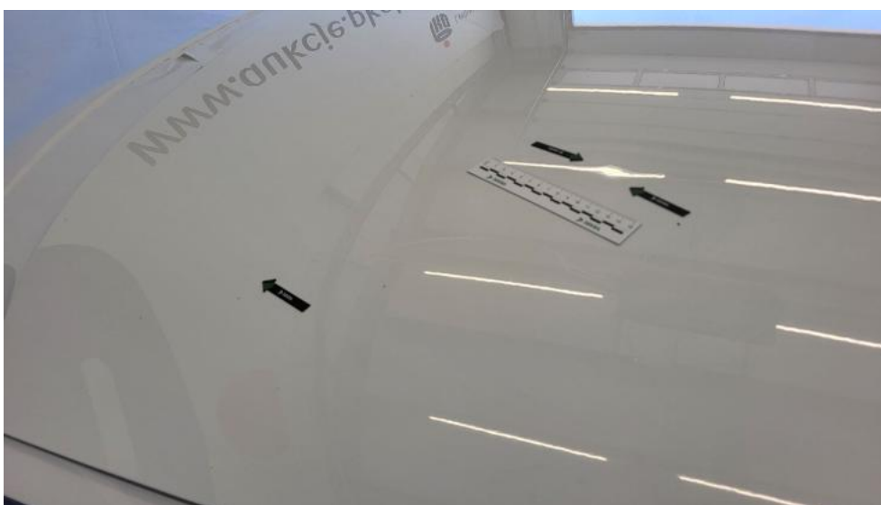
Fot. 42. Pokrywa komory silnika - Wgniecenie/odkształcenie 1
