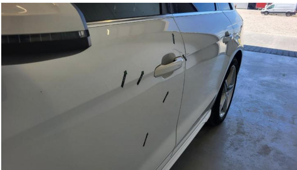
Fot. 68. Drzwi przed L - Wgniecenie/odkształcenie 1
