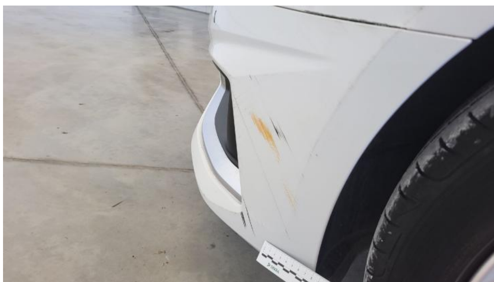
Fot. 44. Zderzak - Rysa/odprysk 1
