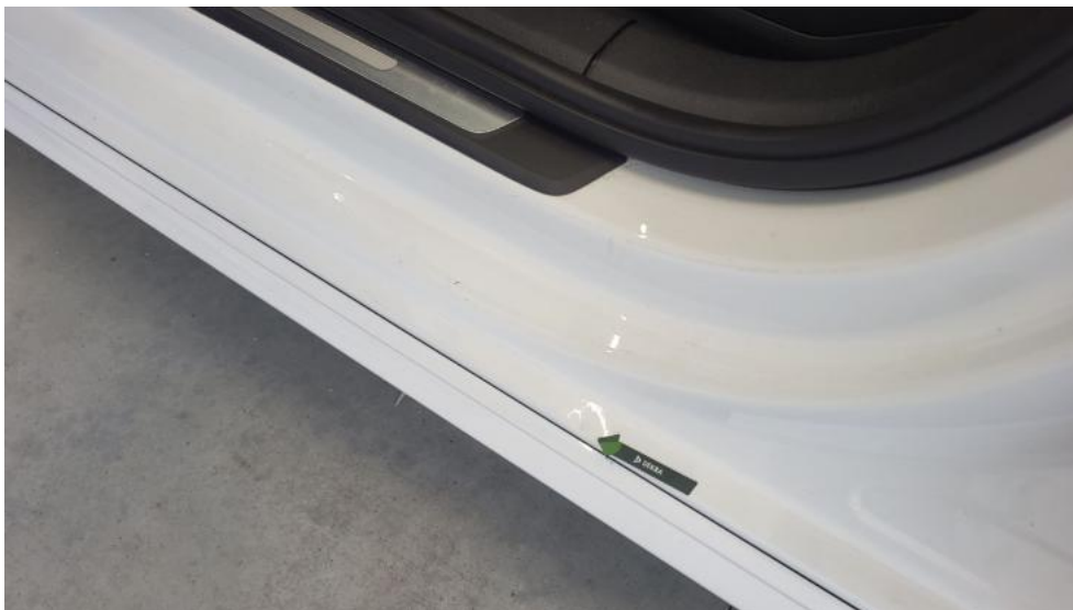
Fot. 71. Próg L - Wgniecenie/odkształcenie 1
