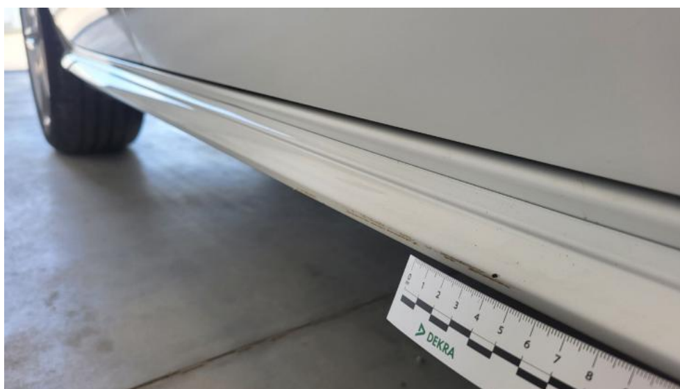
Fot. 54. Próg P - Rysa/odprysk 1
