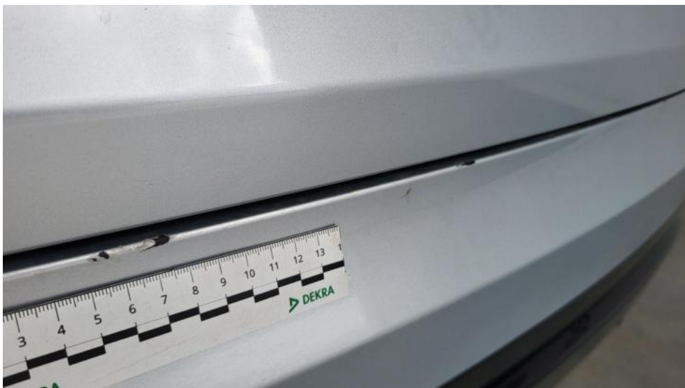
Fot. 56. Zderzak tylny - Rysa/odprysk 1
