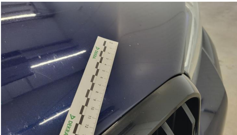
Fot. 46. Pokrywa komory silnika - Rysa/odprysk 1
