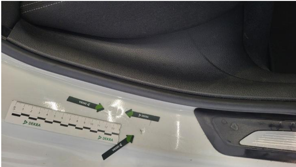
Fot. 53. Próg P - Wgniecenie/odkształcenie 1
