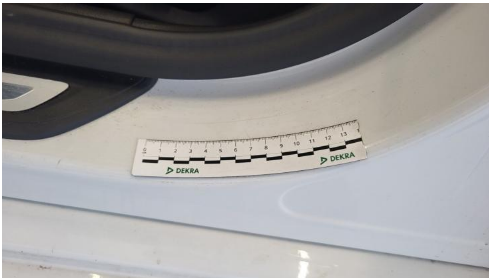
Fot. 75. Próg L - Rysa/odprysk 1
