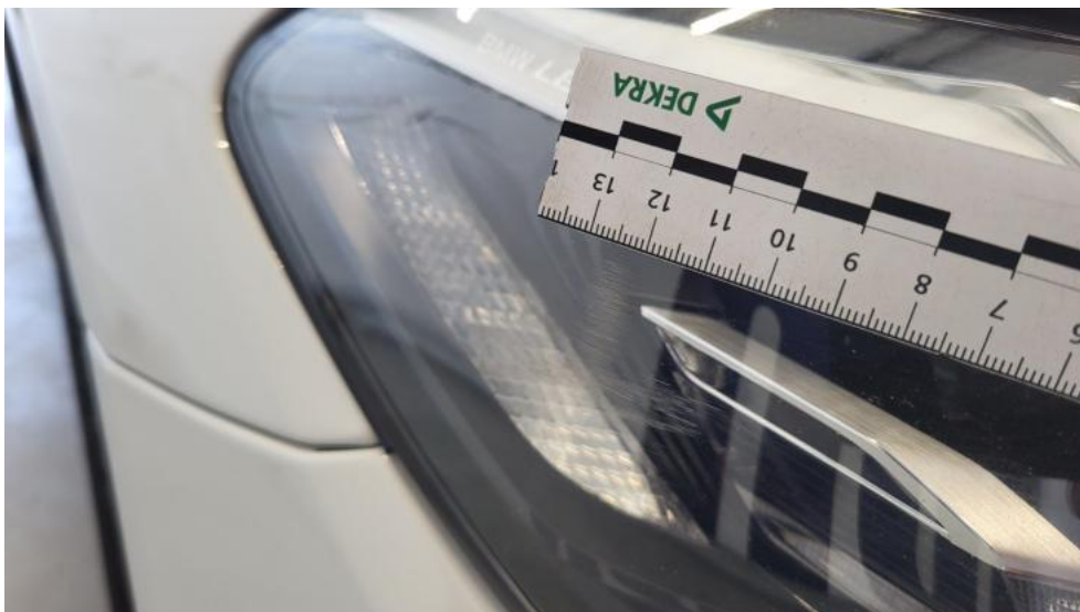
Fot. 51. Reflektor P - Rysa/odprysk 1
