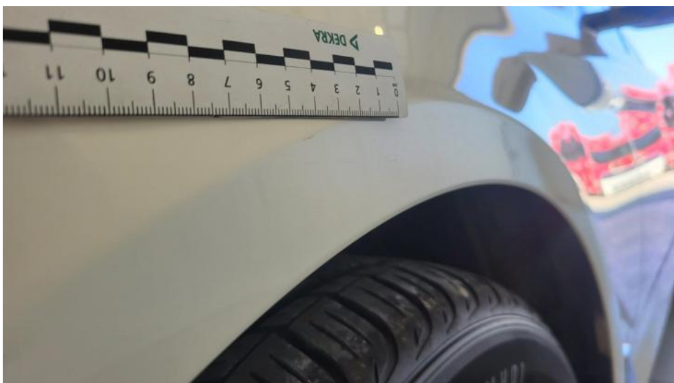
Fot. 76. Błotnik przedni L - Rysa/odprysk 1
