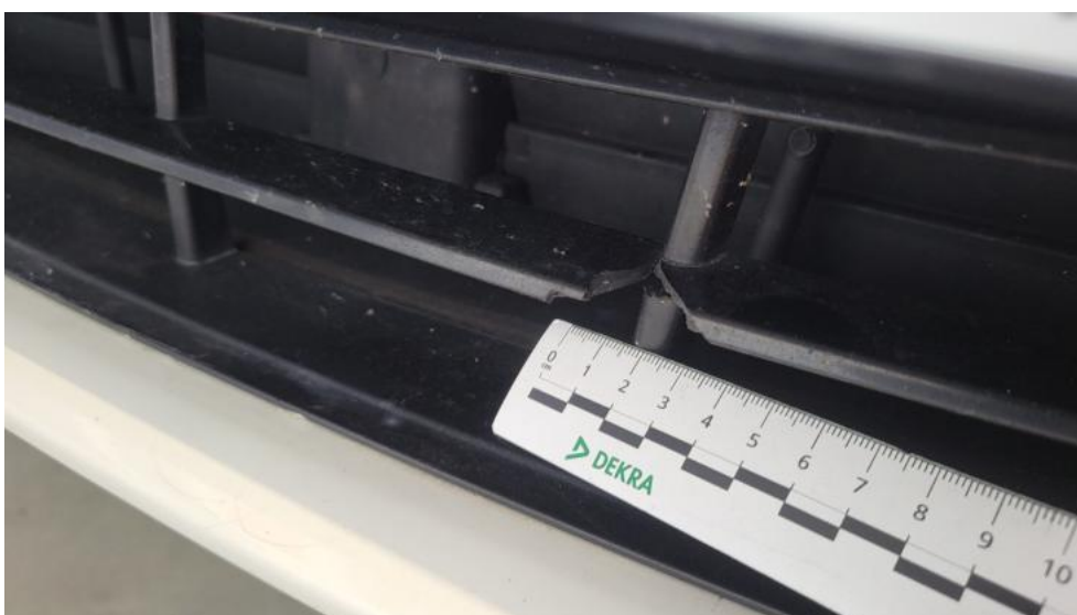
Fot. 42. Krata zderzaka prz. - Pęknięcie/rozerwanie 1
