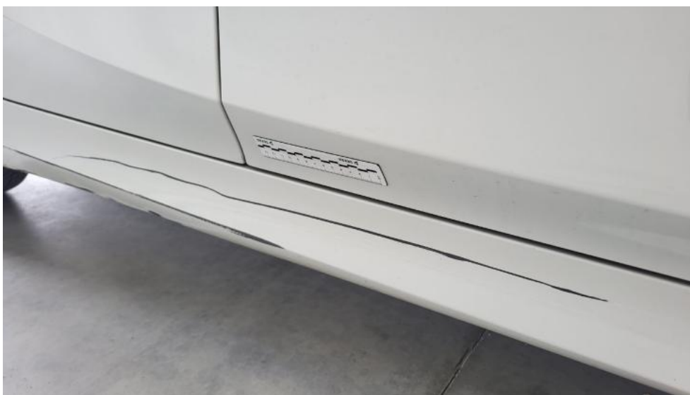
Fot. 45. Próg P - Rysa/odprysk 1
