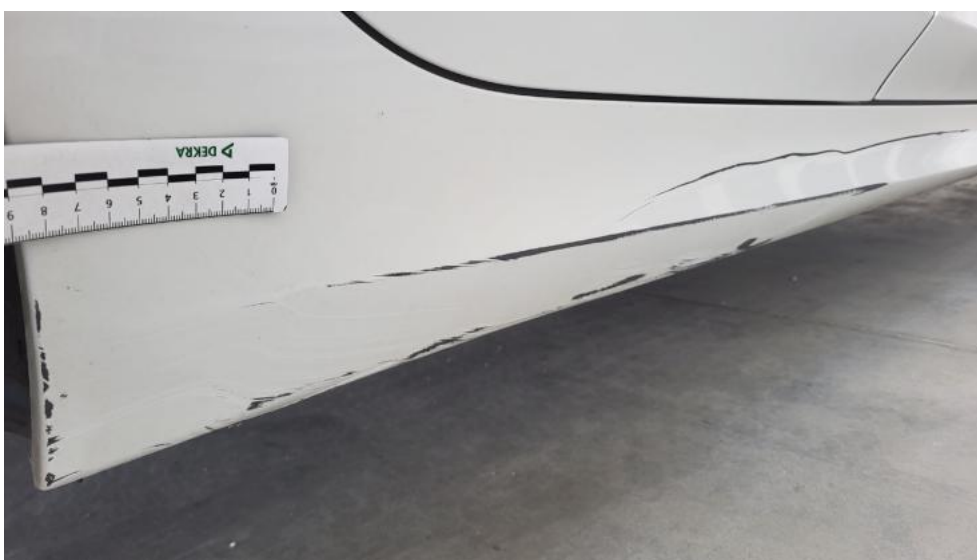
Fot. 46. Próg P - Rysa/odprysk 2
