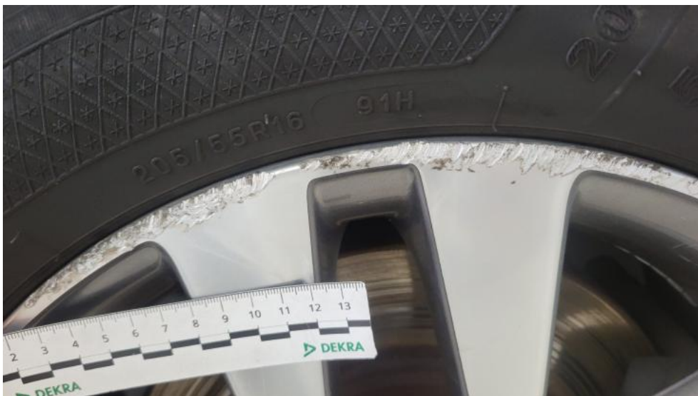
Photo 52. Felga aluminiowa przednia P - Rysa/odprysk 1
