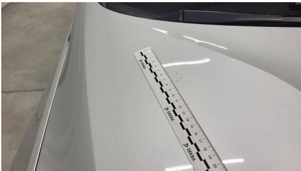
Fot. 38. Pokrywa komory silnika - Rysa/odprysk 1
