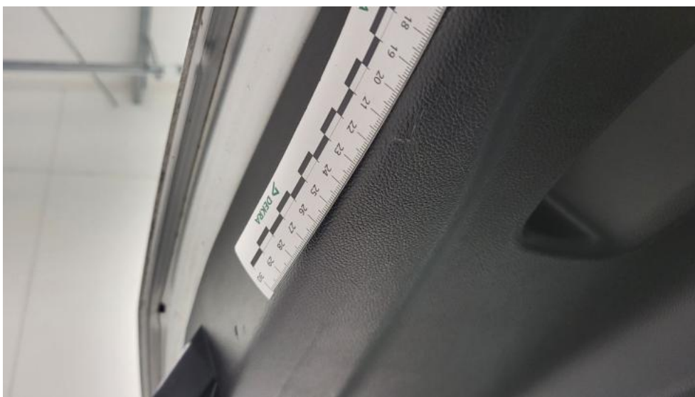
Fot. 82. Wykładzina pokrywy tylnej - Rysa/odprysk 1
