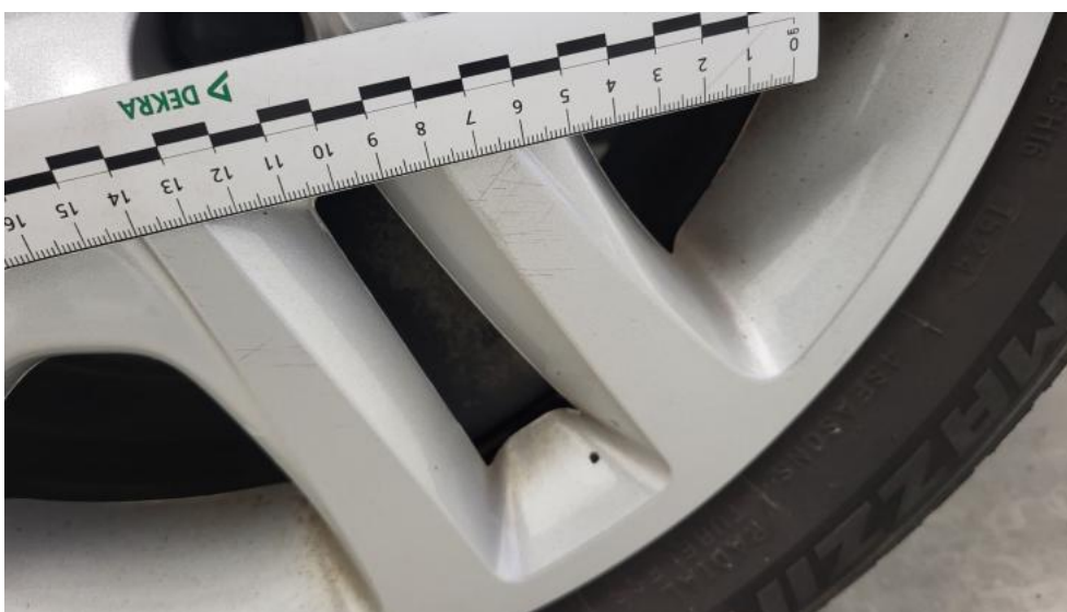
Fot. 44. Kołpak przedni P - Rysa/odprysk 1
