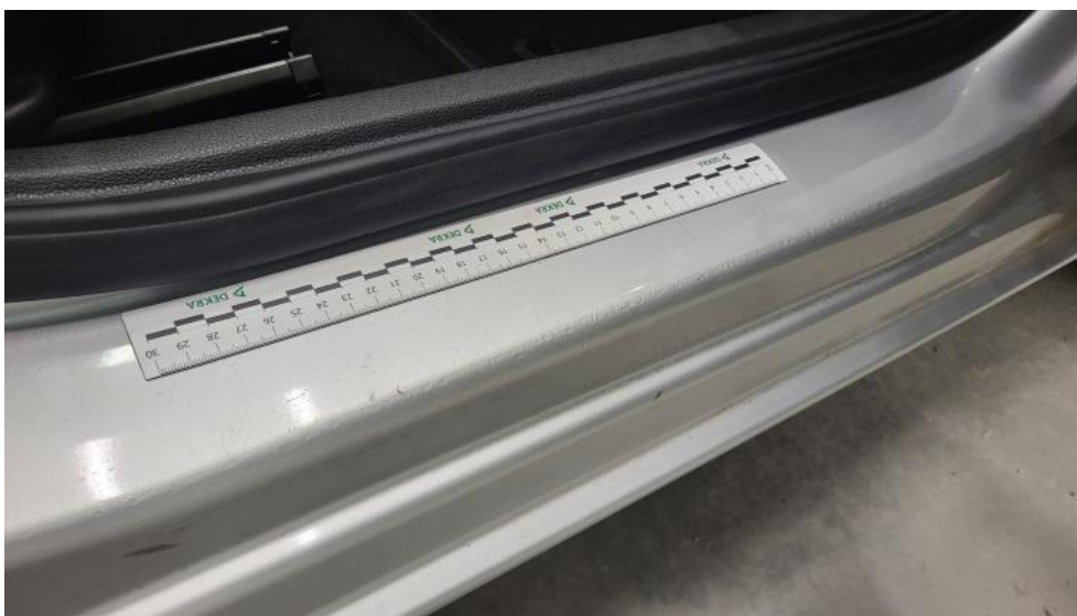
Fot. 49. Próg P - Rysa/odprysk 1
