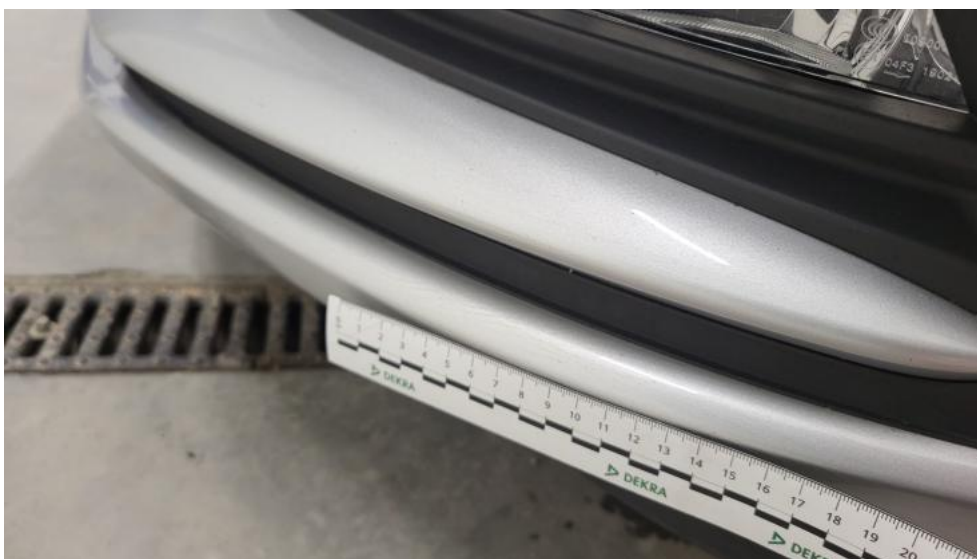
Fot. 43. Zderzak - Pęknięcie/rozerwanie 1
