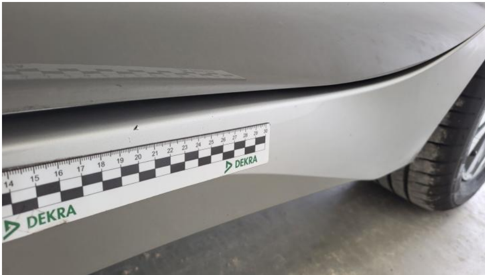
Photo 67. Próg L - Rysa/odprysk 1
