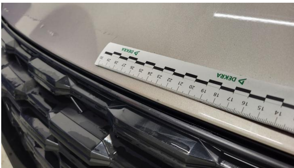
Photo 40. Pokrywa komory silnika - Rysa/odprysk 1
