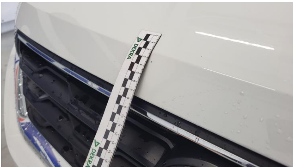
Fot. 40. Pokrywa komory silnika - Rysa/odprysk 1
