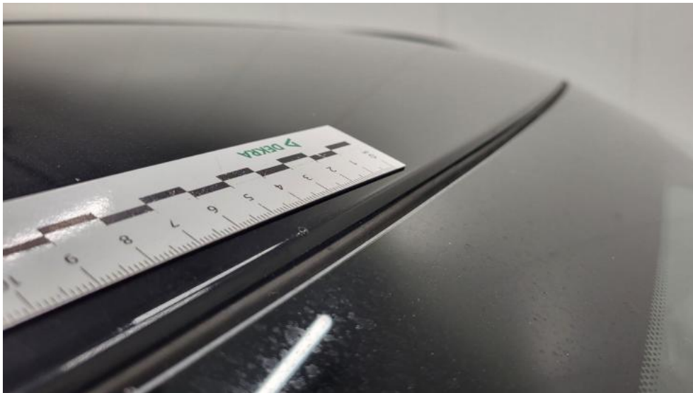
Fot. 57. Dach - Rysa/odprysk 1
