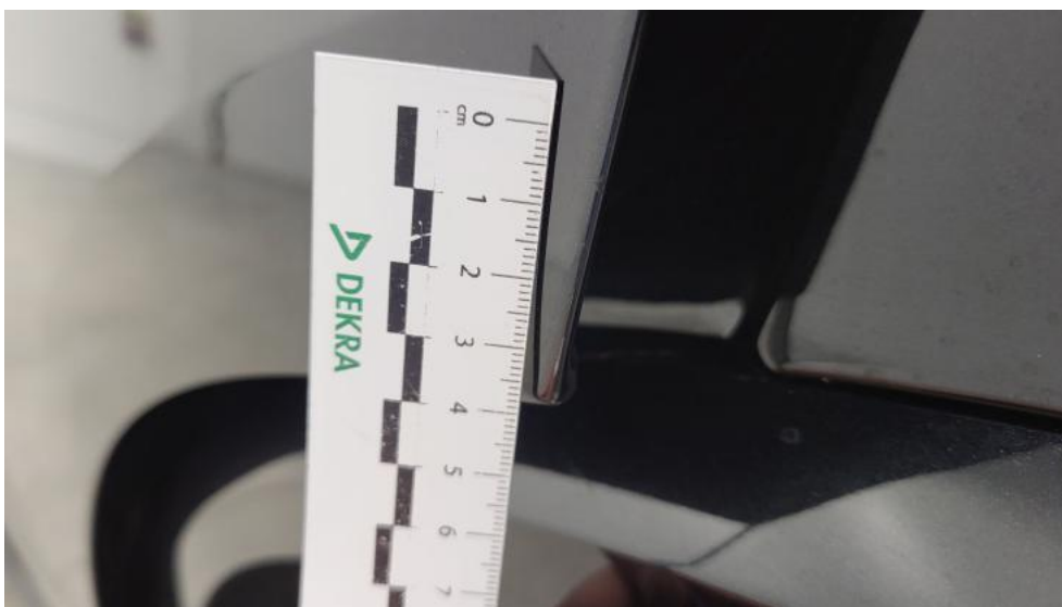
Fot. 61. Drzwi tylne L - Rysa/odprysk 1
