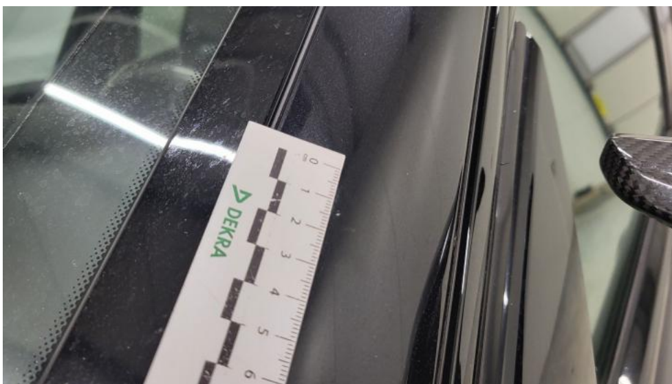
Fot. 66. Słupek przedni L - Rysa/odprysk 1
