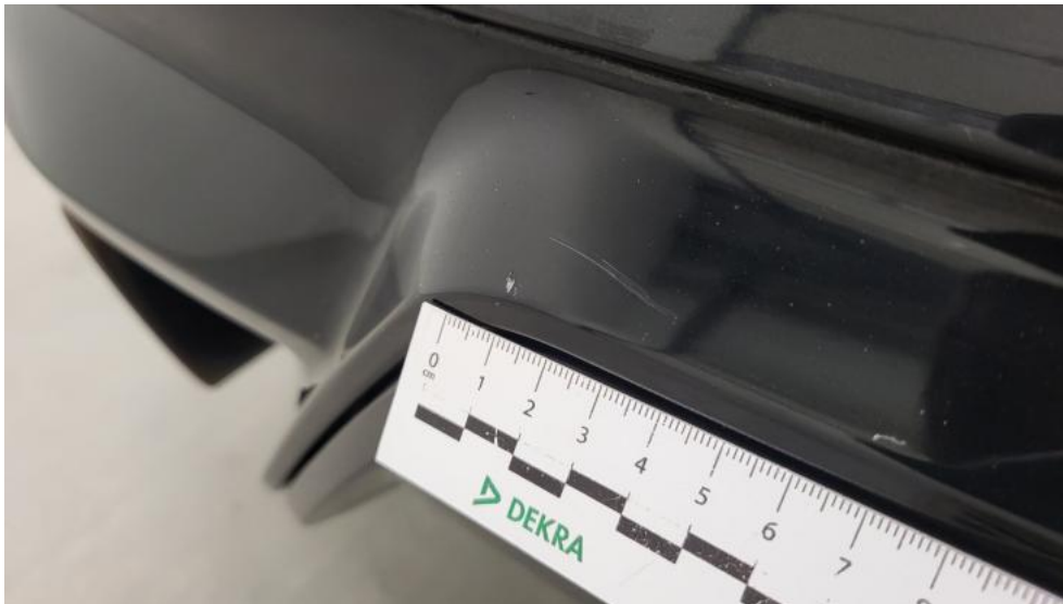
Fot. 55. Zderzak tylny - Rysa/odprysk 1
