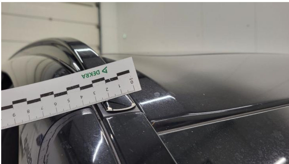
Fot. 58. Reling P - Rysa/odprysk 1
