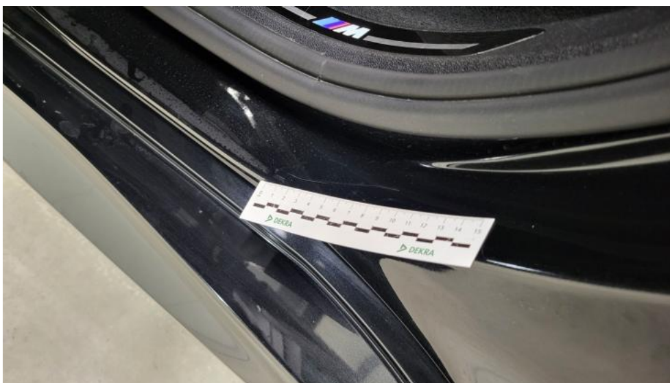
Fot. 65. Próg L - Rysa/odprysk 1
