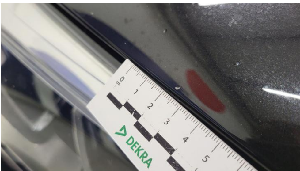
Fot. 46. Pokrywa komory silnika - Rysa/odprysk 1
